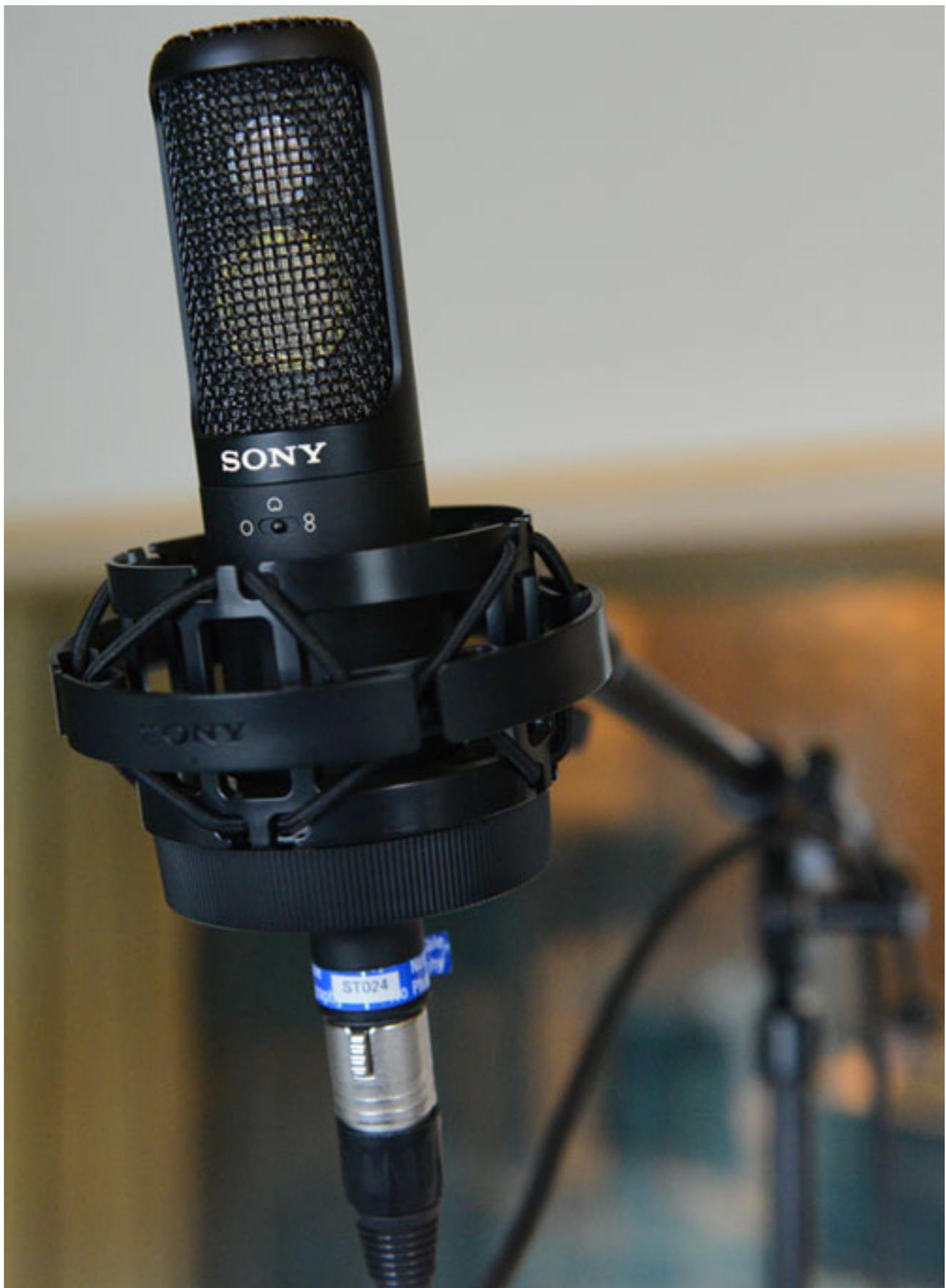
Durch den hohen Übertragungsbereich werden die Transienten wirklich exzellent wiedergegeben. Gegenüber klassischen Kondensatormikrofonen mit auf ca. 20 kHz begrenzten Frequenzgang hört man einen deutlichen Unterschied und im Vergleich hat man manchmal den Eindruck, dass in den Höhen vielleicht zu viel Energie da ist aber nach etwas Eingewöhnungszeit ohne den Vergleich zu anderen klassischen Mikrofonen relativiert sich das sehr schnell.
