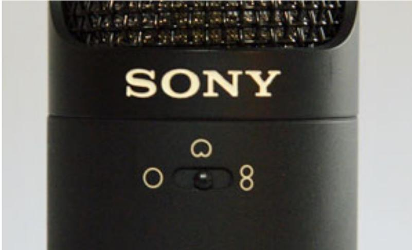
Vorne (s. Abb. oben) bietet das C-100 die Umschaltung zwischen den drei Richtcharakteristiken Kugel, Niere und Acht. Auf der Gegenseite (s. Abb. unten) lässt sich ein 10-dB-Dämpfungsglied sowie ein Hochpassfilter mit einer Grenzfrequenz von 70 Hz zuschalten.
