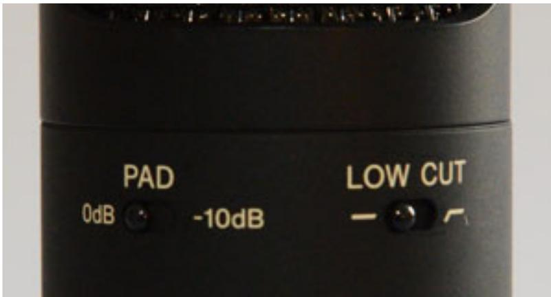
Das Mikrofon wird über 48-Volt-Phantomspannung gespeist (Betriebsstrom <math><4,5\text{ mA}</math>). Am unteren Ende ist eine üblicher XLR-3-M-Buchse verbaut. Die Ausgangsimpedanz beträgt 90 Ohm. Die sonstigen technischen Daten sind abhängig von der gewählten Richtcharakteristik. Der maximale Schalldruck (@ 1 kHz, 1 % THD) beträgt daher 132 dB SPL (Niere) bis 136 dB SPL (Acht) und der Dynamikumfang 113 dB (Niere), bzw. 114 dB (Kugel und Acht).
