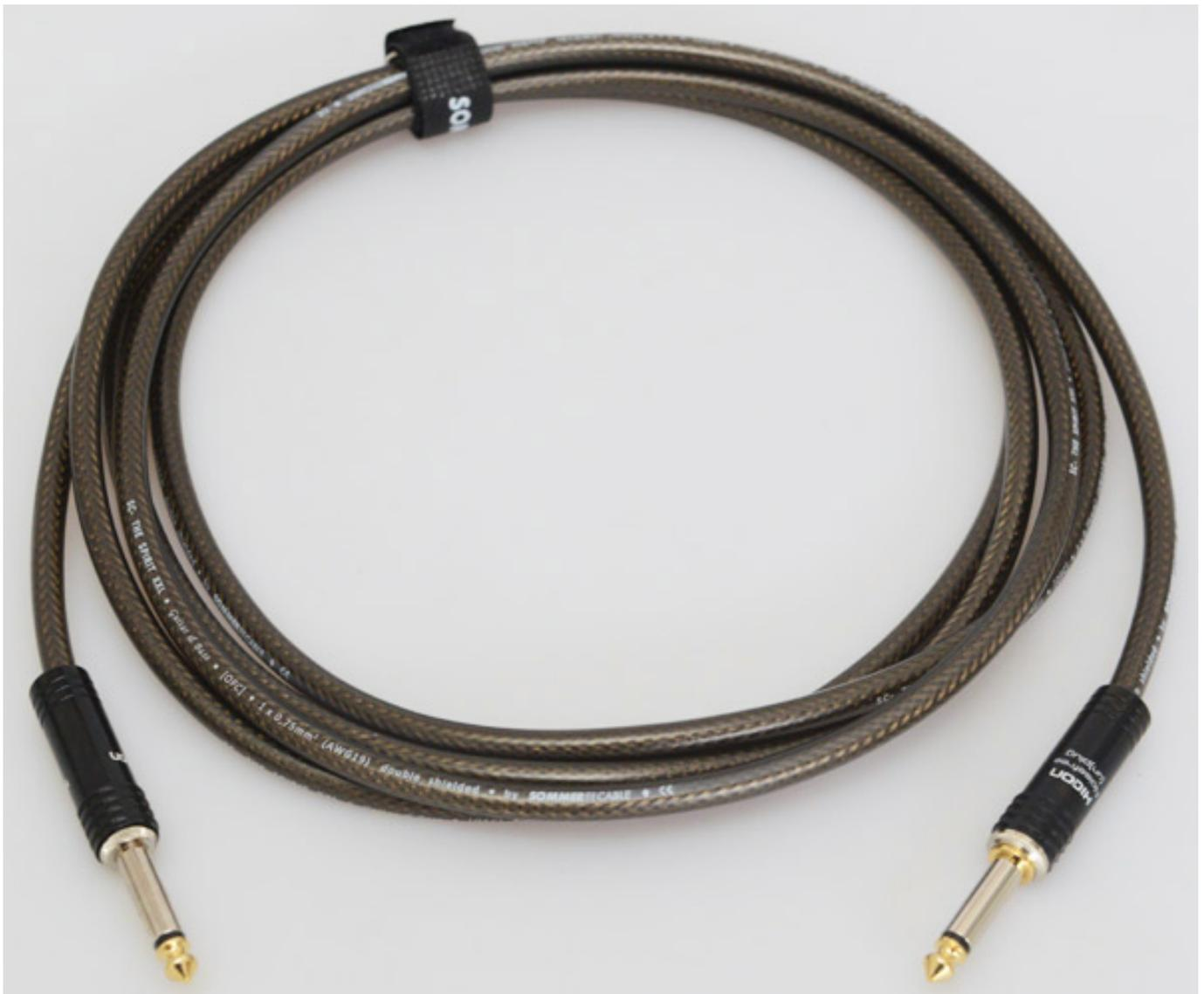
Bestückt sind die Kabel mit einem HICON-Metallgehäuse-Klinkenstecker (6,3 mm) gerade sowie auf der Instrumentenseite mit einem HICON Noisefree-Stecker gerade (s. Abb. oben) oder 90-Grad-gewinkelt (s. Abb. unten). Der Tip-Kontakt vorne ist bei diesen HICON-Steckern vergoldet.
