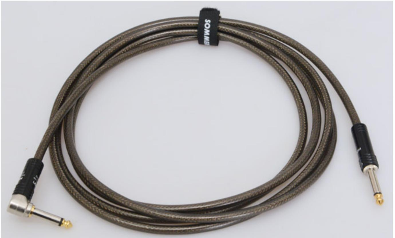
Die Noisefree-Stecker sind intern mit einem Schalter versehen, der beim Einstecken in die Klinkenbuchse mechanisch ausgelöst wird und so dafür sorgt, dass es keine Einsteckgeräusche gibt.
