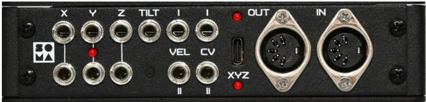
Die Verbindung zwischen Flux und der Breakout Box erfolgt über ein USB-A/USB-C-Kabel. Die LED zwischen den XYZ-Buchsen zeigt die Spannungsversorgung an und die erfolgreiche USB-Verbindung wird über eine Status-LED über der USB-Buchse angezeigt. Es gibt neben der USB-Buchse jeweils eine fünfpolige MIDI-In- und eine MIDI-Out-Buchse.
