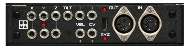
Die Verbindung zwischen Flux und der Breakout Box erfolgt über ein USB-A/USB-C-Kabel. Die LED zwischen den XYZ-Buchsen zeigt die Spannungsversorgung an und die erfolgreiche USB-Verbindung wird über eine Status-LED über der USB-Buchse angezeigt. Es gibt neben der USB-Buchse jeweils eine fünfpolige MIDI-In- und eine MIDI-Out-Buchse.
