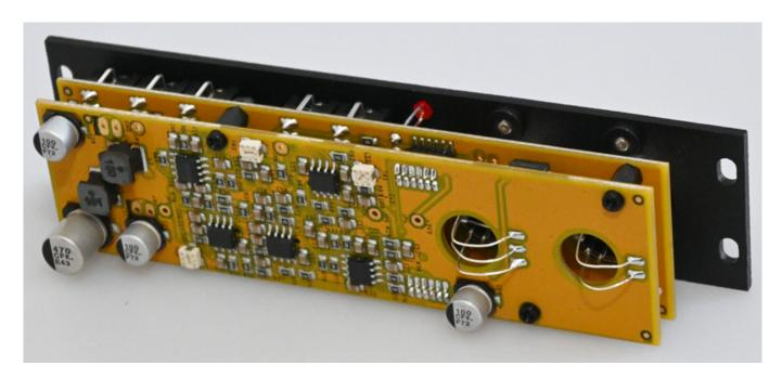
Die Flux Breakout Box ist eigentlich ein Eurorack-Modul mit einer Breite von 6 HE, welches montiert in einem Mini-Metall-Case geliefert wird. Es wird direkt über ein USB-Kabel an das Flux angeschlossen und auch von dort mit Betriebsspannung versorgt. Beim Einbau in ein Eurorack bedarf es daher keinen Anschluss an die dortige Stromversorgung. Erforderlich für den Betrieb ist mindestens die Flux-Firmware-Version 1.6.
