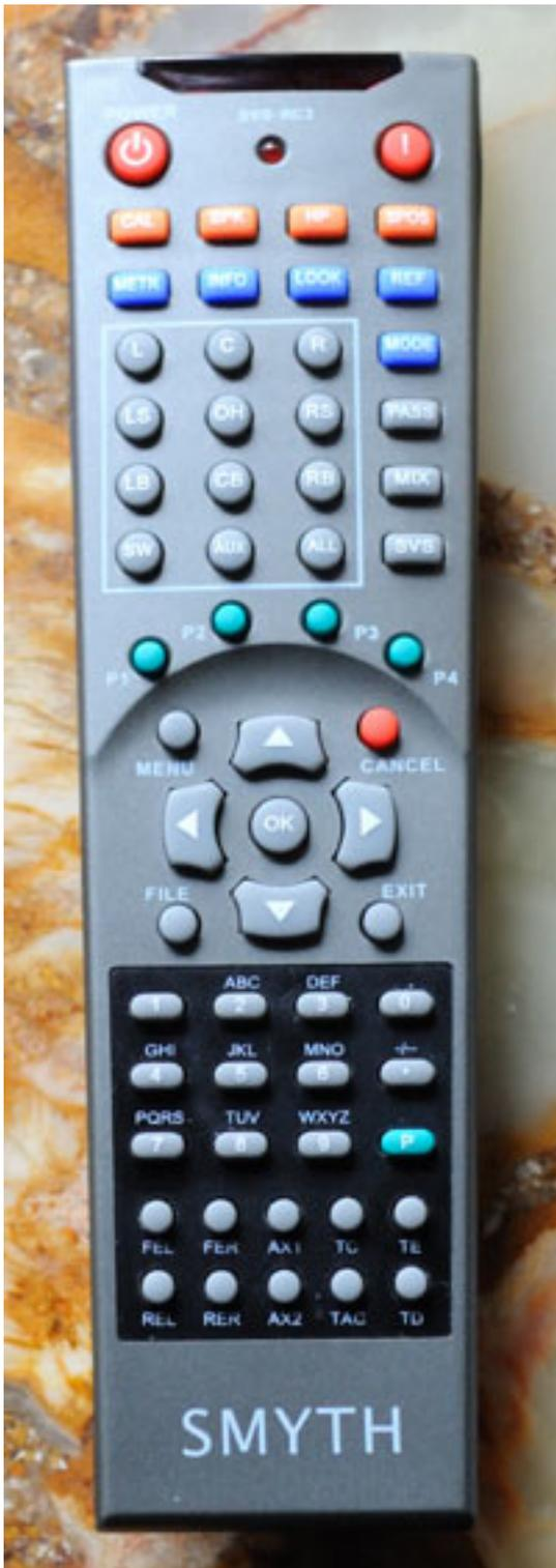
Neben der Eingabe von Texten über die alphanumerischen-Tasten, Auswahl von Menüpunkten mittels Cursor-Tasten und Veränderung von Parameters, gibt es im unteren Bereich auch zwei Reihen von Funktionstasten, mit denen sich z. B. das Headtracking Ein- und Ausschalten lässt etc.
