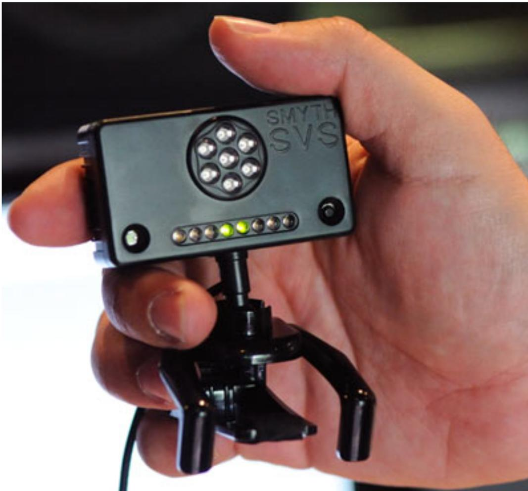
Die gemessene Kopfstellung zur Mittenposition wird übrigens durch ein LED-Bargrafanzeige im Empfängerteil ausgegeben. Der Empfänger ist mit einer Halterung versehen, um ihn problemlos an einem Bildschirm zu befestigen.
