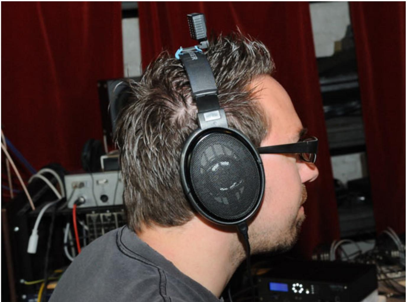
Das Headtracking wird einmal durch einen Sender am Kopfhörer und einem Empfänger (s. unten), der z. B. an einem Bildschirm befestigt wird, realisiert. Die Messung erfolgt über Infrarot. Durch die sehr hohe Wellenlänge gegenüber z. B. Ultraschall sind die Messungen sehr präzise. Dazu später mehr.
