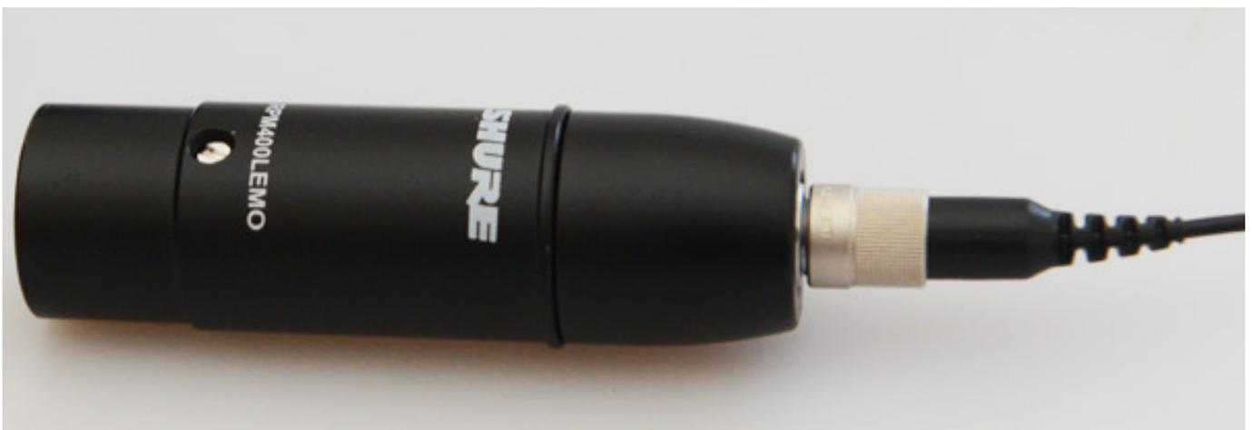
Im Zubehörangebot befinden sich weiter noch diverse Adapter, um zum Beispiel ein Mikrofon, was für den Drahtlosbetrieb vorgesehen ist auch an einem XLR-Eingang adaptieren zu können (s. Abb. oben).
