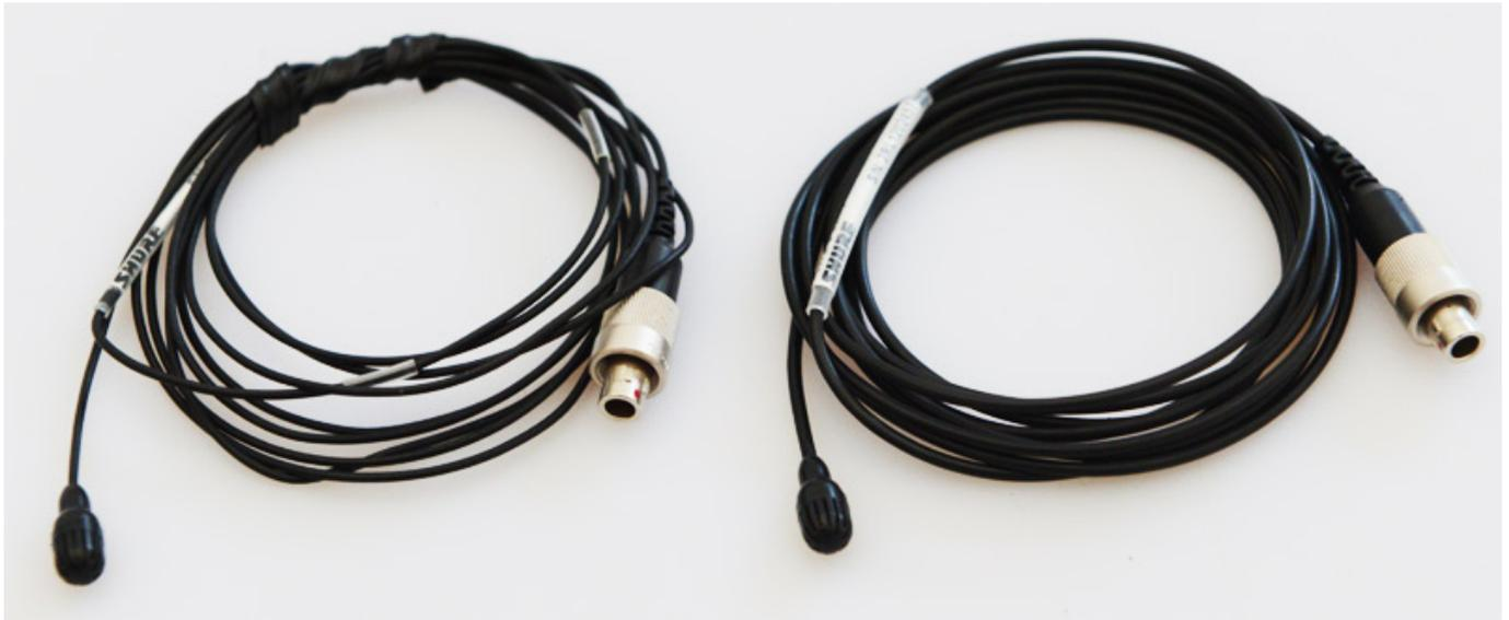
Das TL45 wird ausschließlich mit LEMO-Steckverbindung angeboten. Die Kapsel hat einen Durchmesser von 5,6 mm und weist eine Länge von 13,5 mm auf. Die geringe Empfindlichkeit des Mikrofons von -45,0 dBV (@ 1 kHz) erlaubt auch den Betrieb mit hohen Schalldrücken von bis zu 142 dB SPL (@ 1 kHz, 1 % THD). Das Eigenrauschen beträgt 24,5 dB SPL (A-gewichtet) und der Signal/Störabstand 69,5 dB. Der Hersteller gibt einen Dynamikbereich von 117,5 dB an.
