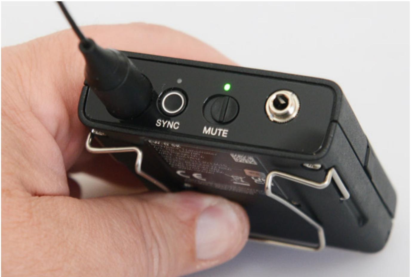
Auf der Oberseite lässt sich mit der SYNC-Taster der Geräte-Bindungsprozesses auf der Senderseite auslösen. Weiter gibt es ein Mute-Schieberegler zum Stummschalten. Daneben befindet sich die 3,5-mm-Klinken-Mikrofoneingangsbuchse.
