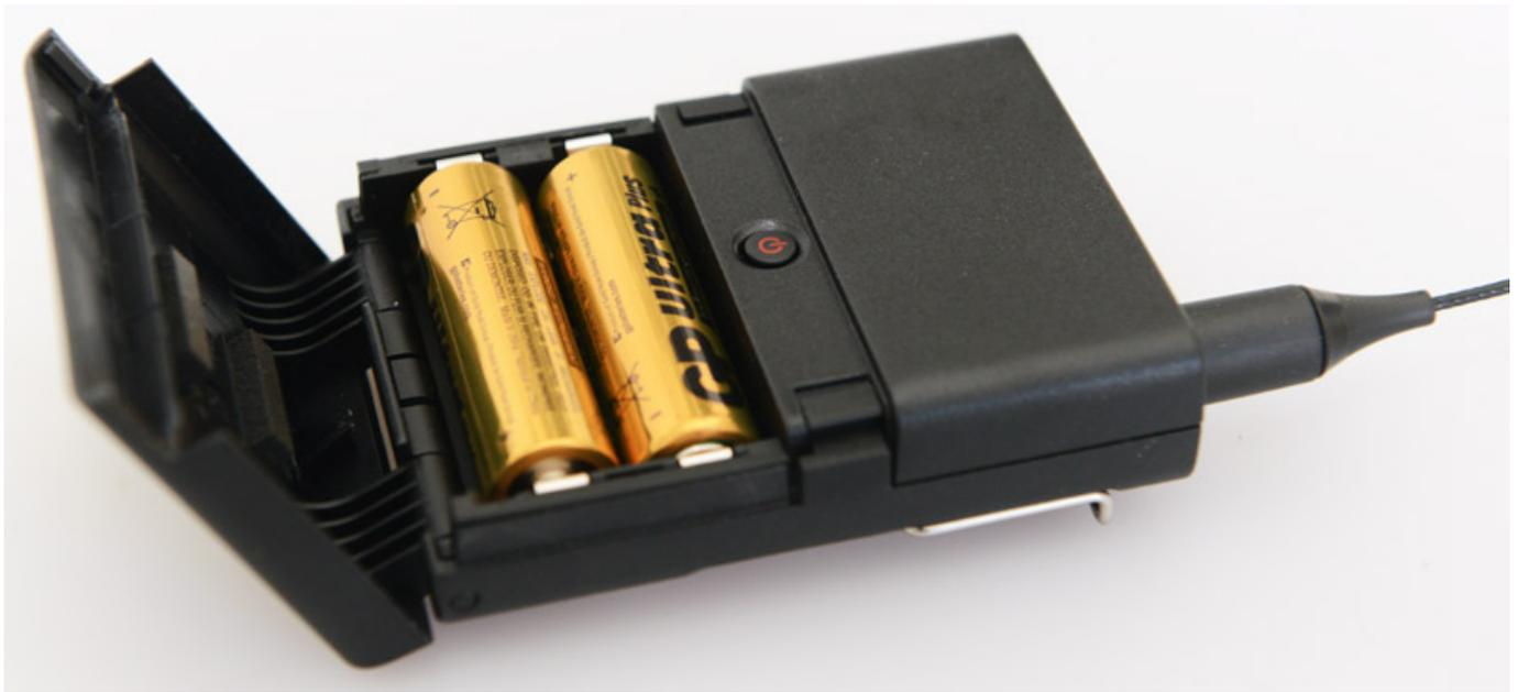
Der Ein/Ausschalter befindet sich ja klassischerweise bei Sennheiser-Taschensendern vor versehentlicher Auslösung geschützt im Batteriefach (s. Abb. oben). Mit dem BA70-AKku lässt sich der Taschensender bis zu 12 Stunden betreiben.
