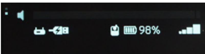
Das gut ablesbare OLED-Display bietet auf der Basisseite eine Übersicht über Empfangsfeldstärke, Akkustatus von Sender und Empfänger sowie Empfänger-Ladestatus. Oben im Display wird in einem Bargraf der Audiopegel angezeigt.
