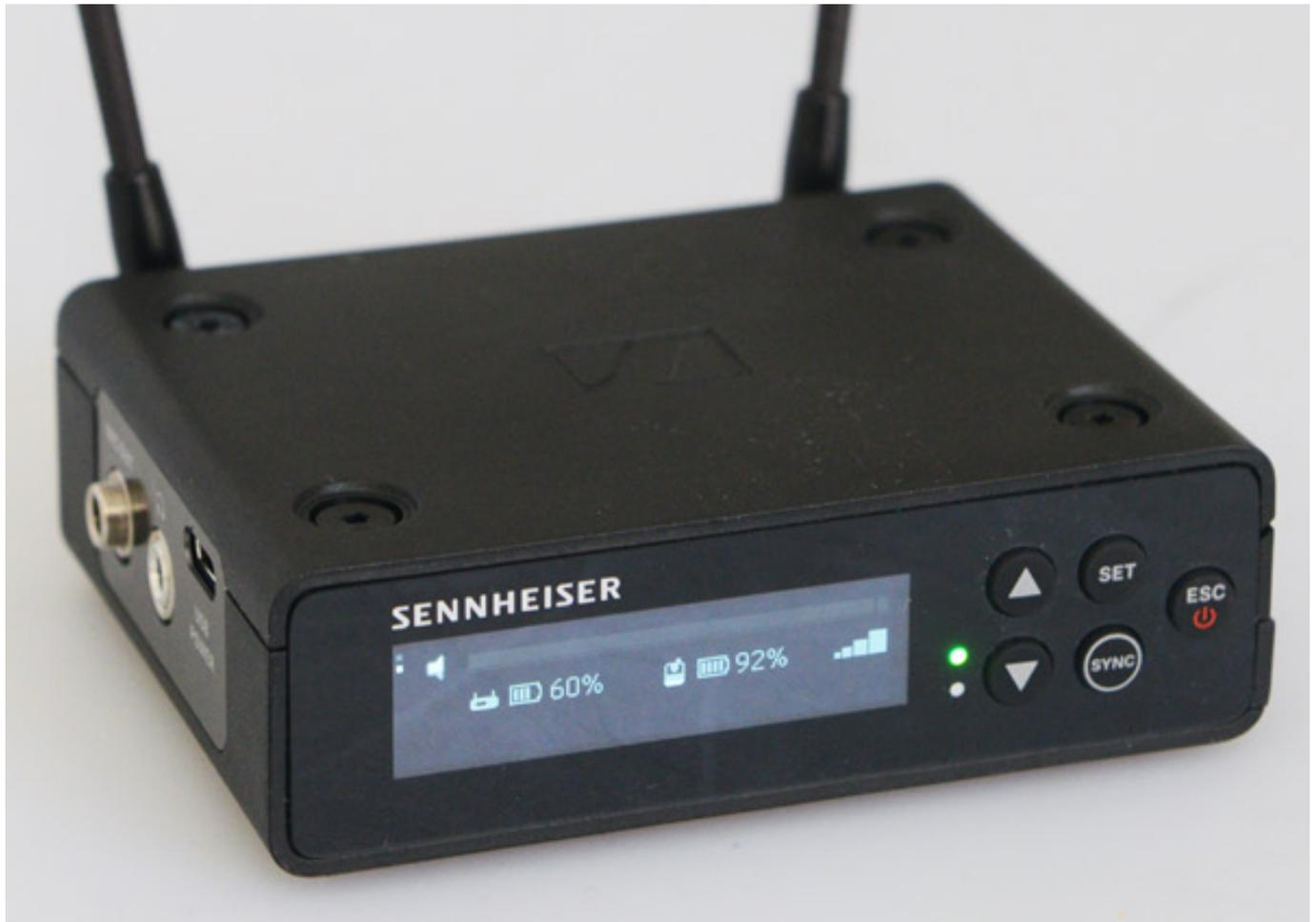
Nun zur interessantesten Komponente des EW-DP Systems, nämlich dem portablen Empfänger (86 x 67 x 28 mm, ca. 140 g) der sich auf verschiedenen Arten an der Kamera befestigen lässt. Er verfügt oben und unten über Magnete und lässt sich so auch gestapelt betreiben.
