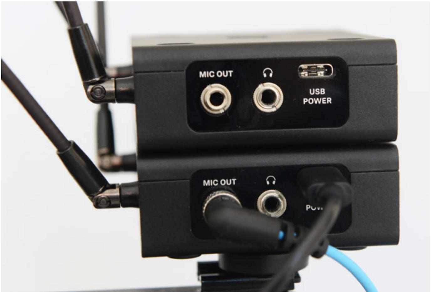
Auf der Seite befinden sich Audioausgang (3,5 mm Klinke) sowie ein Kopfhörerausgang (max. 50 mW @ 16 Ohm) für das Monitoring (s. Abb. oben). Über ein USB-C-Stecker lässt sich der Empfänger auch mit Betriebsspannung versorgen und der interne Akku kann hierüber auch geladen werden. Der Empfänger kann mit dem BA70 Akku bis zu sieben Stunden betrieben werden.
