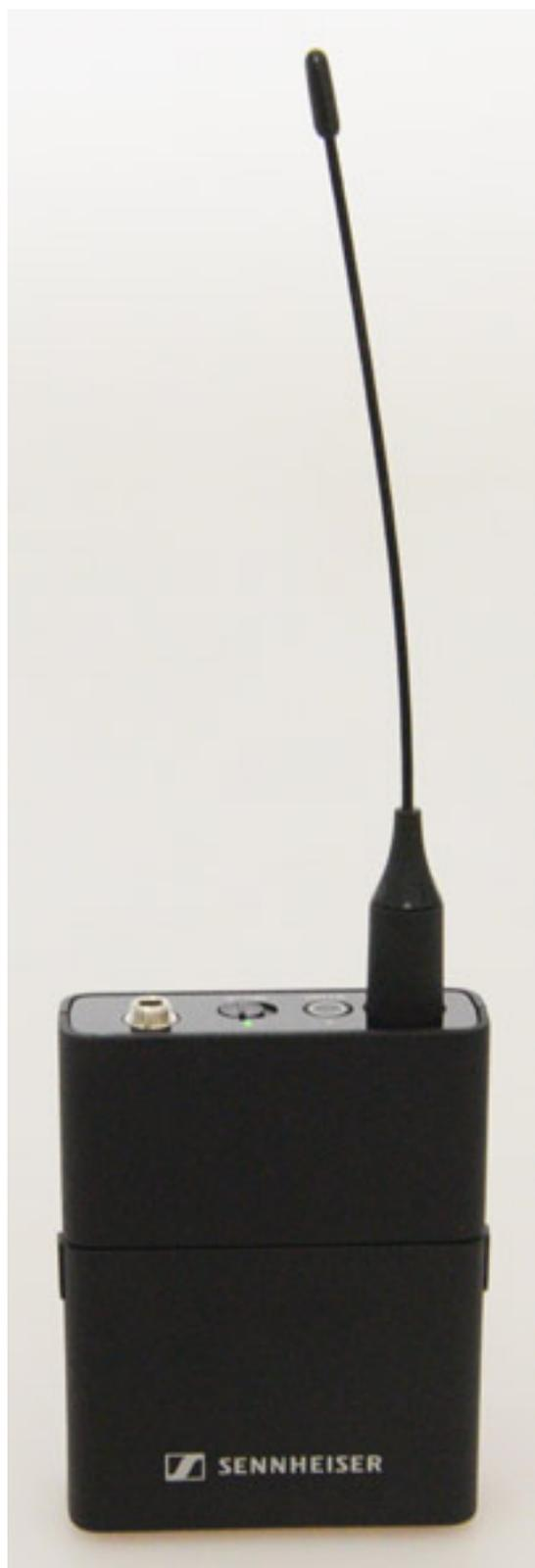
Der Taschensender EW-D SK (s. Abb. oben) hat eine sehr ähnliche Größe wie die ew G4 Serie Taschensender. Er ist mit 63 x 80 x 20 mm ohne Antenne von der Bauform her etwas eckiger. Was komplett fehlt ist ein Display. Der Ein/Ausschalter sitzt im Batteriefach unter der Batterieabdeckung (s. Abb. unten). Hier lassen sich zwei AA-
