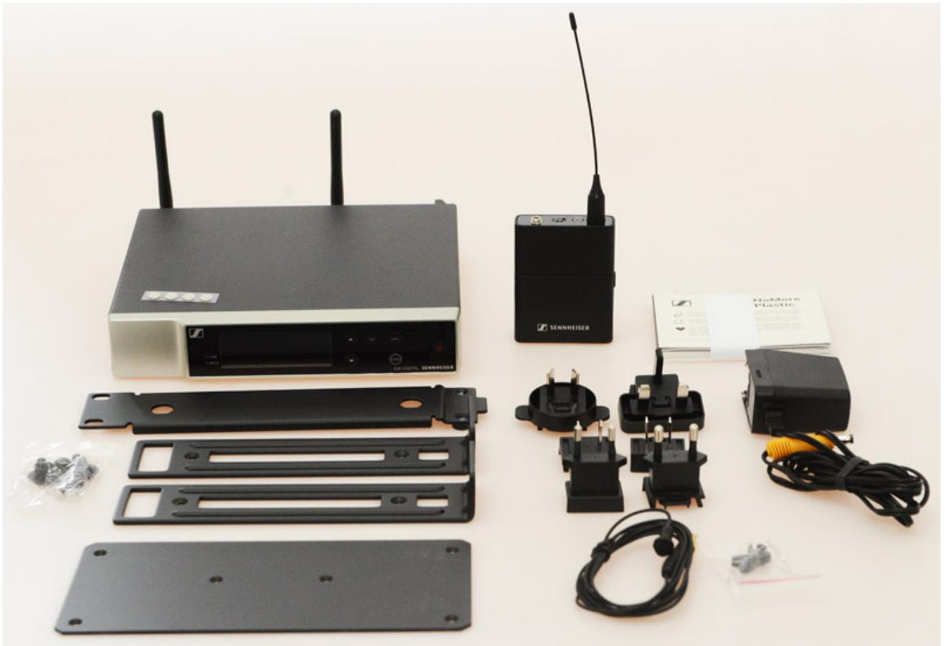
Hier einmal der Lieferumfang des EW-D ME2 Set, als mit stationärem Empfänger, Taschensender und Lavalier ME 2 Mikrofon. Im Lieferumfang befinden sich zwei abwickelbare Dipolantennen mit BNC-Stecker. Das Netzteil wird mit Adapter für den weltweiten Einsatz geliefert. Weiter gibt es vier selbstklebende Gummifüße, falls man den Empfänger als Tischempfänger aufstellen möchte, sowie ein Set für die Rack-Montage eines oder zwei 1/2 19"-Empfänger. Als Anleitung liegt eine Kurzanleitung bei.
