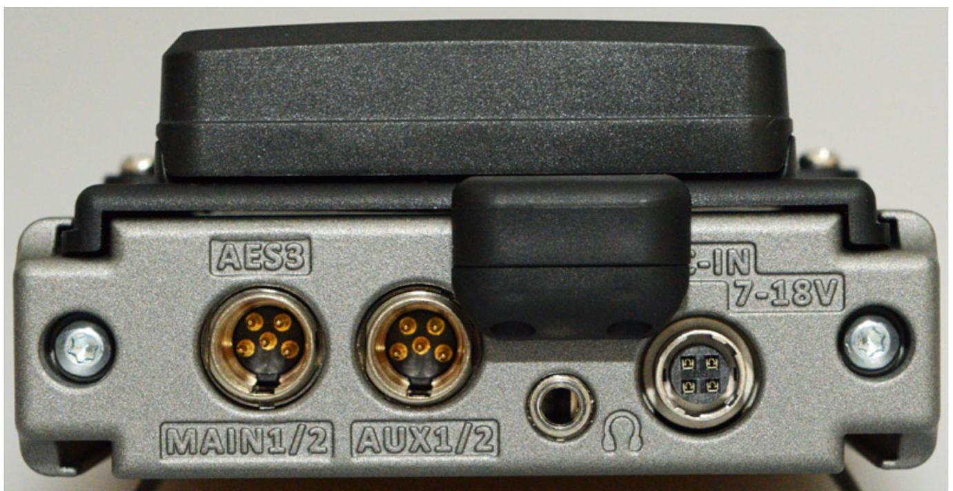
Unten am Backpanel-Adapter befinden sich mehrere Anschlüsse (s. Abb. oben). Der Empfänger lässt sich über Buchse mit einer externen Gleichspannungsquelle speisen. Es ist also nicht nur Akkubetrieb möglich. Weiter verfügt der Backpanel-
