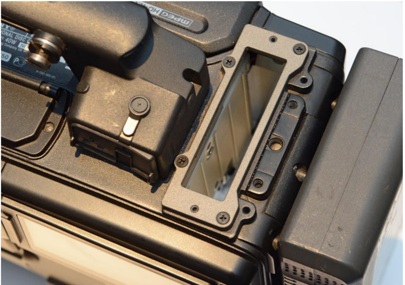
Der Abschlussrahmen wird auf den Kamera-Slot aufgelegt und mit vier Schrauben befestigt (s. Abb. oben). Danach muss man nur noch den vorbereiteten EK 6042 in den Slot einführen und mit den zwei Schrauben am Empfänger fixieren (s. Abb. unten). Das IR-Fenster, ein USB-Anschluss (seitlich mit Gummiabdeckung) sowie der Audio-Aux-Ausgang (5 pol. Mini-XLR oben mit Abdeckung) stehen auch im eingebauten Zustand zur Verfügung.
