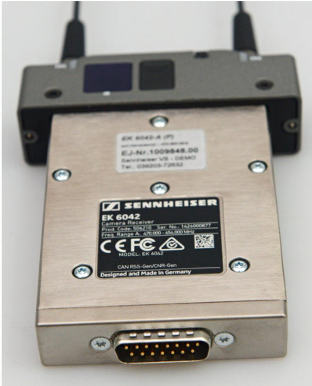
Der gewünschte Adapter wird aufgeschoben und an der Seite mit zwei Schrauben fixiert (im Bild oben nicht sichtbar).
