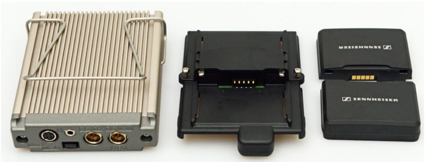
Der Empfänger wird hierzu in den Backpanel-Adapter eingeschoben und festgeschraubt. Dann wird der Batterieadapter aufgesteckt und festgeschraubt und die beiden Batterien aufgeschoben (s. Abb. unten).
