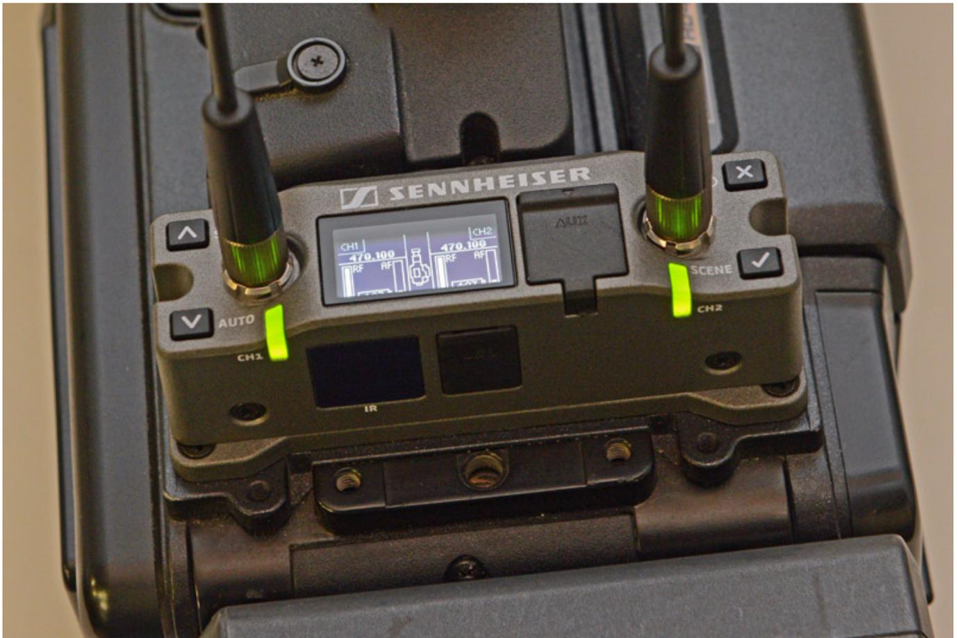
Die Bedienung erfolgt über vier Tasten, die oben an den Ecken des Empfängers angeordnet sind. Diese Tasten haben die Funktion Selektion (Up/Down), Beenden (Escape) und Bestätigung (kurzes Drücken) sowie die Doppel/Funktionsbelegung SYNC, AUTO, AUS, SCENE (Taste gedrückt halten).
