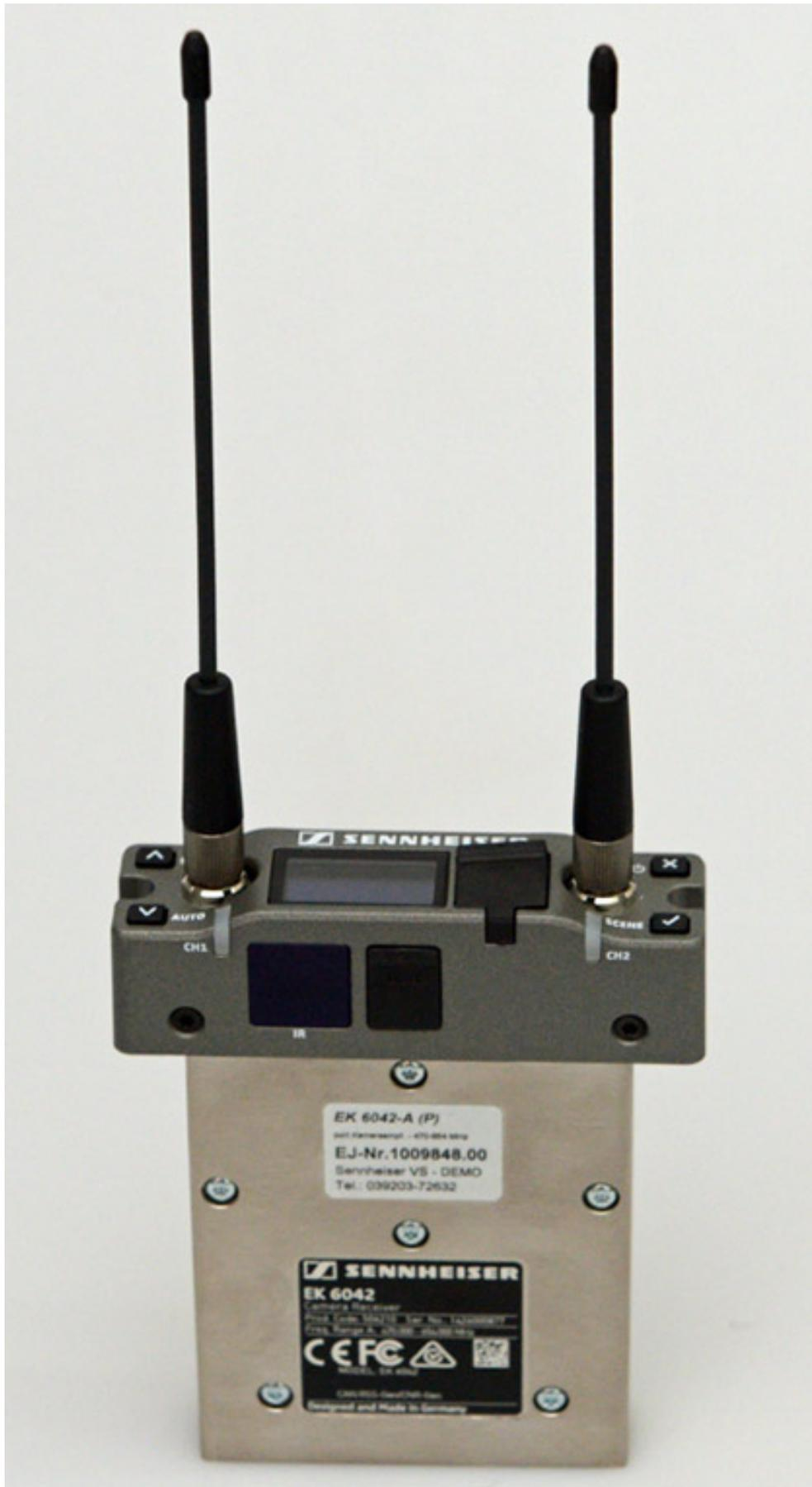
Der Empfänger ist als Einschubempfänger (s. Abb. oben) konzipiert und er lässt sich für verschiedene Anwendungen entsprechend mit Optionen umrüsten. Er wiegt 340 Gramm und misst ohne Antenne 107 x 90 x 26 mm. Der Empfangsbereich umfasst 470 MHz bis 654 MHz - also 184-MHz-Schaltbandbreite. Der EK 6042 ist ein Empfänger mit True-Diversity-Funktion. Die beiden Antennenbuchsen sind als SMA-Buchsen ausgeführt.
