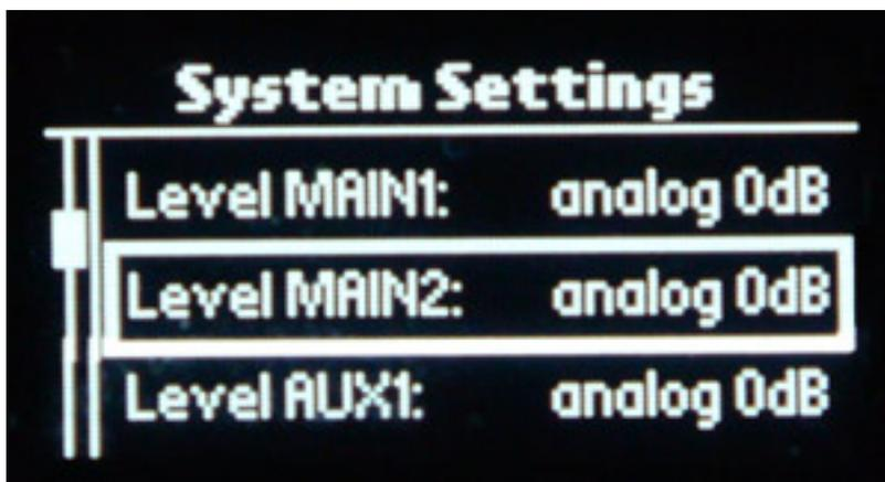
Der analoge Pegel lässt individuell für jeden Ausgang im Bereich von -22 dBu bis +8 dBu einstellen. Die getätigten Einstellungen lassen sich als sogenannte Szenen (Scene) abspeichern. Bis zu zehn solcher Szenen sind speicher- und wieder
