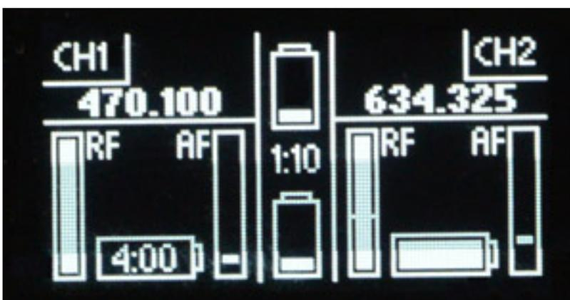
Im Standard-Display (s. Abb. oben) werden auf einen Blick die wichtigsten Statusinformationen beider Kanäle vermittelt und zwar Frequenzen und Empfangsfeldstärken der beiden Kanäle sowie Audiopegel mit Peak-Hold-Anzeige sowie Ladezustand der Batterien des Empfängers und der Sender. Es stehen noch zwei weitere Anzeige-Displays zur Verfügung, die jeweils die Statusdaten eines der
