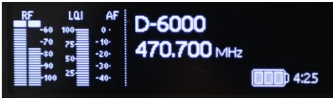
In dem Haupt-Display (s. Abb. oben) wird über drei Bargrafen die Empfangsfeldstärke, eine Qualitätsbewertung (Link Quality Indicator) und der NF-Pegel sowie bei Empfang der Batteriestatus des Senders ausgegeben. Daneben wird noch Kanalname und Frequenz angezeigt. Durch Drehen des Drehgebers werden weitere Informationen aufgerufen, wie z. B. die Einstellungen des Senders. Durch Drücken auf den Drehgeber gelangt man in das Menü.
