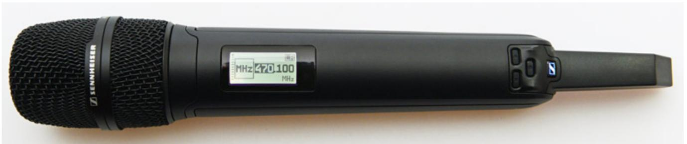
Eingeschaltet wird der Sender über einen Drucktaster mit LED-Indikator. Über drei Tasten lassen sich Menüs aufrufen, anwählen und die Parameter verändern, wie Frequenz, Testton, Anzeigewert im Hauptdisplay (Frequenz, Name, Preset), Tiefpassfilter (60, 80, 100, 120 Hz), Verstärkung (0 ... 60 dB), Mikrofonname und Eingabesperre (Lock). Wie schon zuvor beschrieben lässt sich der Sender auch über die Sync-Funktion vom Sender aus programmieren.
