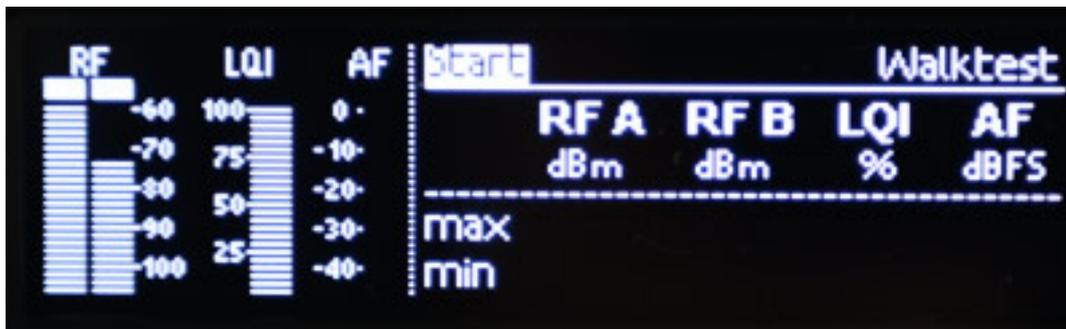
Wenn man nun die Funktion durch Tastendruck auf den Drehgeber startet, dann läuft der Walk-Test bis man ihn wieder mit dem Druck/Drehgeber stoppt.
