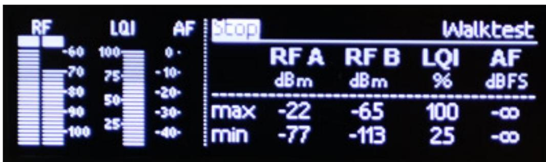
Angezeigt werden hier (s. Abb. oben) Minimal und Maximalwerte der Feldstärke der beiden Empfangswege, des Qualitätsparameters sowie der Audiopegel in dBFS.
