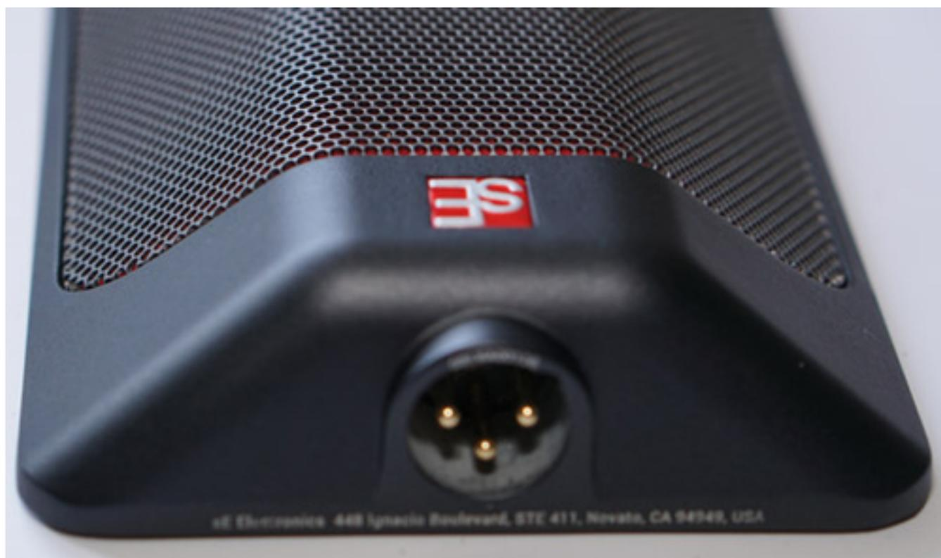
Das Einsprechgitter auf der Oberseite ist aus gelochtem Stahlblech und macht ebenfalls einen stabilen Eindruck. Um das Eindringen von Staub zu unterbinden ist das Lochgitter mit einem roten Fleece hinterlegt.
