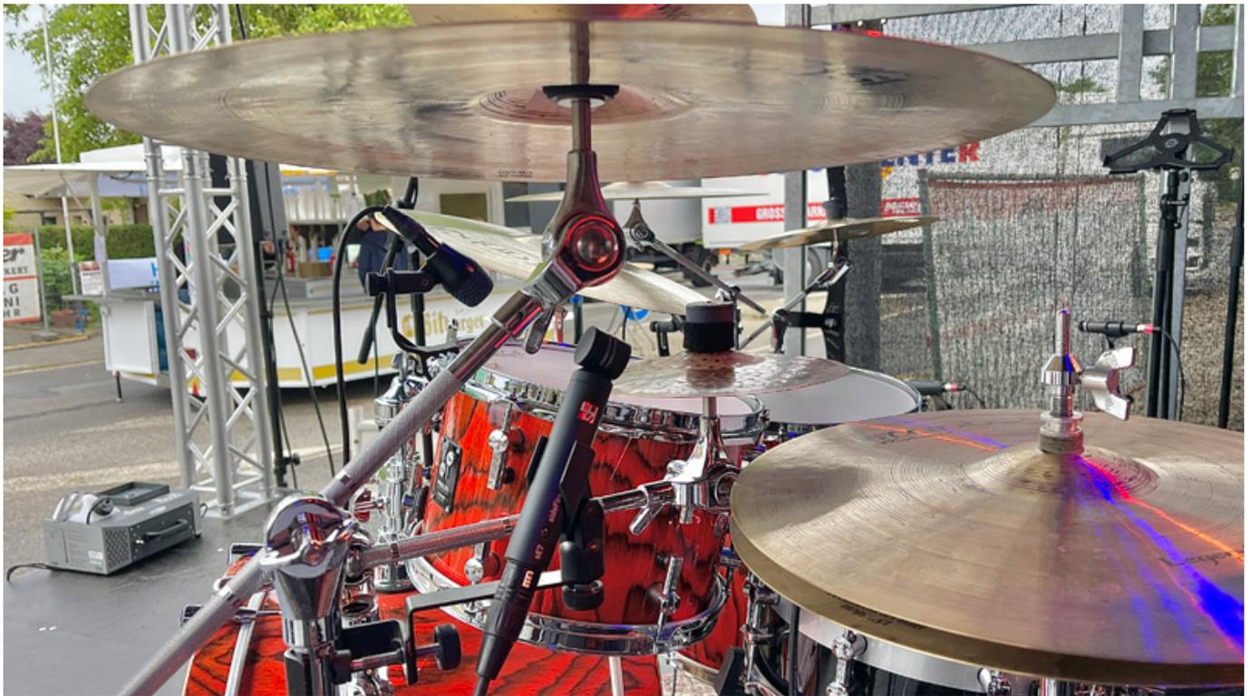
Die sE7 sideFire Variante bietet am Drumset ebenfalls in interessante Optionen. Durch die seitliche Kapselanordnung lassen sich die Mikrofone auch in beengten Verhältnissen optimal positionieren. Beim Mix eines Support Acts auf einer lokalen Bühne ermöglichte die ungewöhnliche Kapselausrichtung interessante Positionierungsmöglichkeiten.
