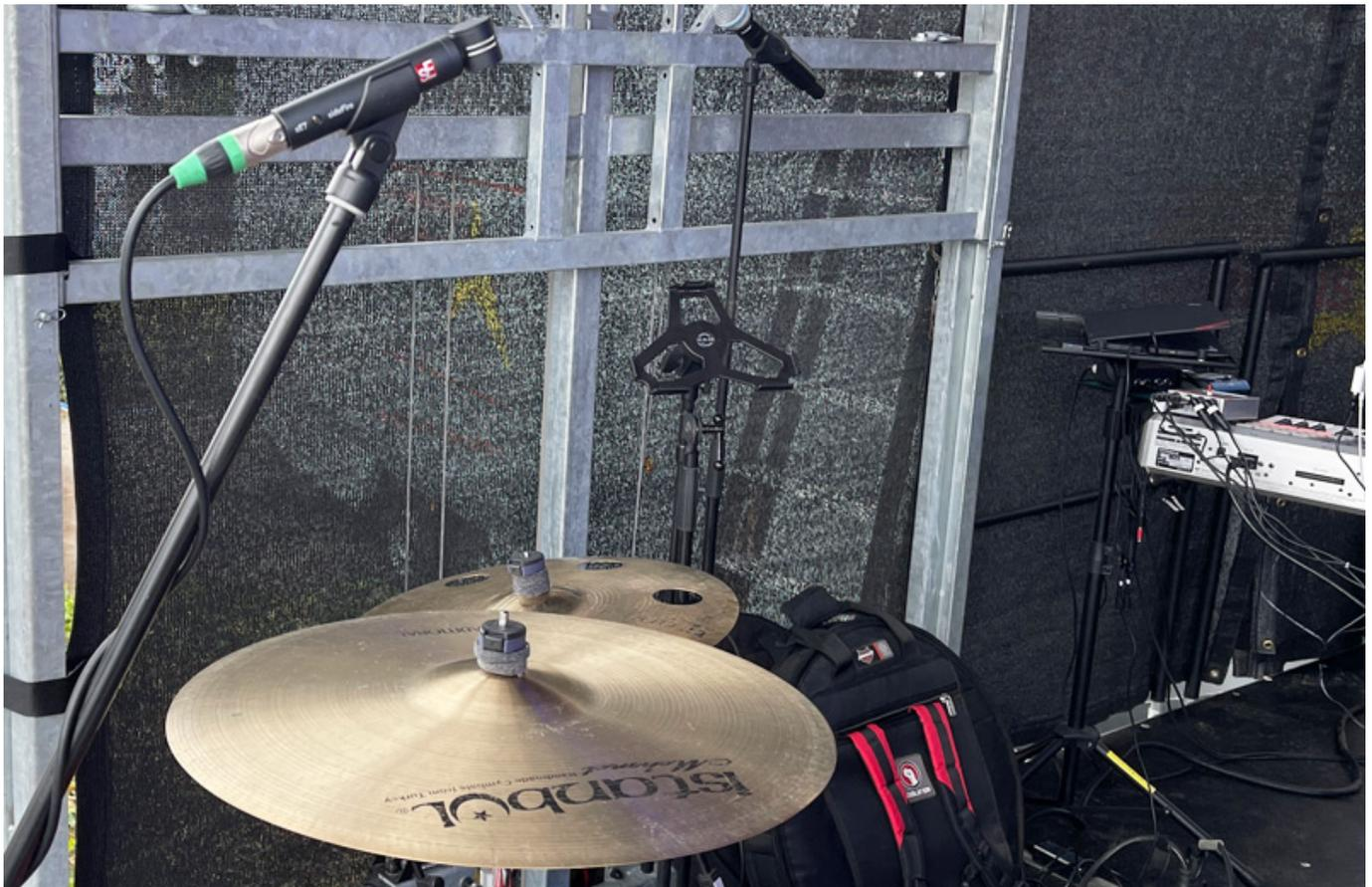
Die Neutraleinstellung lieferte bereits sehr gute Ergebnisse mit ausgewogener Abbildung. Die schnelle Transienten-Response erfasst Attack-Phasen der Becken präzise. Als Mischpult kam ein Behringer WING Compact zum Einsatz. Den verbauten PAD-Schalter habe ich für diesen Einsatz nicht benötigt. Dieser wird vermutlich nur bei einer nahen Mikrofonierung von sehr lauten Schallquellen (z.B. Rock-Snare) notwendig.
