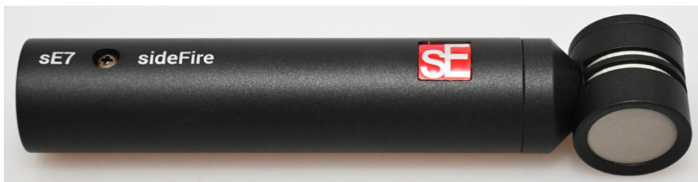
Die seitliche Kapselanordnung des sideFire (s. Abb. oben) nutzt dieselbe Back-Elektret-Kondensator-Kapsel wie das Standard-Modell, jedoch um 90 Grad gedreht. Die Richtcharakteristik bleibt eine Niere, aber durch die seitliche Einsprechrichtung eröffnen sich völlig neue Positionierungsmöglichkeiten.
