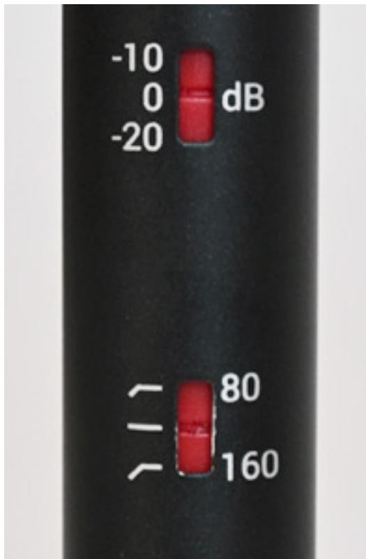
Über zwei verdeckte Schalter lässt sich eine Vordämpfung von 10 oder 20 dB zuschalten sowie ein Hochpassfilter mit einer Grenzfrequenz von 80 oder 160 Hz. Diese Sektion wurde ebenfalls vom sE8 übernommen.
