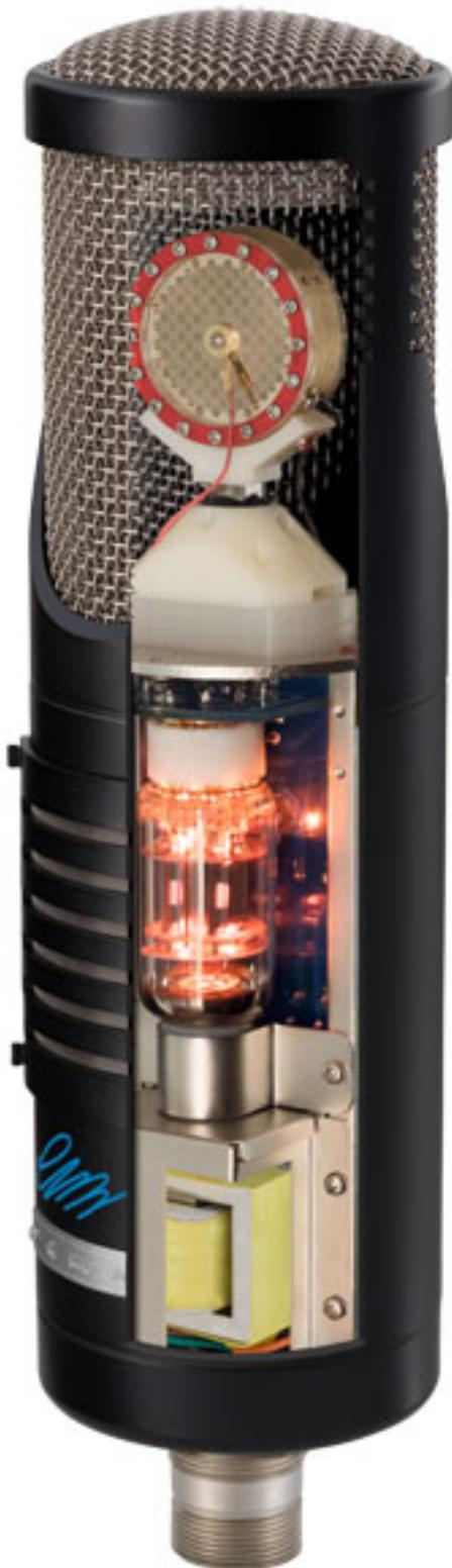
Bei der Kapsel handelt es sich um eine Kondensatorkapsel mit einem Durchmesser von einem Zoll (25 mm). Das Mikrofon selbst hat einen Durchmesser von 62 mm und eine Länge von 240 mm (Gewicht 989 Gramm). Herz des Ganzen ist die verwendete Doppeltriode ECC82 von Genalex. Genalex ist ein bekannter Hersteller
