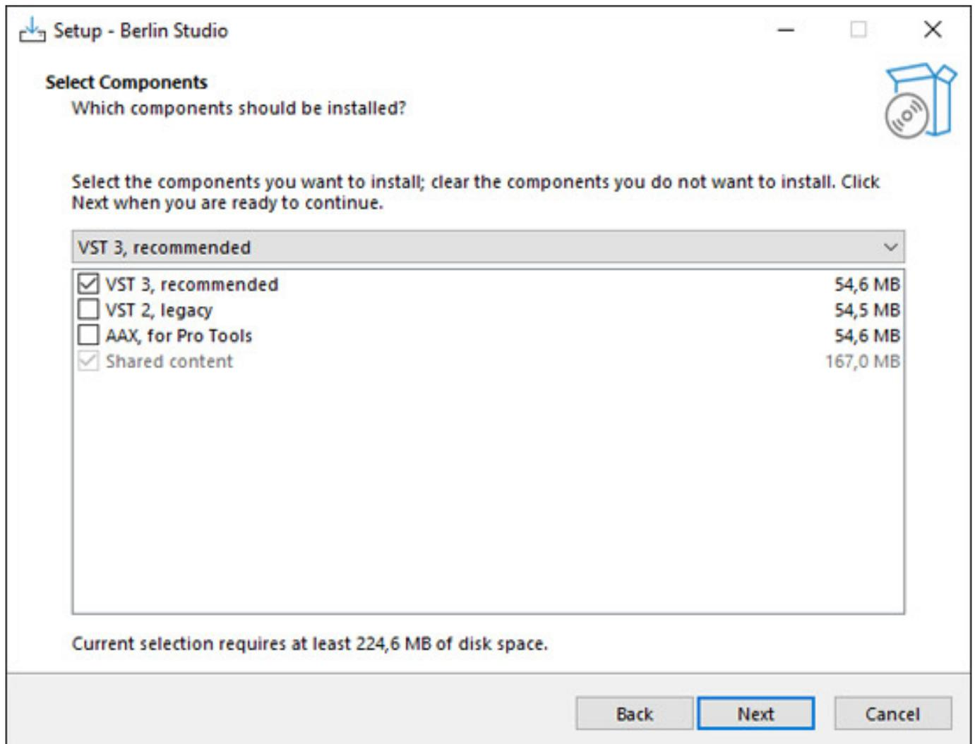
Die Installation erfolgt über einen Installer (s. Abb. oben Windows) und es werden die Plug-In-64-Bit-Formate VST 2 und VST 3 sowie AAX und auch AU (macOS) bereitgestellt. Der Kopierschutz erfolgt über iLok 2/3 USB-Stick.
