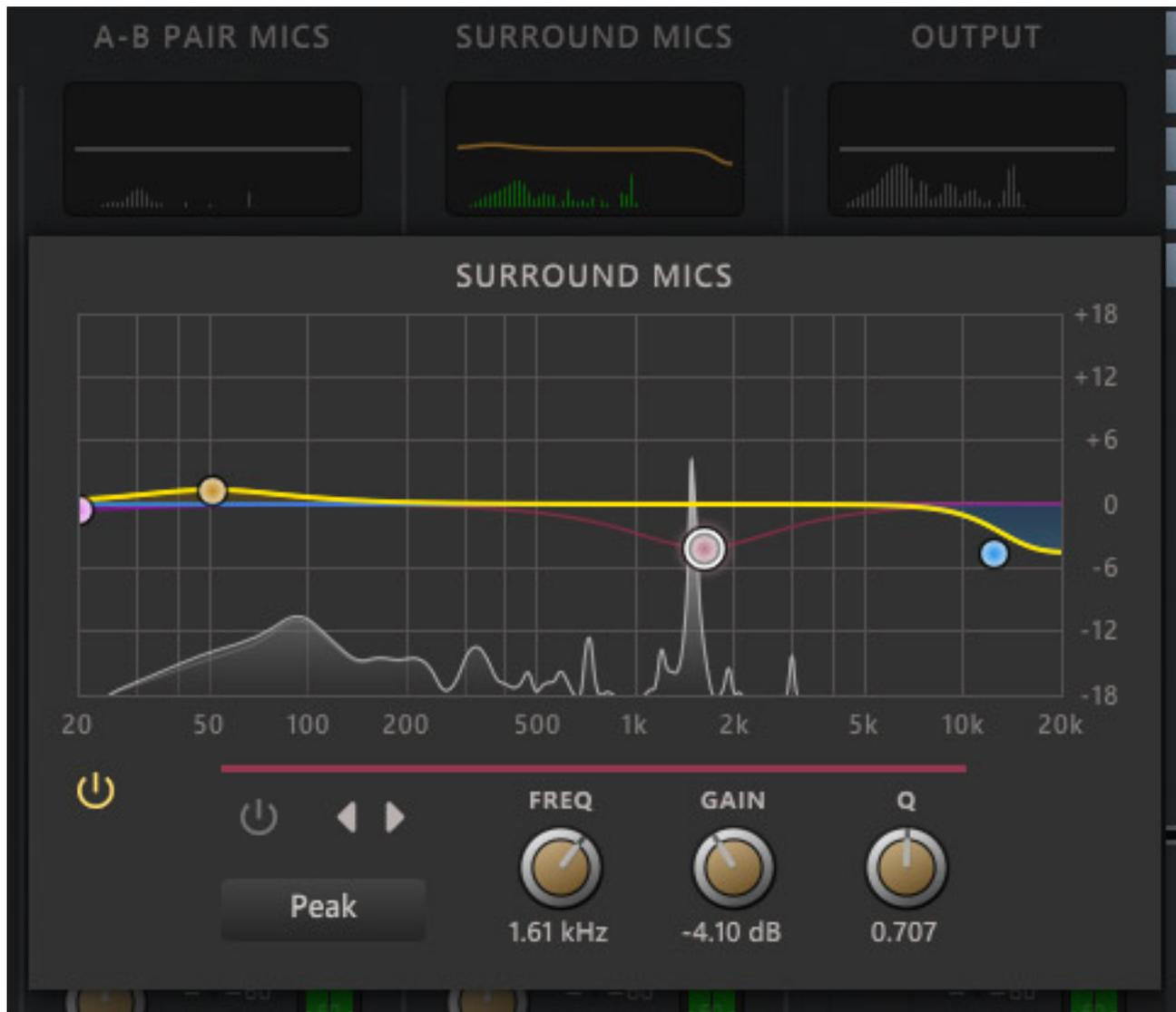
Oben im Kanalzug der Mikrofonkanäle lässt sich jeder Mikrofonkanal sowie der Quellkanal auf Solo oder stummschalten. Alle Kanäle - also auch Ein- und Ausgang - verfügen über einen zuschaltbaren Equalizer mit mehreren bis zu vier Bändern (Filtertypen: Low cut, Low shelf, Peak, High cut, High shelf). Die Einstellung kann sowohl grafisch als auch über Regler erfolgen. Auch hier lässt sich als Spektrum einblenden.
