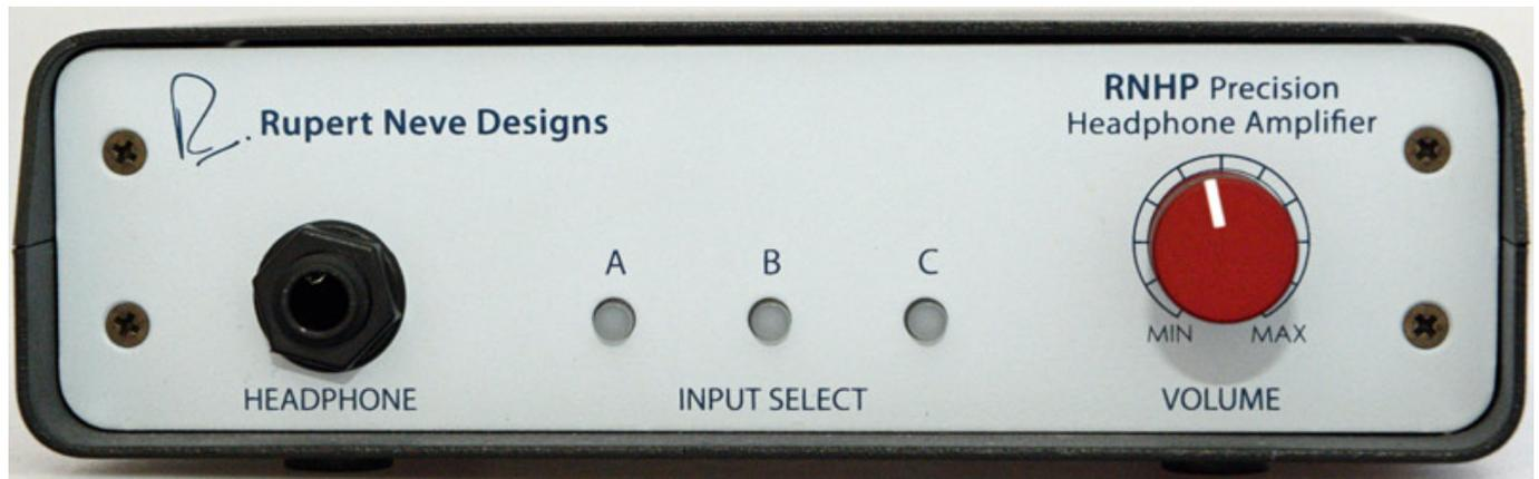
Die Umschaltung der Quellen erfolgt über drei Tipptaster auf der Front mit integrierten LED-Indikatoren (s. Abb. oben). Neben dem Potenziometer für den Kopfhörerausgangspegel gibt es keine weiteren Bedienelemente. Also ein sehr puristisches Bedienkonzept ohne Schnickschnack.
