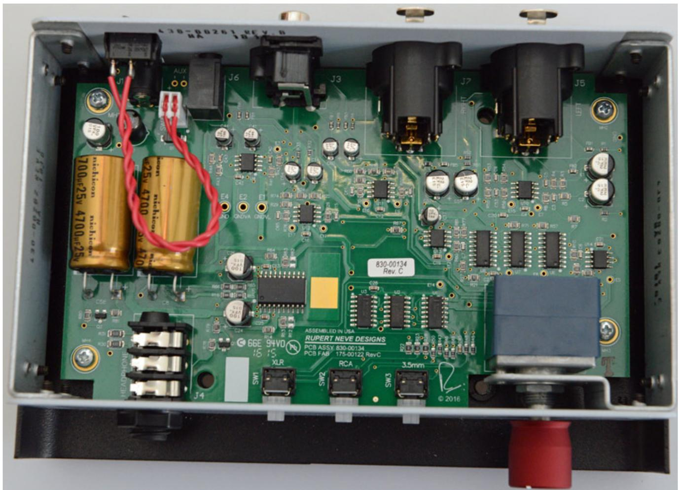
Die Verbindungswege zu Buchsen und Bedienelemente sind kurz da alle Buchsen und Bedienelemente direkt auf die Platine aufgelötet sind. Zur Einstellung des Ausgangspegels kommt ein hochwertiges Potenziometer von Alps mit hohem Gleichlauf zum Einsatz.
