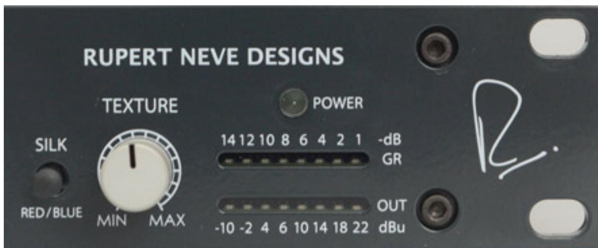
Schließlich und endlich folgt die möglicherweise interessanteste Baugruppe des Newton Channels, die mittlerweile legendäre Silk-Schaltung, die natürlich auch hier nicht fehlen darf. Ihre Bedienung ist denkbar einfach: Ein Taster wählt den Frequenzbereich, in dem die Betonung der Harmonischen erfolgt (Tiefen/Mitten bzw. Hochmitten/Höhen). Die Intensität des Effekts regelt das Poti „Texture“ in – wer hätte es gedacht? – 31 Rasterschritten.
