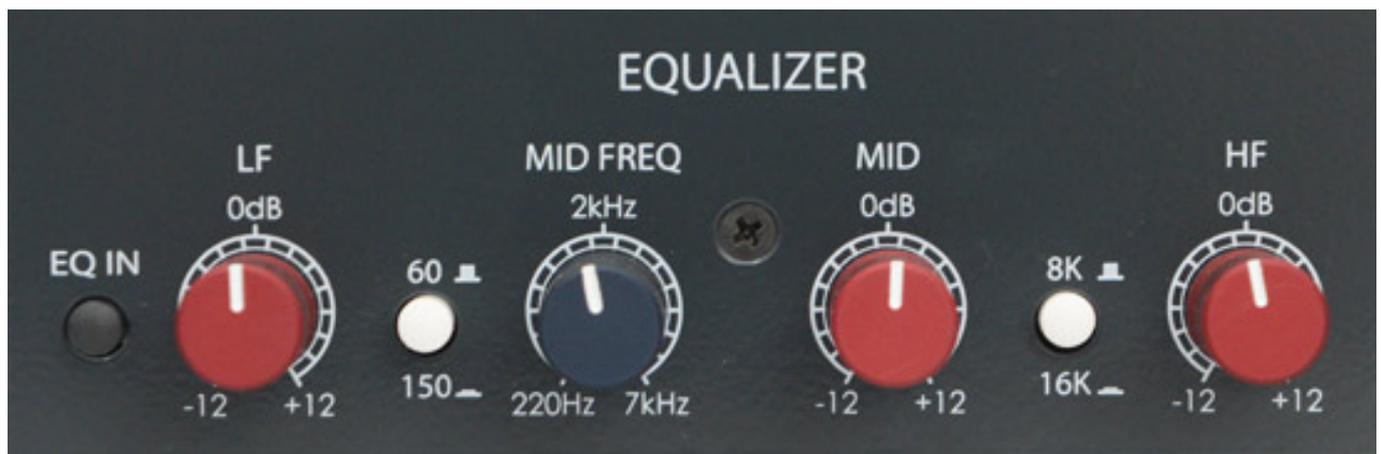
Der zuschaltbare Dreiband-EQ bietet eine ähnlich kompakte Ausstattung wie der Preamp: Während das Mittenband mit einem breiten Regelbereich zwischen 220 Hertz und 7 Kilohertz parametrisch ausgelegt ist, bieten die Tiefen und Höhen mit Shelving-Charakteristik nur jeweils zwei umschaltbare Einsatzfrequenzen. Sie liegen bei 60 bzw. 150 Hertz sowie bei acht und 16 Kilohertz. Letztere ist recht hoch angesetzt, erfüllt aber die Forderung nach reichlich „Luft“ und „Glanz“ im Signal.
