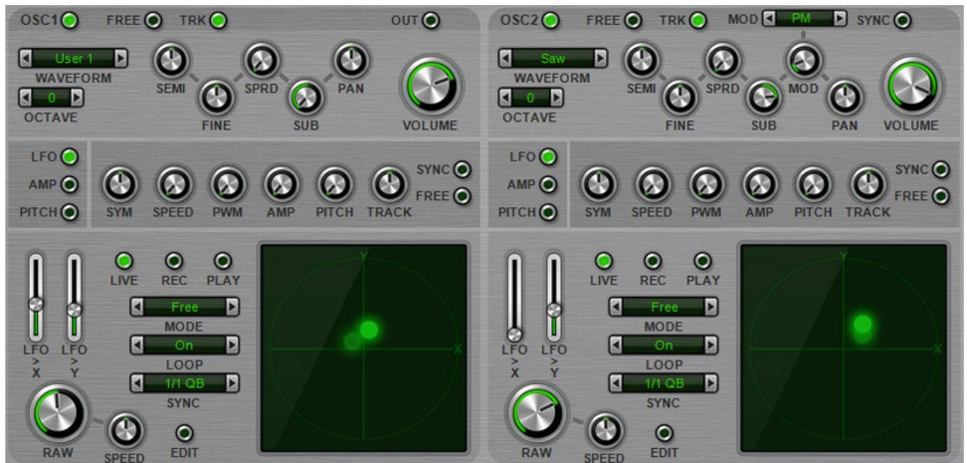
Die Oszillatorsektion besteht wie zuvor aus zwei identischen Oszillatoren mit umfangreichen Modulationsmöglichkeiten und je einem Suboszillator. Über die XY-Felder lässt sich eine Phase Distortion einstellen, bzw. modulieren. Es gibt vier Modi und zwar eine LIVE für die Echtzeit-Einflussnahme, REC für die Aufnahme eines Verlaufs und Play für die Wiedergabe eines Verlaufs.
