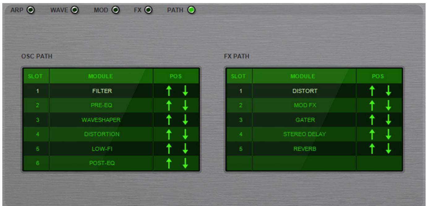
Ein besonderes Leistungsmerkmal für einen Synthesizer ist, dass man die Reihenfolge, bzw. die Position der virtuellen Komponenten in der Signalkette im Oszillator-Signalfad und im Effektpfad ändern kann (s. Abb. oben). Über die Seite PATH lässt sich dies einstellen.
