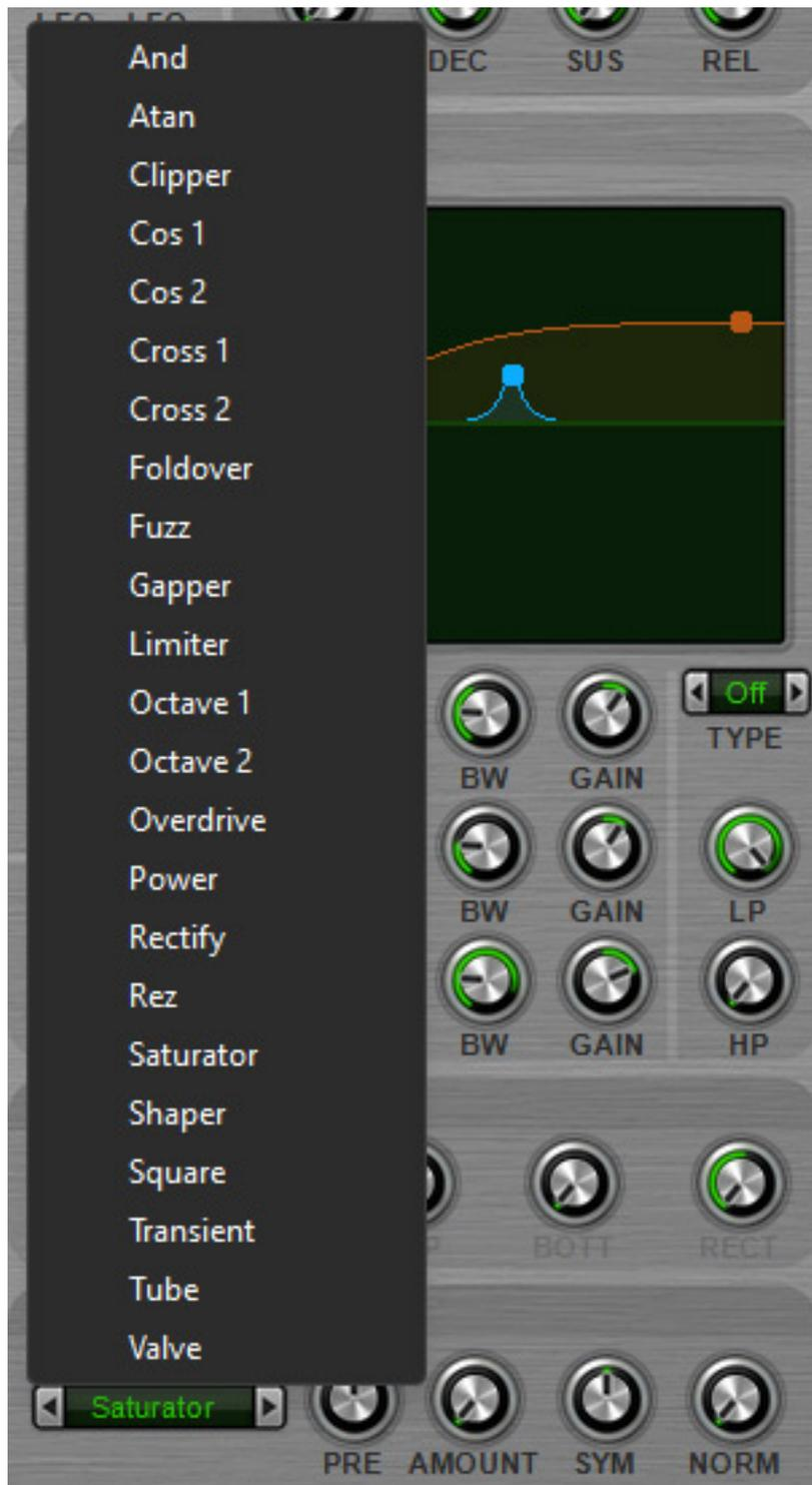
In der Verzerrer-Sektion stehen 23 verschiedene Betriebsarten zur Auswahl zur Verfügung. Bei der Low-Fi-Sektion kann die Wortbreite, Abtastrate, Rauschanteil verändert werden und ein in der Wirkung einstellbares Tiefpassfilter ist im Signalweg noch eingeschlossen.
