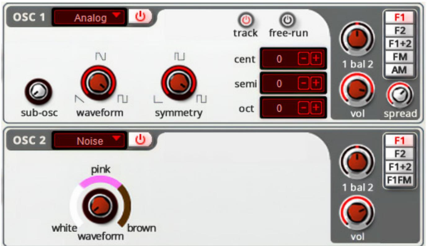
Bei der Betriebsart Analog (s. Abb. oben) kann man die Wellenform von Sägezahn bis zu Rechteck stufenlos verändern und auch die Pulsbreite lässt sich einstellen. Weiter gibt es einen Sub-Oszillator. Auch Amplituden- und Frequenzmodulation der Oszillatoren ist möglich. Bei Noise kann die Rauschfärbung stufenlos von Weiß über Pink bis hin zu braunem Rauschen verändert werden.
