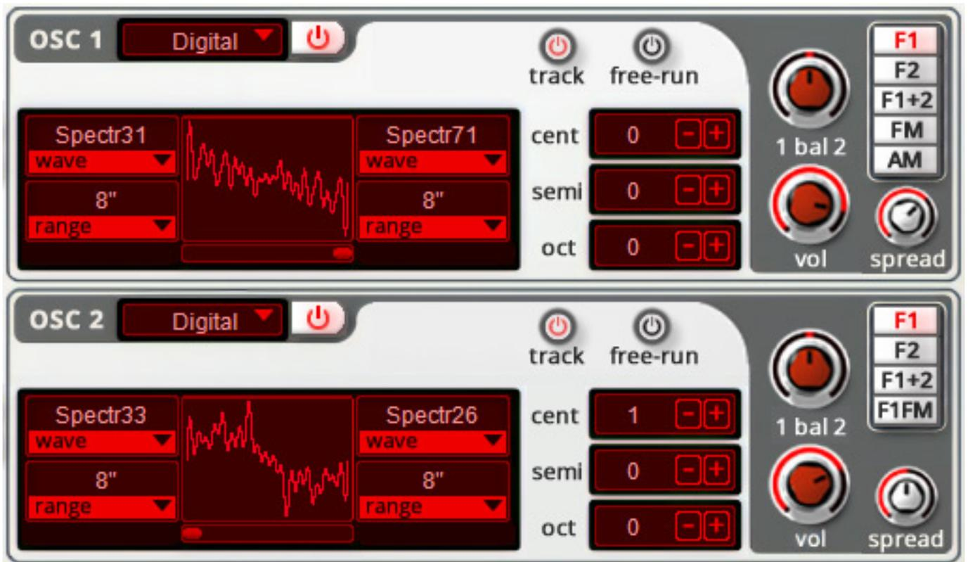
Die Oszillatoren haben vier Betriebsarten und zwar Analog, Digital, Noise und extern Audio. Bei dem Mode Digital ist auch ein Morphing zwischen jeweils zwei ausgewählten Wellenformen möglich (s. Abb. oben).
