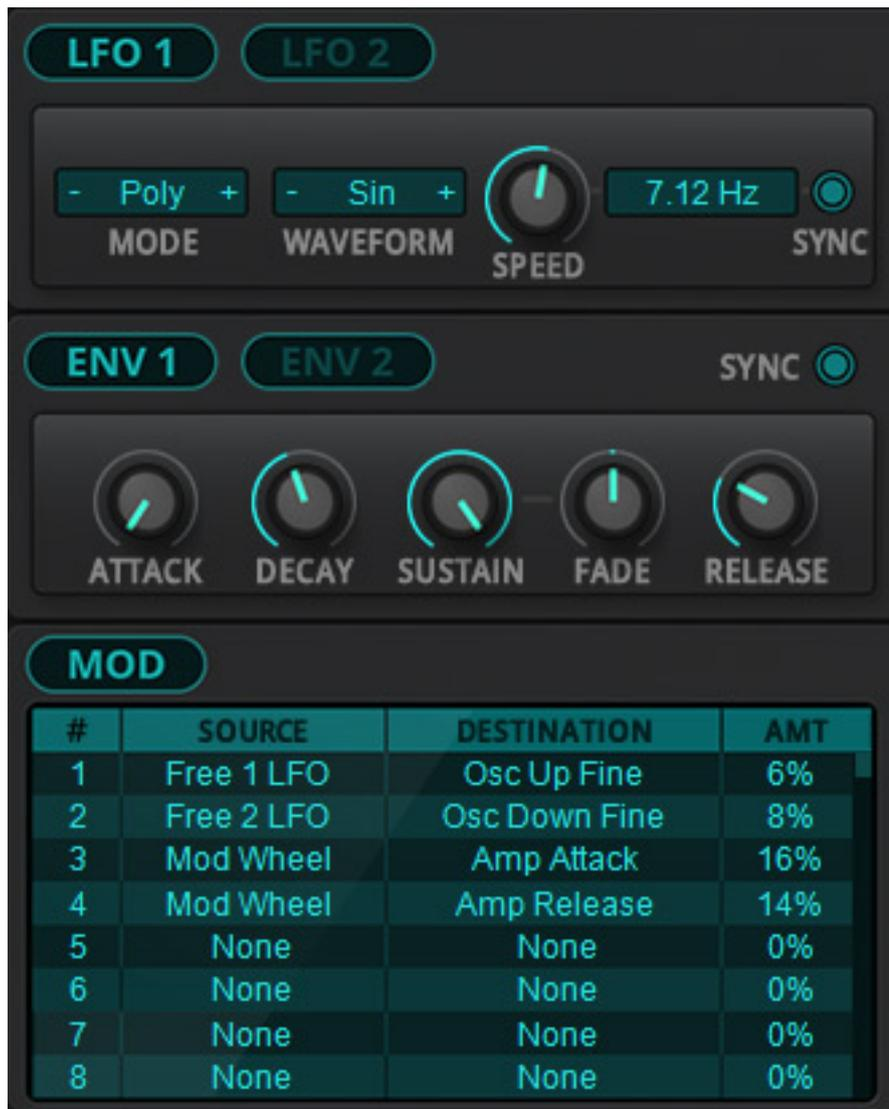
Es stehen neben den beiden Hüllkurvengeneratoren auch noch zwei LFOs und eine Modulationsmatrix zur Verfügung. Neu ist, dass es nun mehr Modulation-Slots und Modulations-Optionen gibt.
