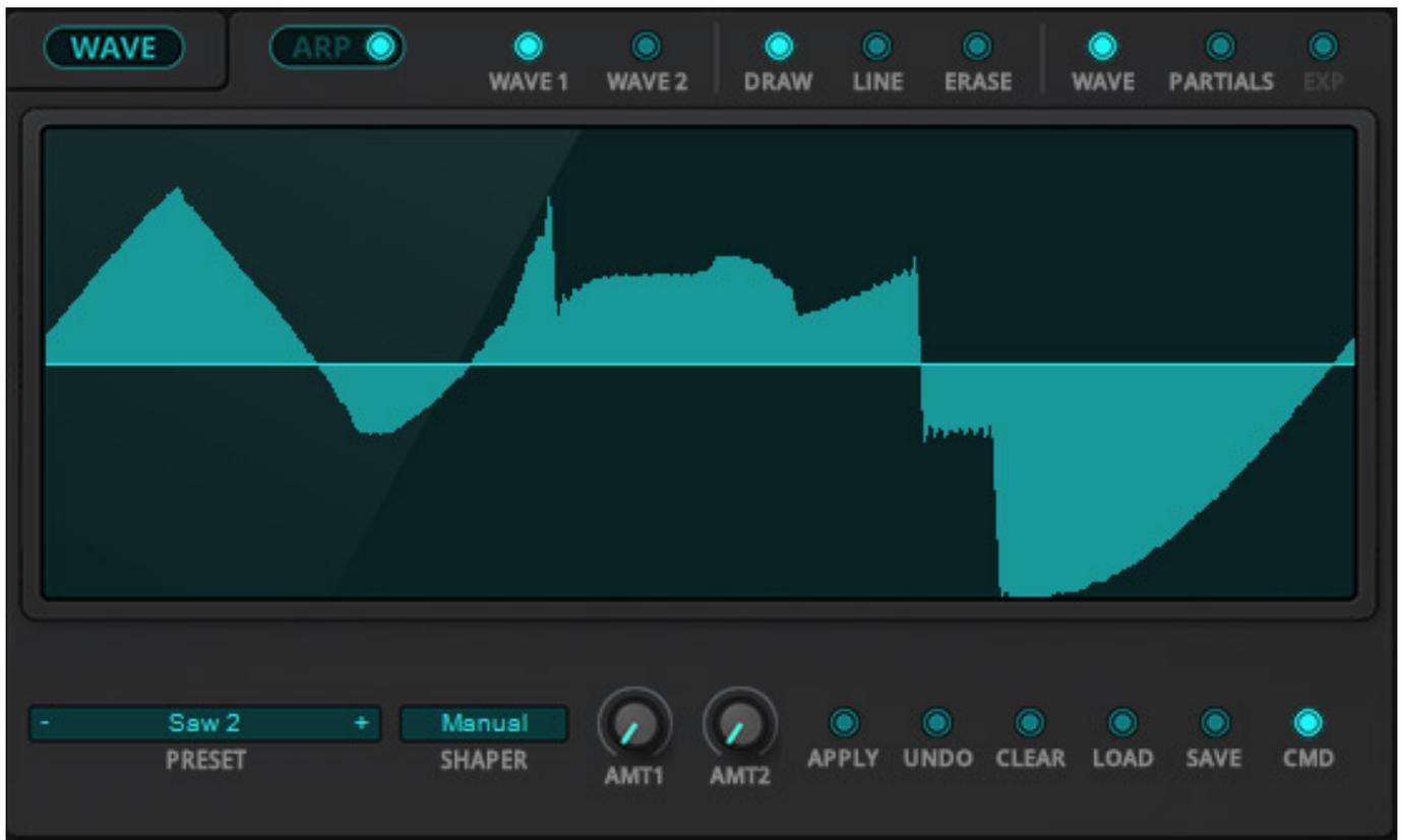
Neu ist, dass sich nun zwei Wellenformen auch mit der Maus "zeichnen" lassen (siehe Abb. oben). Das ist auch die einzige Sektion, die nun umschaltbar ist (zwischen Wellenformdarstellung und Arpeggiator).
