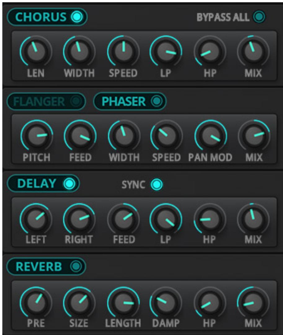
Bei Go2-X gibt es wie beim Vorgänger auch eine Effektsektion mit Chorus, Flanger/Phaser, Delay und Reverb. Neu ist aber, dass Delay und Reverb gleichzeitig zur Verfügung stehen.
