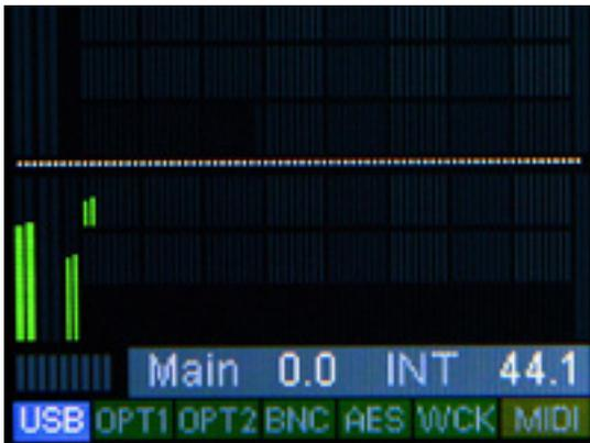
Ein farbiges Display dient als Übersicht für die Aussteuerung, bzw. der Pegel. Wenn man aber ein der vier Tasten betätigt oder am Drehgeber regelt, ändert sich die Anzeige und der entsprechende Parameter wird angezeigt.
