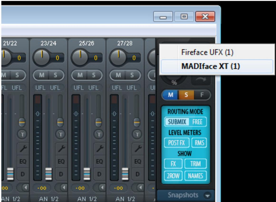
Im TotalMix lassen sich aber alle angeschlossenen Interfaces bedienen, also auch Fireface-Interface und MADiface XT gemischt (s. Abb. oben). Die Auswahl des jeweiligen Interfaces was bedient werden soll erfolgt oben rechts in einem Auswahlmenü.
