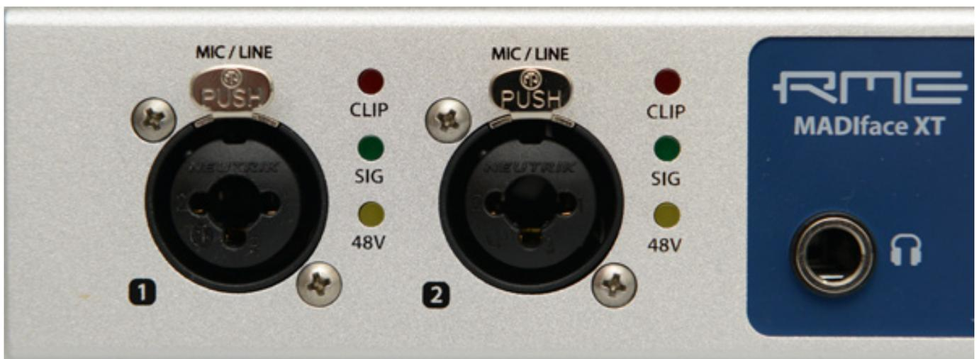
Wenn man also einmal zusammenfasst, dann stehen 3 x 64 MADI-I/Os, zwei AES/EBU-I/O-Kanäle sowie zwei analoge Ein- und Ausgänge bereit. Das macht ohne den Kopfhörerausgang also 196 Kanäle.
