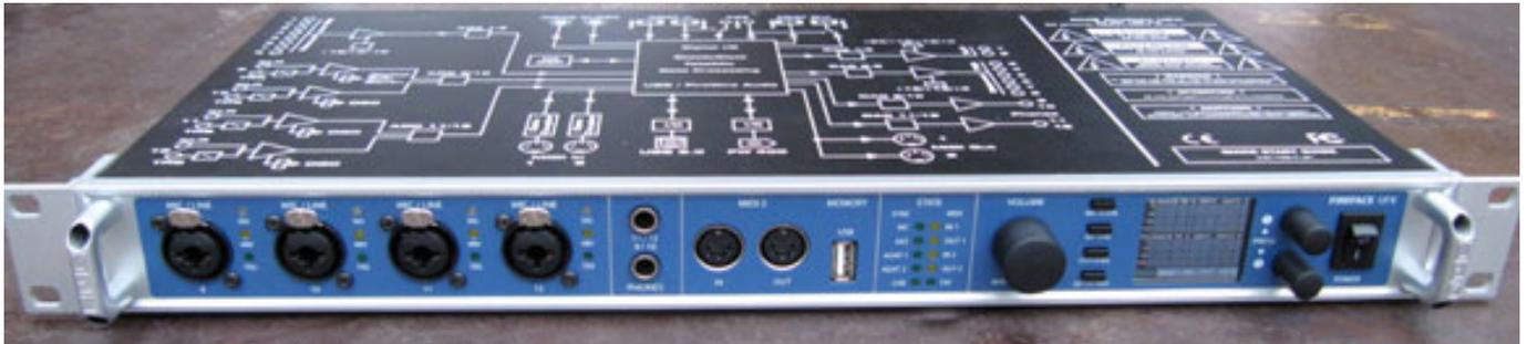
Das Frontpanel bietet vier kombinierte XLR/Klinkeneingänge für Mikrofon- und Line-Pegel-Signale. Drei LED-Indikatoren, jeweils neben den Eingängen, geben unmittelbar Aufschluss über aktive Phantomspeisung, anliegendes Signal und aktivierten Klinkeneingang. Für schnelle Überprüfung, z. B. bei Fehlersuchen im Signalweg, können diese Anzeigen unter anderem sehr hilfreich sein, vor allem wenn man im Stand-Alone Modus arbeitet, also ohne Rechner.
