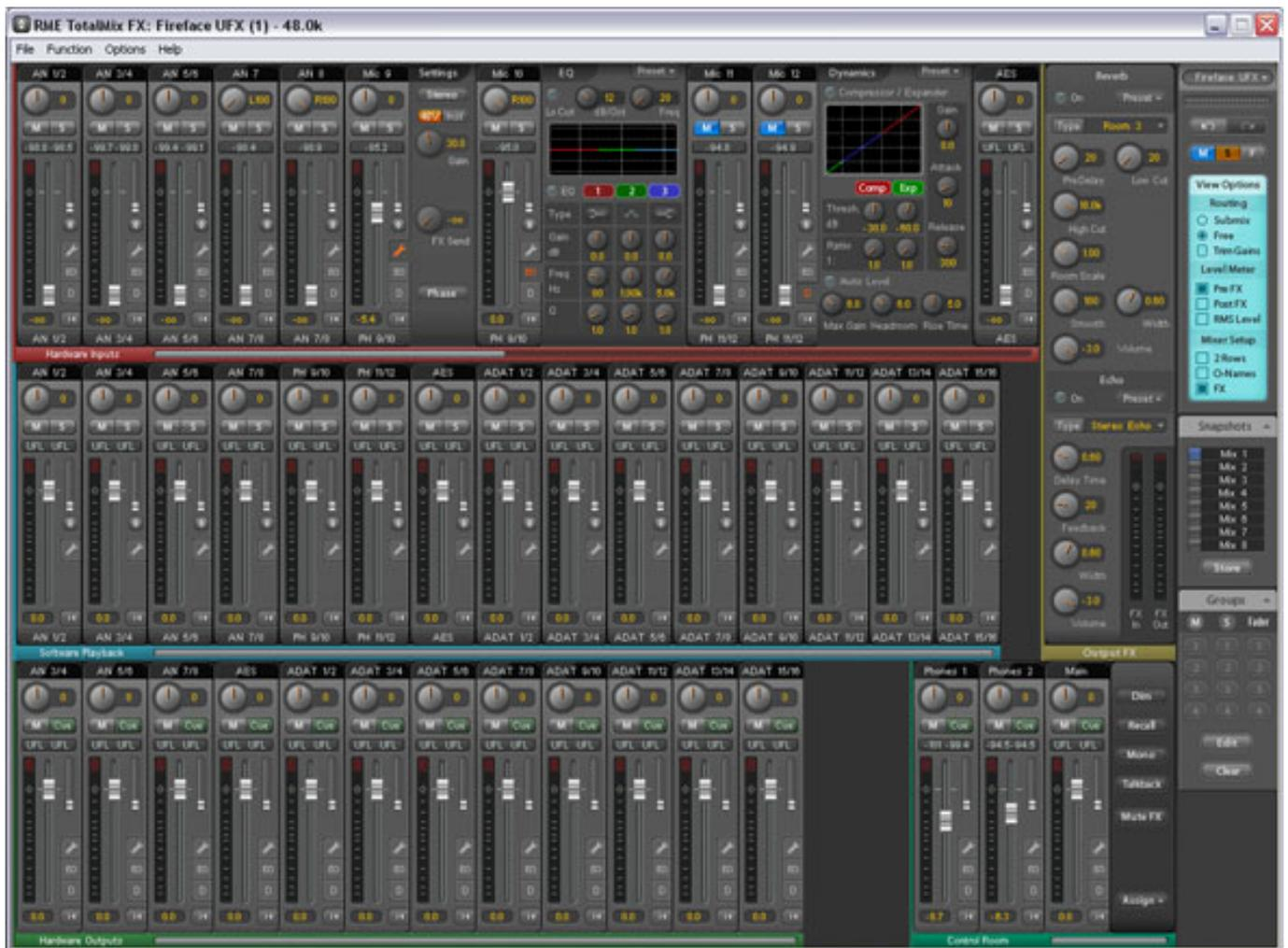
Unten einmal ein Detailausschnitt des oberen Bereichs des Mixers. Ein parametrischer Dreiband-EQ lässt genügend Einfluss zu um z. B. auch mal eine kleine Live Veranstaltung in den Griff zu bekommen. Die Kompressor/Expander Unit rundet das Signal Pre-Processing mit angemessenen Eingriffsmöglichkeiten und Bedienungskomfort ab.
