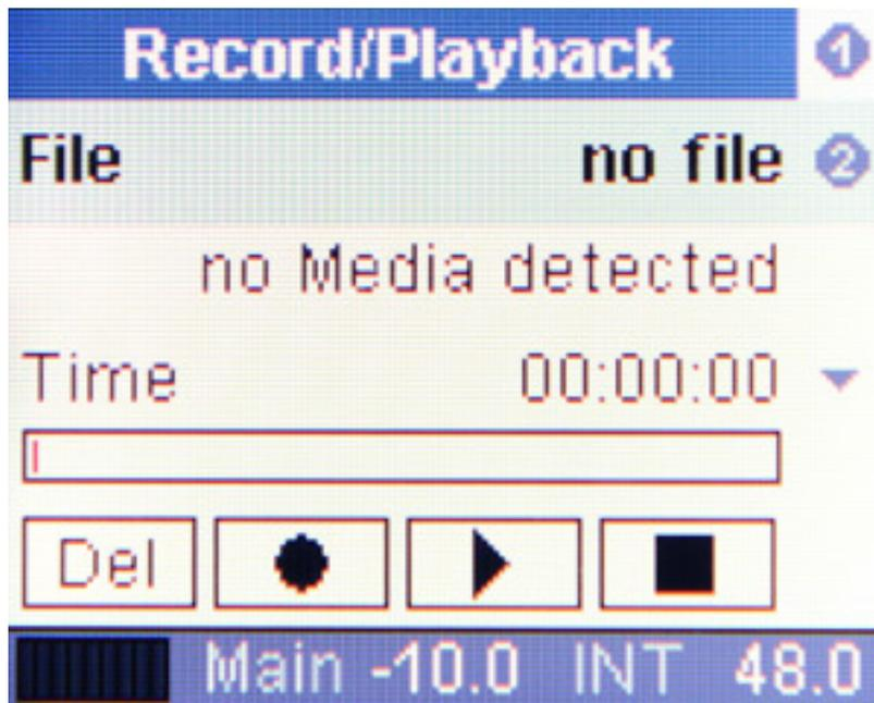
Über den Taster "REC/PLAY" lässt sich bei einem eingesteckten Medium (s. Abb. oben mit fehlenden Medium) die Direct-USB-Aufnahme starten (DURec) oder das Aufgenommene abspielen. Auch hier kann das UFX+ mehr als das UFX denn es lassen sich alle 12 analogen Eingänge plus 64 MADI-Kanäle aufzeichnen und die Möglichkeiten des Players wurden an einigen Stellen erweitert.
