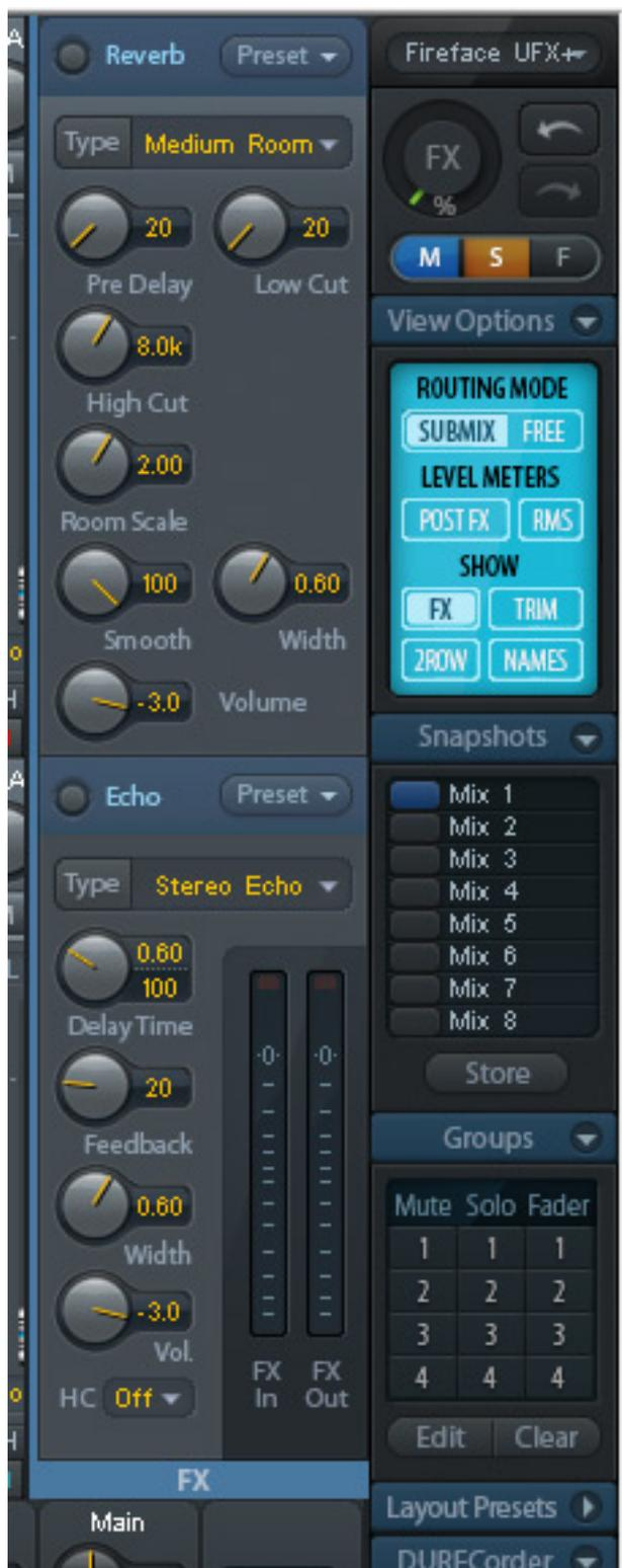
Der interne DSP im Fireface bietet auch eine Effektsektion mit einem Reverb und einem Echo (s. Abb. oben).
