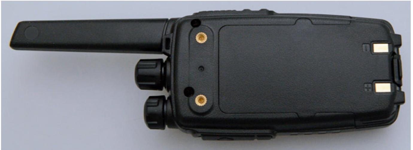
Der Kunststoff-Clip lässt sich auf der Rückseite festschrauben (s. Abb. oben). Der Akku hat eine Kapazität von 1.700 mAh und bietet bei DMR-Betrieb, je nach Sprechdauer, bis zu zwölf Stunden Betriebszeit. Der Akku ist nicht fest verbaut und lässt sich auch tauschen. Ersatzakkus werden vom Hersteller angeboten.
