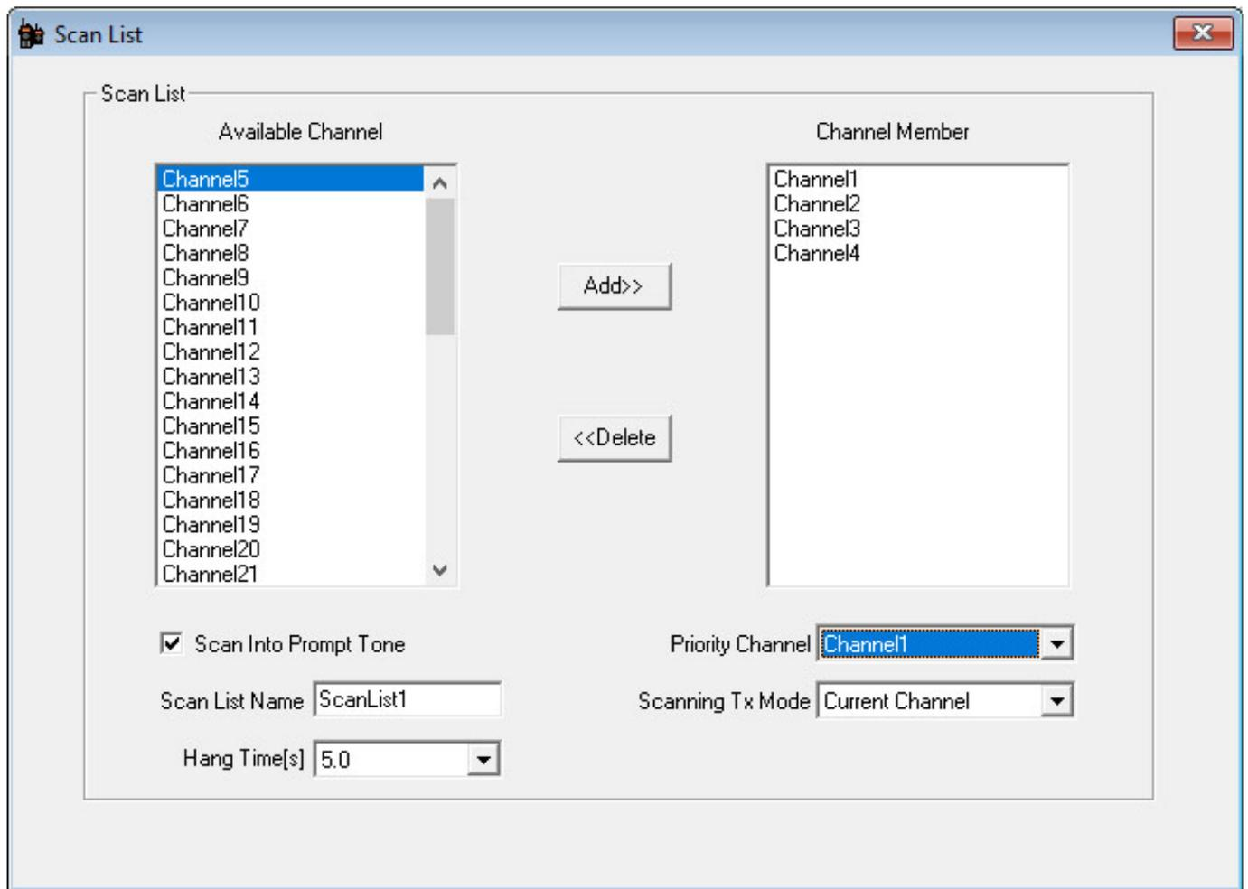
Es lassen sich auch mehrere Scan-Listen anlegen. Über eine Scan-Liste kann man über mehrere analoge und/oder digitale Kanäle hinweg monitoren. Ist auf einem Kanal Betrieb festzustellen so bleibt man für eine bestimmte, voreingestellte Zeit auf diesem Kanal (s. Abb. oben).
