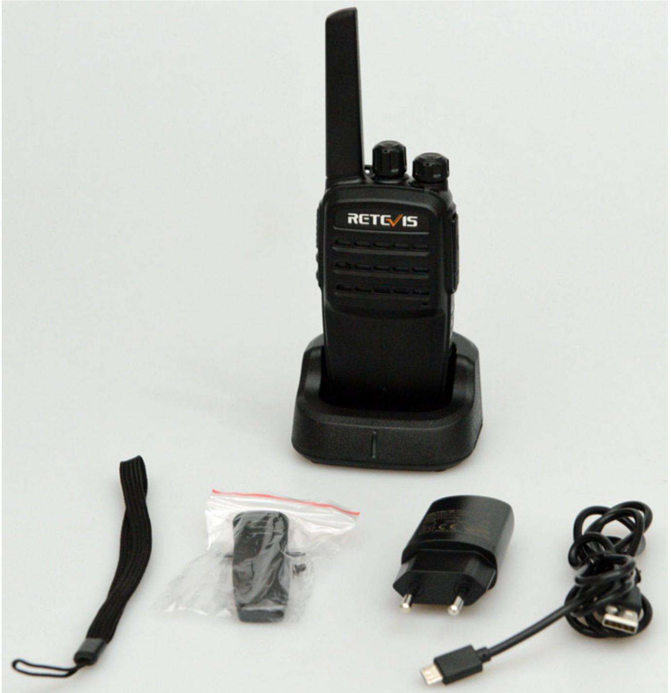
Mitgeliefert wird eine Ladeschale mit Netzteil (USB-Ausgang) und USB-Kabel (nur zum Laden nicht zur Programmierung), Trageschleife sowie einem Kunststoff-Clip.
