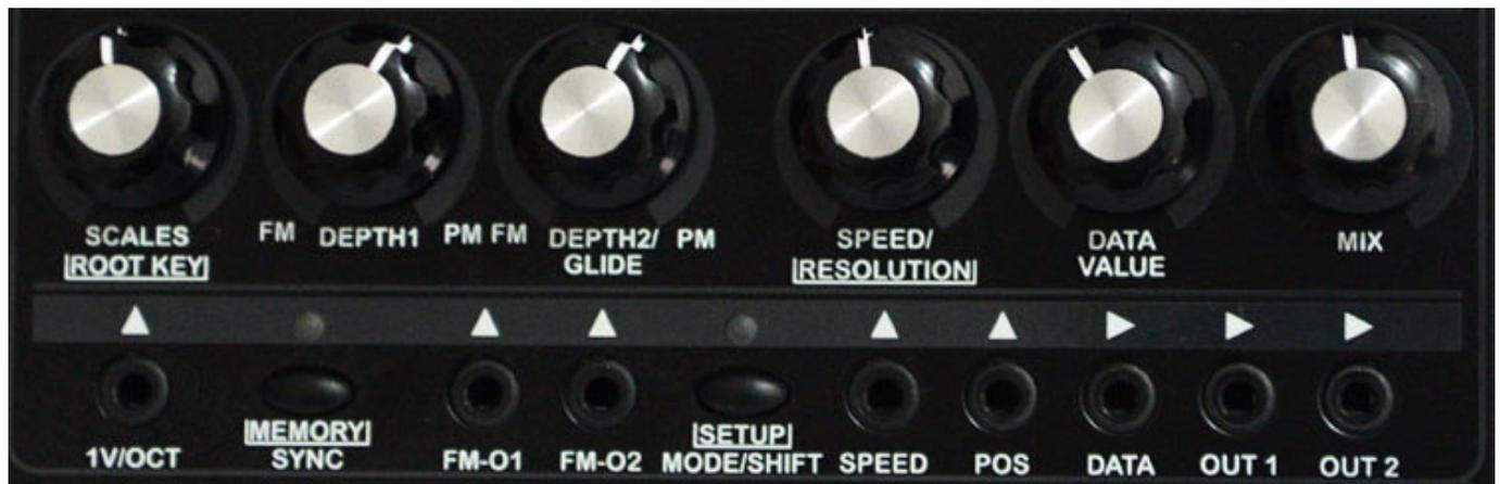
Schauen wir uns noch die Ein- und Ausgänge im unteren Modulbereich an. Hier gibt es einen Eingang für V/Okt. Steuerspannung, je einen Eingang für FM-Modulationsgrad von Oszillator 1 auf 2 und 2 auf 1. Die FM lässt sich auch manuell mit den beiden Reglern FM DEPTH1/2 durchführen. Über den Regler SCALES lässt sich auch eine Quantisierung auf eine bestimmte Tonskala aktivieren. Es stehen hier sieben Dur und Molltonarten zur Auswahl bereit.
