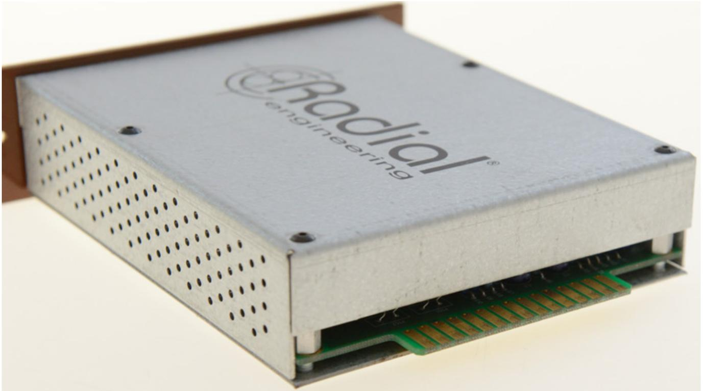
Der maximale Eingangspegel des Q4 beträgt 21 dBu, der maximale Ausgangspegel 18 dBu. Mit aktivem Equalizer ist der Dynamikumfang größer 95 dB. Bei Mittelstellung der Filter-Gains macht der Q4 eine Verstärkung von 4,8 dB. Die Eingangsimpedanz liegt bei 20 kOhm und die Ausgangsimpedanz bei 150 Ohm. Ein- und Ausgänge sind symmetrisch ausgeführt. Die Stromaufnahme beträgt 80 mA.
