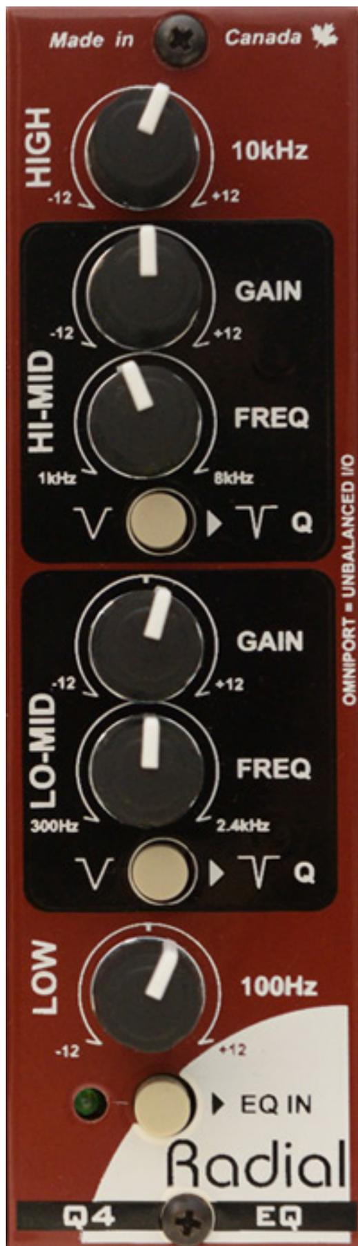
Vollparametrisch muss man etwas in Anführungszeichen setzen, da lediglich zwei Gütenwerte (Q) pro Filter selektierbar sind, die über einen Druckschalter angewählt werden. Die maximale Verstärkung pro Filterband beträgt +/-12 dB.
