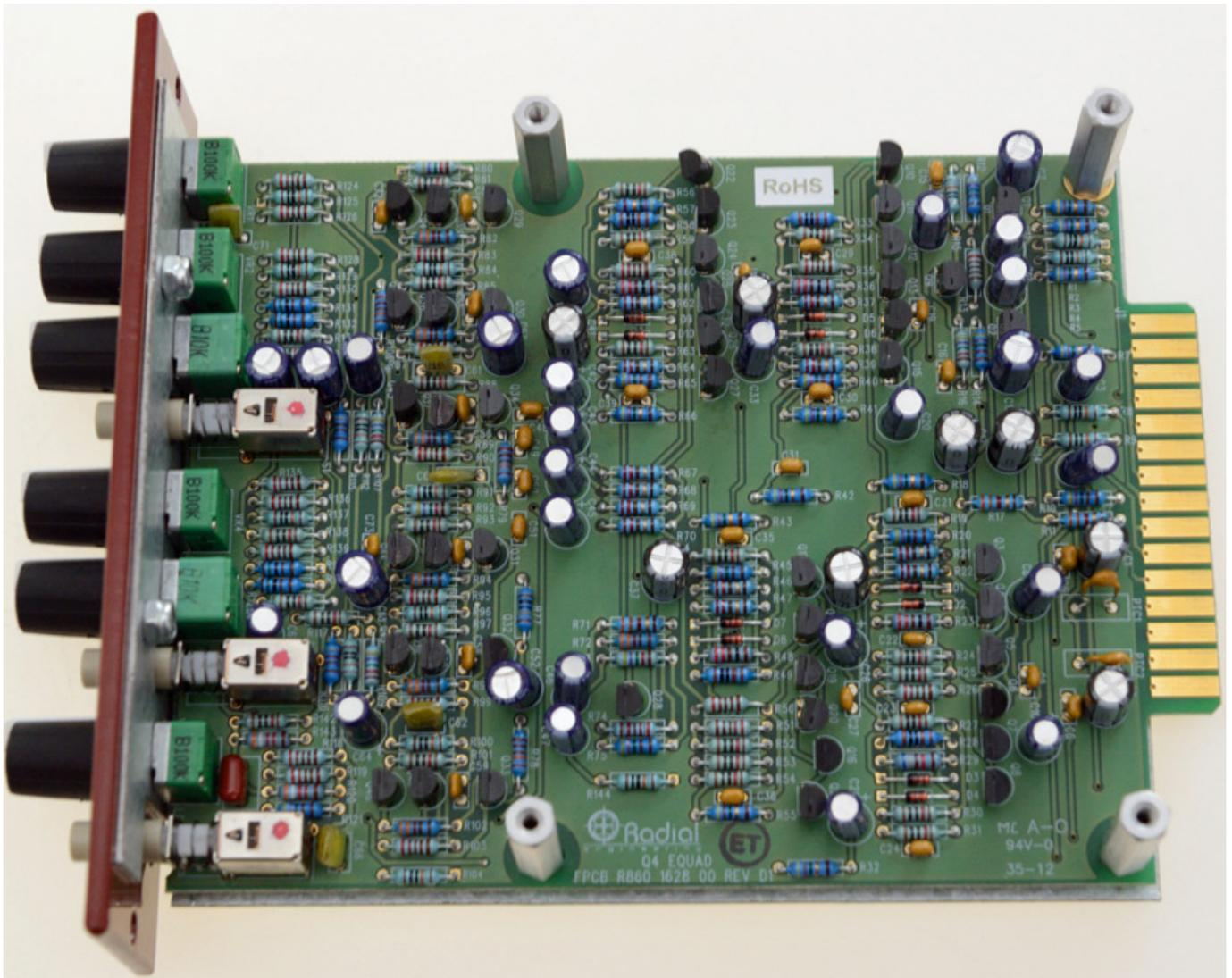
Das Gehäuse ist wie bei der Radial 500er-Serie üblich ausgeführt. Man sieht bei einem Blick auf die Platine, dass ausschließlich diskrete Bauelemente verwendet werden, also keine integrierte Operationsverstärker o.ä. Der Q4 ist mit Class-A Verstärkerstufen aufgebaut.
