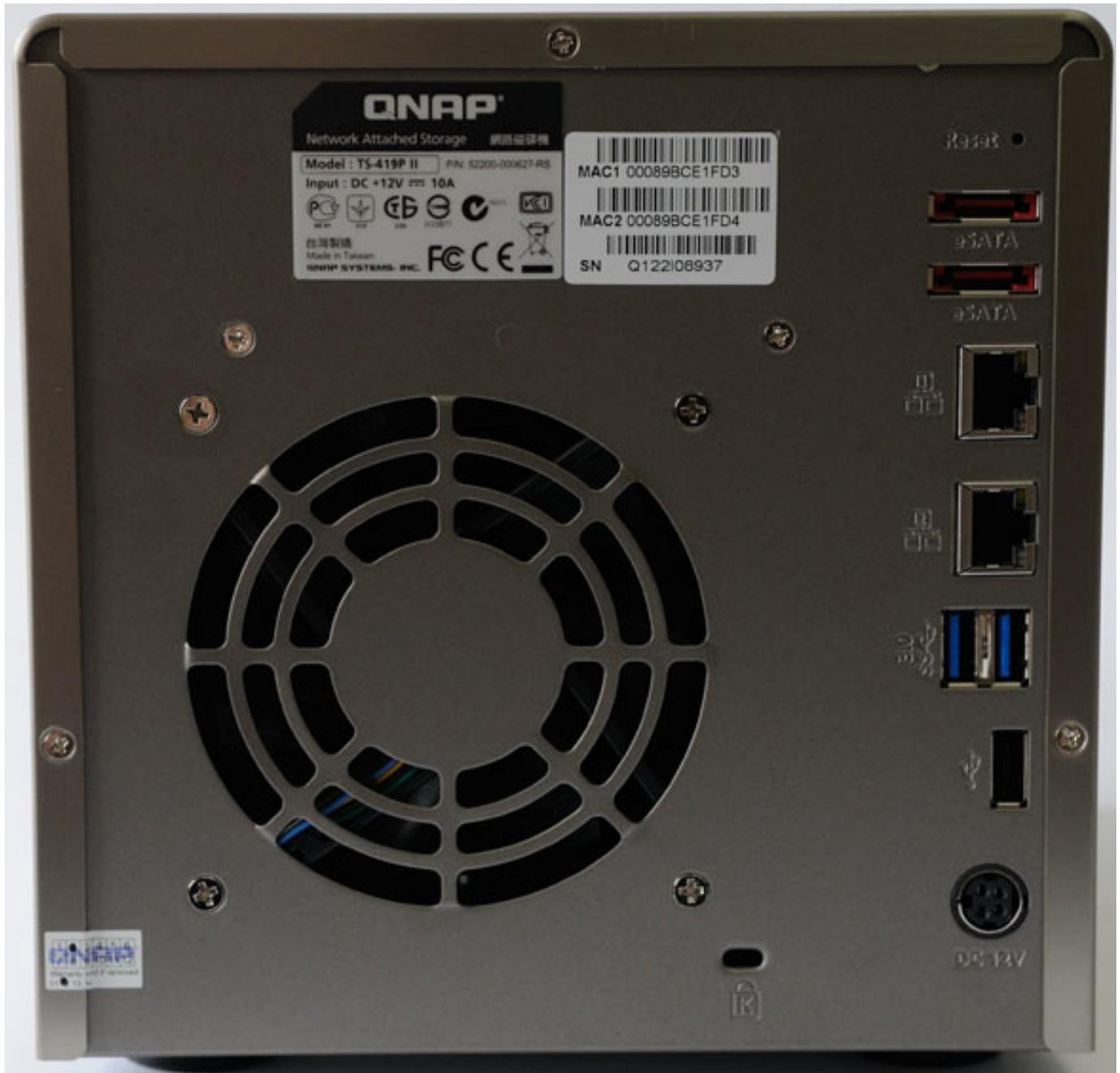
Auf der Geräterückseite befinden sich zwei Ethernet-Anschlüsse (10/100/1000 MBit/s), die getrennt konfiguriert werden können. Das Gerät verfügt über WakeOnLAN und geht so nach einer bestimmten Zeit in den Stand-By-Modus. Vorne und hinten steht je eine USB-2.0-Schnittstelle sowie - entgegen dem Datenblatt - sogar zwei USB-3.0-Schnittstellen bereit. Über zwei eSATA-Buchsen lassen sich auch externe Festplatten anbinden.
