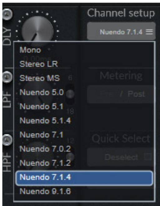
Wenn man in einem 7.1.4 Setup nur zum Beispiel die vorderen Kanäle beeinflussen möchte, kann man hier auch ein 5.0 Setup für das Plug-In wählen. Die Kanäle, die nicht auf der Oberfläche sichtbar sind, werden dann unbearbeitet durchgereicht.
