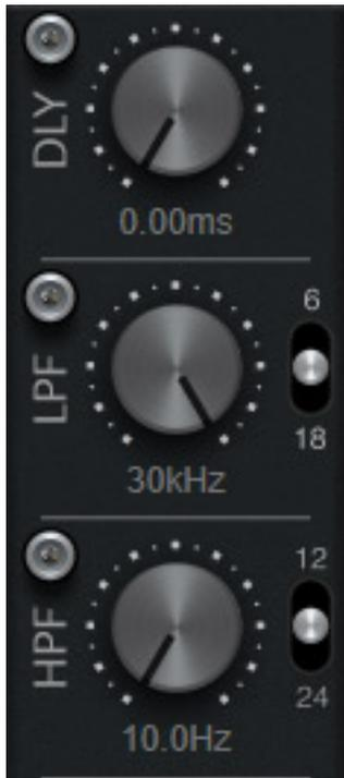
Im oberen Teil des Kanals lässt sich eine Kanalverzögerungszeit einstellen und zwar mit einer Auflösung von 10 Mikrosekunden. Des Weiteren gibt es ein Hochpassfilter (einstellbare Grenzfrequenz von 60 Hz ... 30 kHz) mit 12, 16 oder 24 dB/Okt. und ein Tiefpassfilter (10 Hz ... 10 kHz) mit 6, 12 oder 18 dB/Okt. Filtersteilheit (s. Abb. oben).
