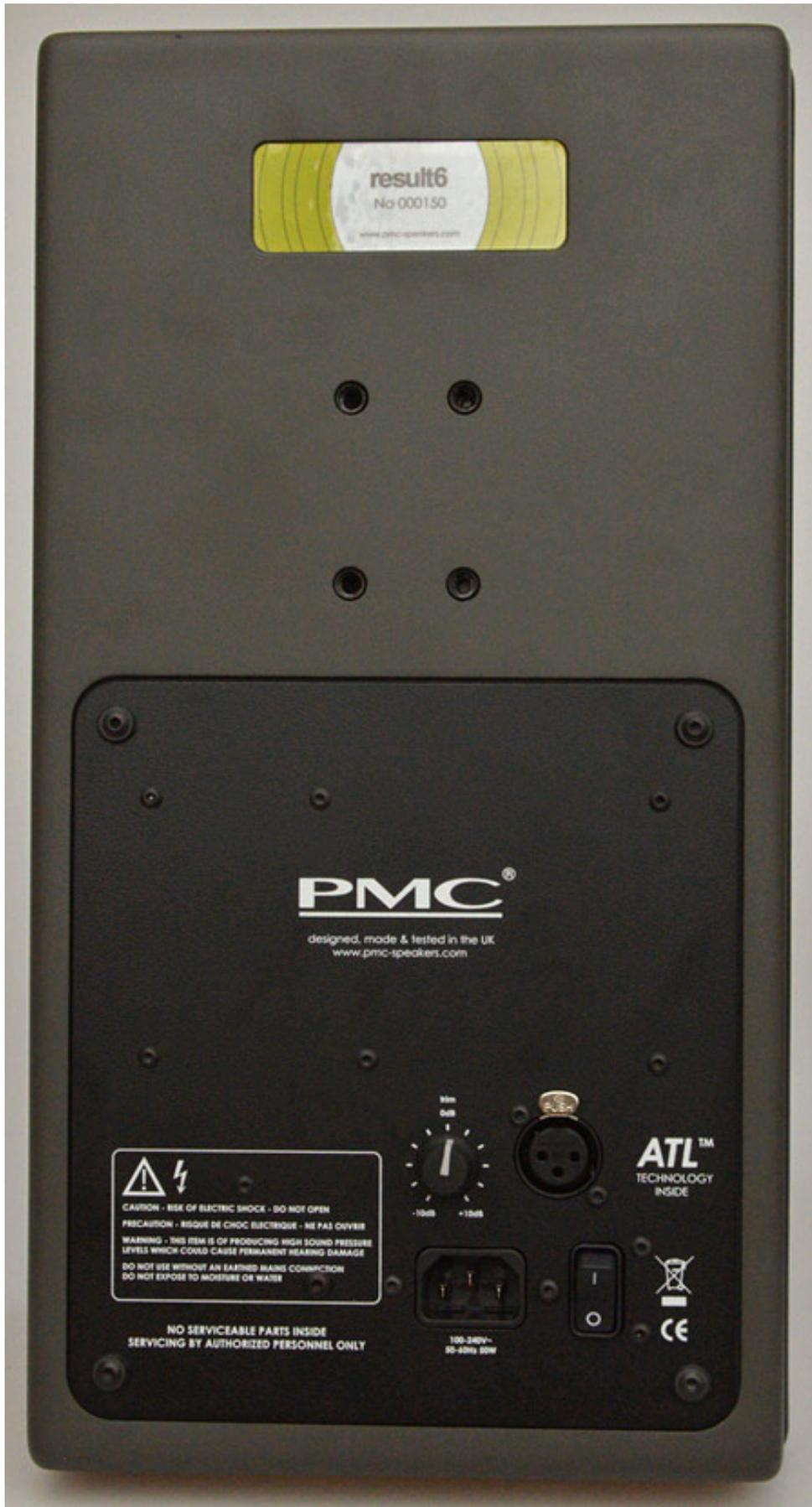
Auf der Rückseite befinden sich vier Löcher mit darin befindlichen Gewinden zur Befestigung der Box. Es wird übrigens als Option sowohl ein Ständer (tube104 stands) als auch eine Halterung für die Wandmontage.
