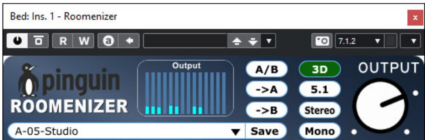
Im unteren Bereich lassen sich drei Seiten aufrufen und zwar die "Presets Page" für Pegelinstellungen, die "Main Page" für das Einstellen der Parameter der drei Engines, sowie die "Options Page" für die Plug-In-Konfiguration.
