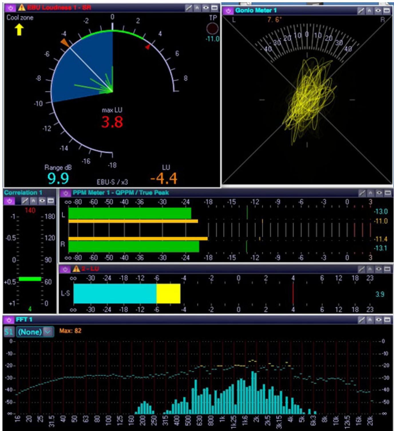
Bei dem PG-AMM der Hamburger Firma Pinguin Ingenieurbüro handelt es sich um eine Metering-Software für Windows- und Mac-Rechner. Erstmals wurde das PG-
