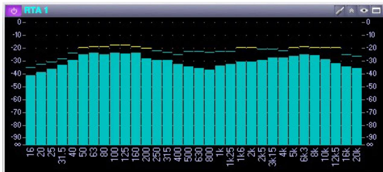
Der Real Time Analyzer teilt das Audiospektrum in 1/3 Oktavbänder und stellt den Pegel der einzelnen Bänder dar. Im Gegensatz zum FFT werden hier Bandpassfilter
