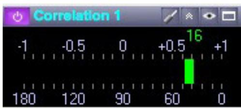
Das Korrelationsmeter zeigt die Phasenkorrelation zwischen zwei Audiokanälen in
