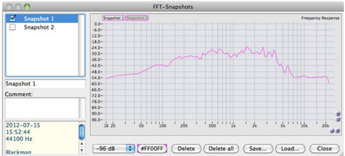
Es gibt die Möglichkeit, Snapshots der Messungen zu machen. Diese können in einem Snapshot-Fenster geöffnet und verglichen werden.
