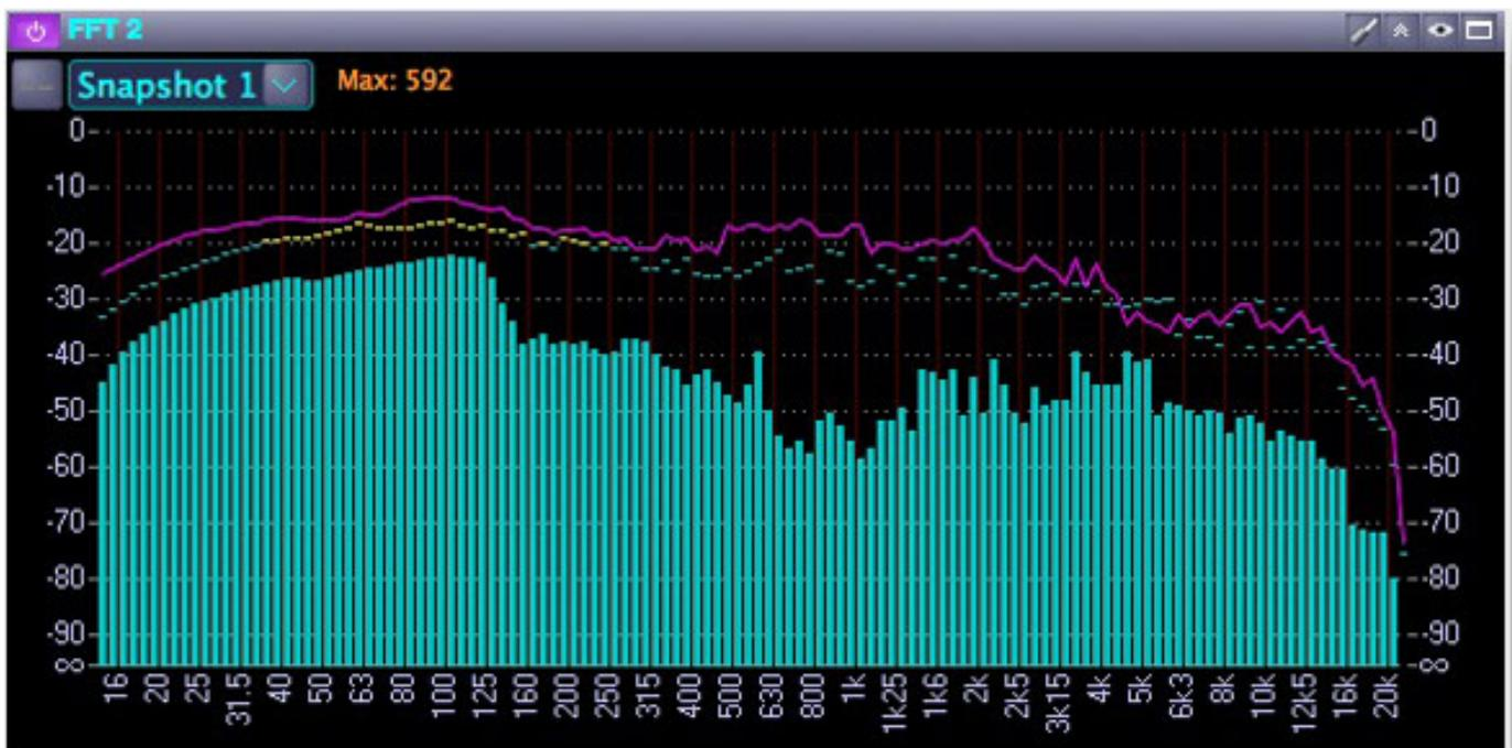
Der FFT-Analyzer bietet eine große Auswahl an Menüoptionen. Es stehen verschiedene Eingangsoptionen (L+R, L, R, L-R) sowie Messverfahren wie z.B. Hanning, Hamming, Blackman etc. zur Verfügung. Die Fenstergröße ist auf 2048 Samples festgelegt. Ein zuschaltbarer Peak Hold zeigt die Maximalwerte dauerhaft an.
