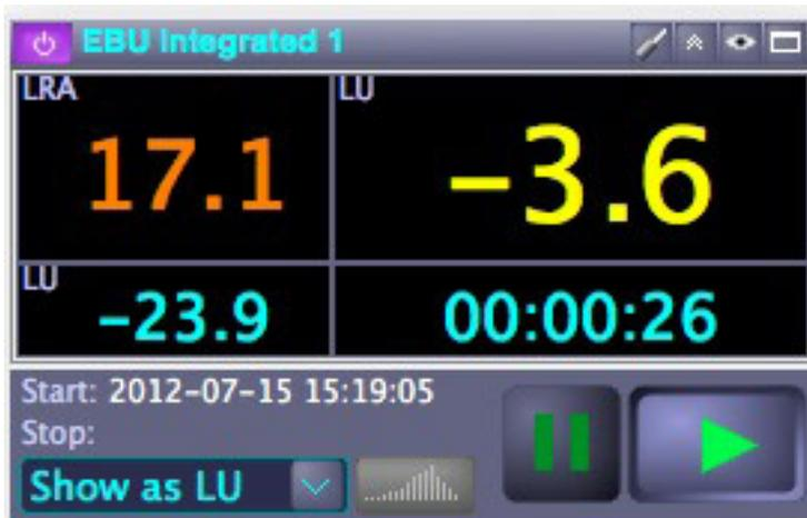
Das EBU Integrated Meter erlaubt eine Messung der Loudness Range über Zeit. Der Messvorgang wird mittels eines Start/Play Buttons gestartet, das Beginn und Ende der Messung wird inklusive Datum angezeigt. Es sind Messungen auch über Tage hinweg möglich. Als Werte werden links oben der Loudness-Bereich (LRA), rechts oben der integrierte Wert, links unten der Kurzzeitwert und rechts unten der Zeitraum der Messung angezeigt.
