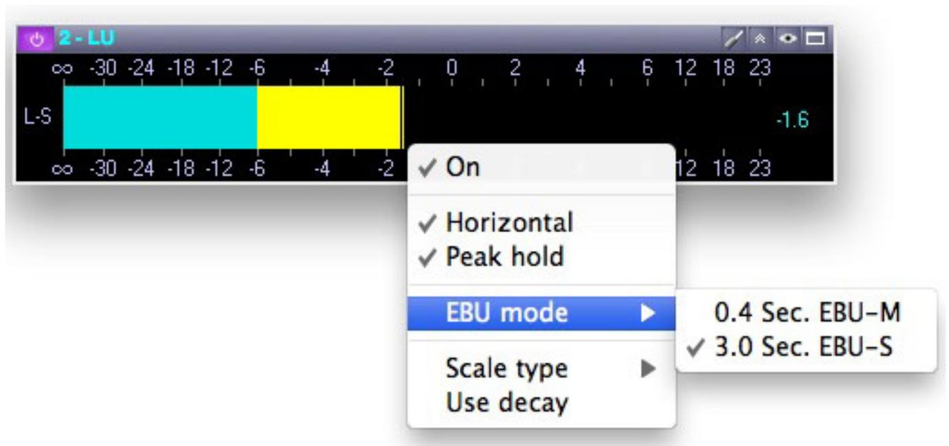
Das Loudness Meter zeigt die Lautheit eines Signals an. Es sind verschiedene Skalen sowie die beiden Zeitkonstanten Momentary (0,4 sec) und Short (3,0 sec) in der Menüoption auswählbar. Die anwählbare Option "Use decay" aktiviert eine Abfallzeitkonstante für die Momentary-Messung.
