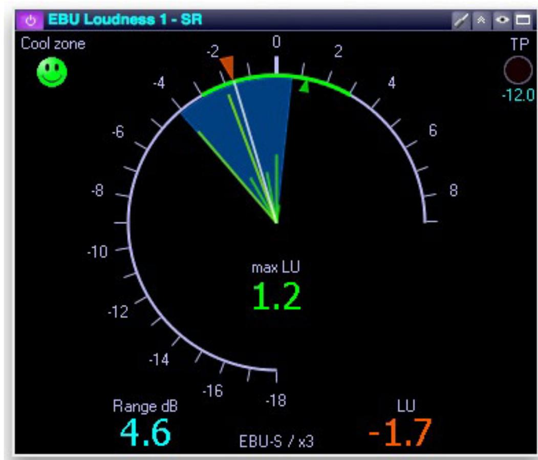
Das EBU Loudness Meter stellt mehrere Messwerte dar. Der aktuelle Wert wird mittels eines „Tachos“ dargestellt. Der Zielwert liegt auf der 12-Uhr-Position. Die Skala kann auf einen relativen (LU) oder absoluten Wert (LUFs) eingestellt werden, verschiedene Skalenauflösungen sind möglich. Wird ein Wert innerhalb einer vom Benutzer einstellbaren ‚Cool Zone‘ erreicht, erscheint der grüne Smiley. Werte, die außerhalb dieser Zone liegen, werden mittels eines roten oder gelben Pfeiles angezeigt.
