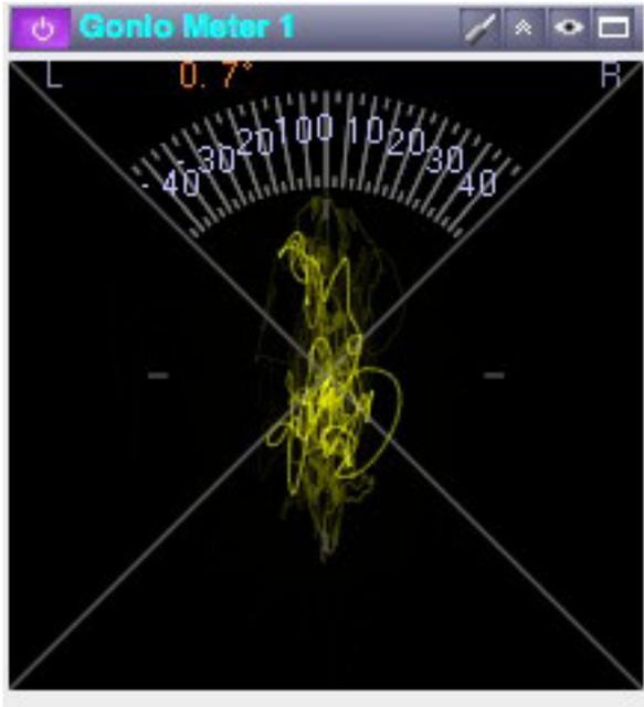
Das Goniometer (Audio-Vektor-Sichtgerät) zeigt, wie das Korrelationsmeter, die Phasendifferenz eines Stereosignals, jedoch in einer detaillierteren Darstellung.
