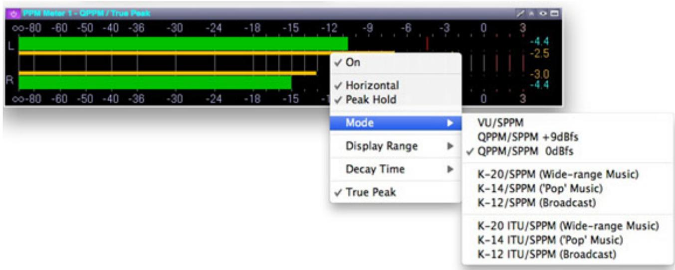
Jedes Meter hat eine eigene Menüleiste: links einen An/Aus-Schalter, auf der rechten Seite die Icons für Routing, Show/Hide, Visible, Maximize (Darstellung auf dem ganzen Bildschirm)
