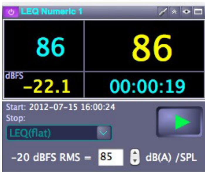
Das LEQ Meter (long-term equivalent continuous sound level) ist ein numerisches Meter, das Langzeitmessungen der Lautheit bezogen auf einen absoluten dB-Wert ermöglicht. Der Bezugswert ist in 1-dB-Schritten einstellbar. Es sind verschiedene Messverfahren mit ihrer unterschiedlichen Frequenzgewichtung auswählbar. Auch hier wird wieder Beginn und Ende der Messung mit Datum und Uhrzeit angezeigt.
