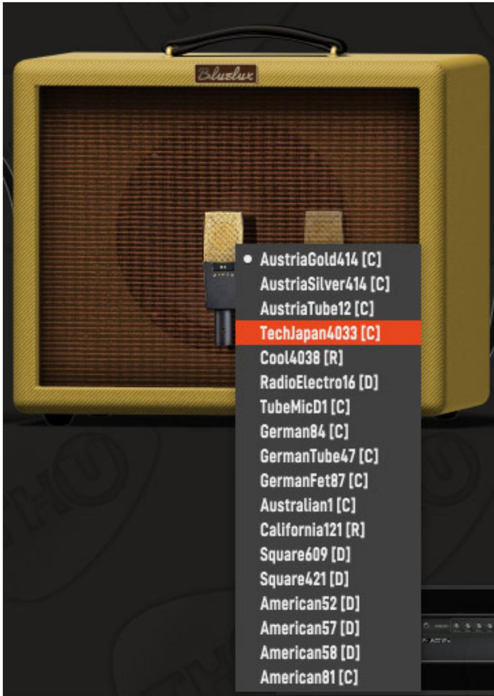
Bei den Lautsprechern/Cabinets gibt es auch eine Individualisierungsmöglichkeiten. So kann man den Mikrofontyp (s. Abb. oben) der zur virtuellen Abnahme genutzt werden soll aus einer Liste wählen und auch die Anordnung der Mikrofone im Raum mit der Maus verändern. Es kommt auch eine Raumsimulation zum Einsatz, so dass sich der Klang zum Beispiel mit ändern der Distanz zum Cabinet entsprechend anpasst.
