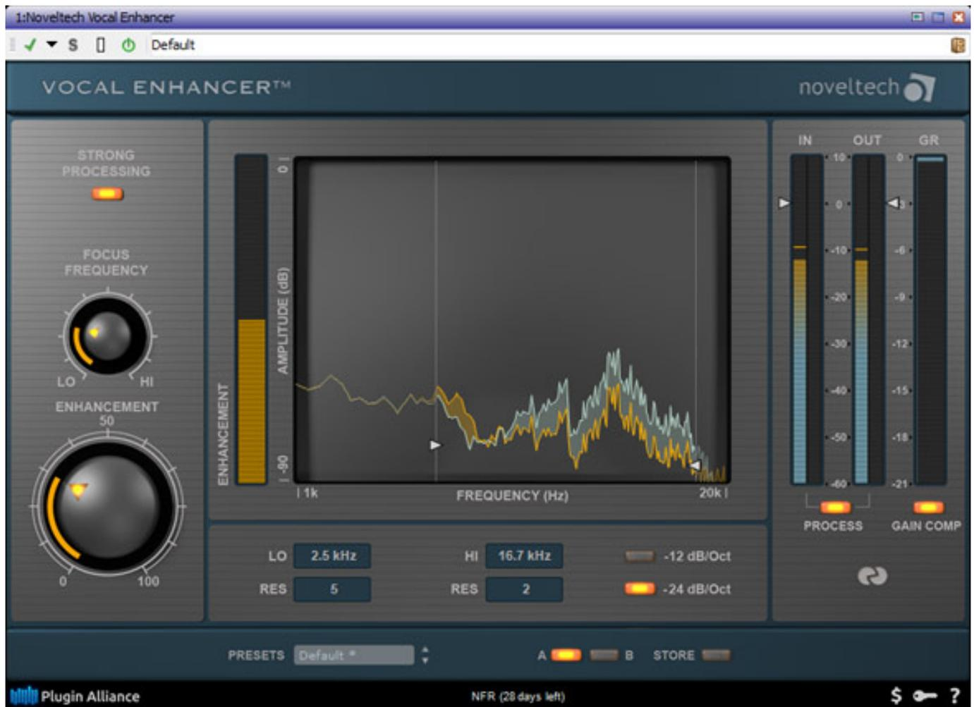
Fangen wir mal mit dem Bargraf-Bereich an. Hier wird der Ein- und Ausgangspegel für beide Kanäle sowie eine ggf. vorhandene Gain-Reduction angezeigt. Bei aktiviertem GAIN COMP werden Pegelerhöhungen gegenüber dem ursprünglichen Eingangssignal automatisch ausgeglichen - sprich reduziert. Über den virtuellen Taster PROCESS lässt sich die Prozessorbearbeitung aktivieren, bzw. deaktivieren.
