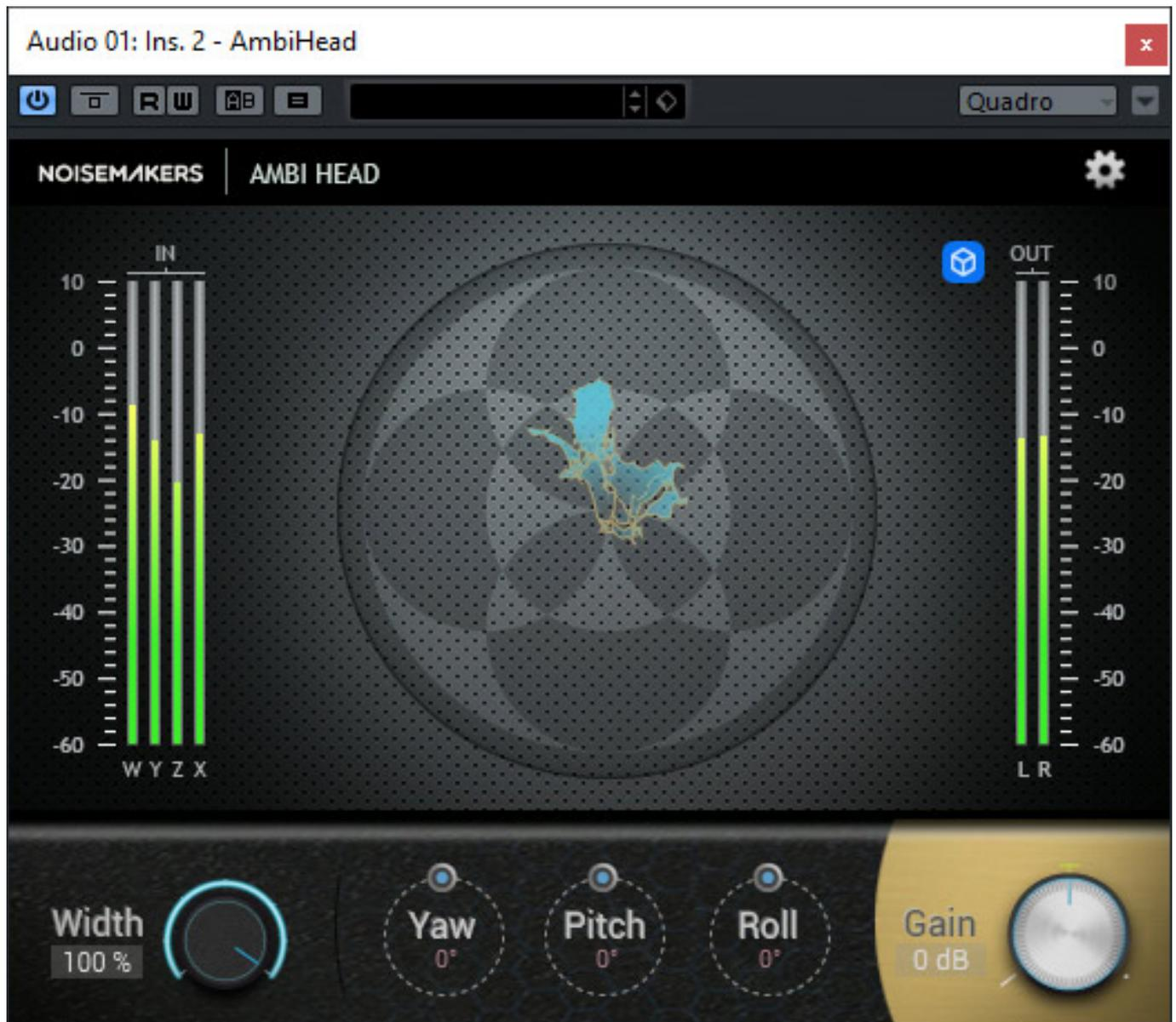
Einstellen lässt sich einmal Stärke der Richtungswahrnehmung (Width) und den Pegel (Gain) sowie die Ausrichtung des Kopfes (Yaw: Drehung, Pitch; Elevations-Neigung, Roll: Horizontal-Neigung) im 3D-Raum.
