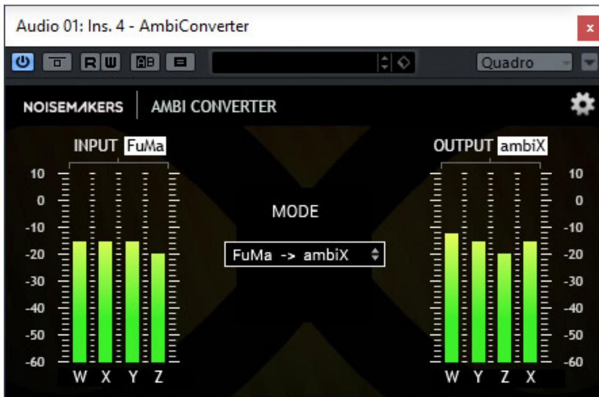
Der Ambi Converter ist das einfachste Plug-In und zudem auch kostenfrei von der Noise Makers Web-Seite herunter zu laden. Er ist in der Lage zwischen den B-Formaten FuMa und ambiX in beide Richtungen zu konvertieren. Der Konvertierungsmodus wird in der Mitte des Plug-Ins angewählt, wenn man zuvor auf das Zahnradsymbol geklickt hat (Einstellungen anwählen). Die Pegel werden auf
