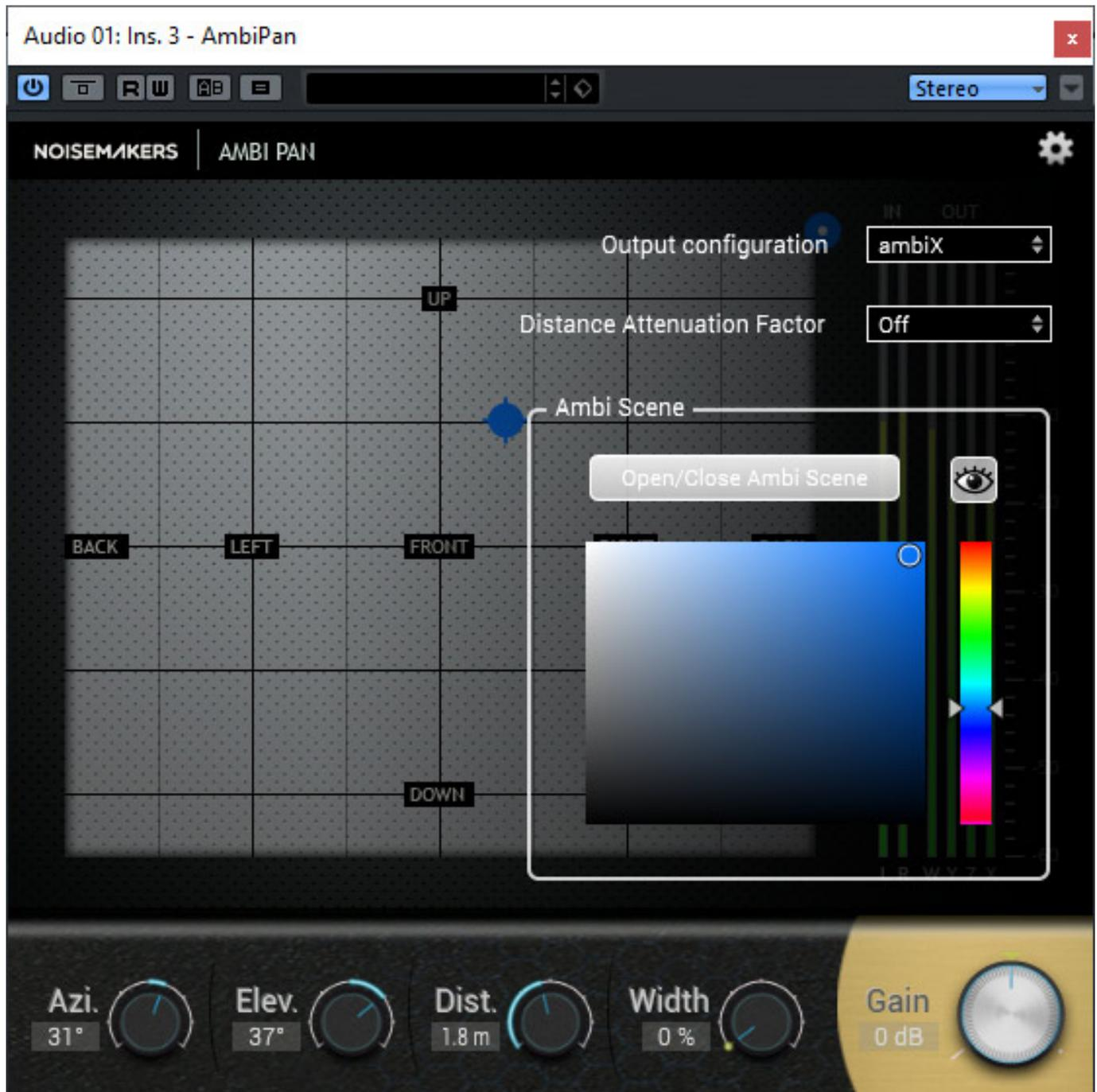
In der Konfiguration kann das Ausgang-B-Format (FuMa oder ambiX), ein Entfernungsabschwächungsfaktor und ein Ambi-Scene-Darstellung eingestellt und aktiviert werden. Mit aktivierter Ambi Scene (ab Version 1.1) wird eine transparente
