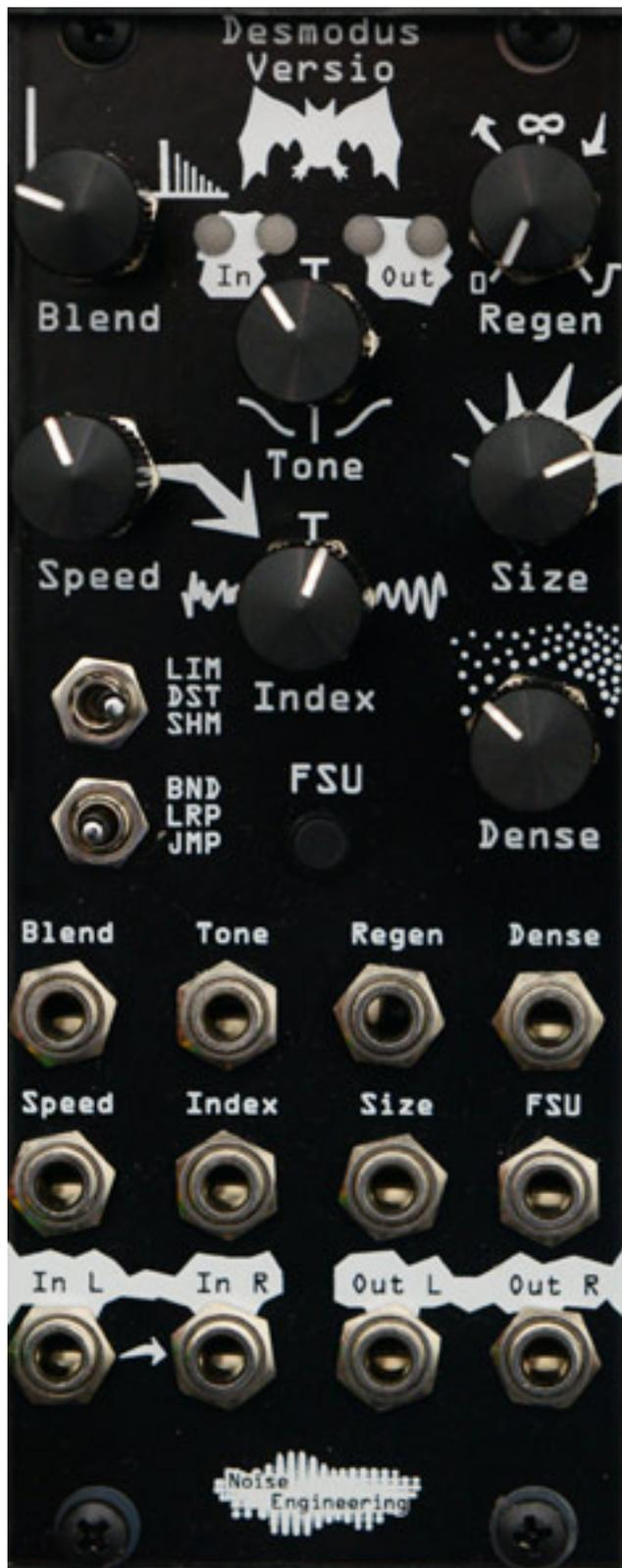
Desmodus Versio verfügt über ein Stereo-Ein- und Ausgang, wobei sich der Eingang auch monophon beschalten lässt. Alle Parameter die der Anwender einstellen kann, lassen sich auch mit einer Steuerspannung kontrollieren. An dieser Stelle möchten wir einmal auf die einzelnen Parameter eingehen, denn die geben einen guten
