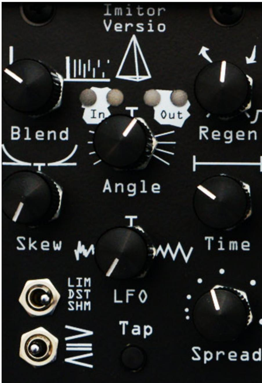
Der Schalter LIM/DST/SHM hat im Prinzip die gleiche Funktion wie beim Hall-Modul. Besonders interessant ist der Schalter darunter, mit dem man den Delay-Verlauf einstellen kann. Klassischerweise über die Zeit mit abnehmendem Pegel, das heißt, dass Signal wird immer leiser aber auch gleichbleibendem Pegel oder ansteigendem
