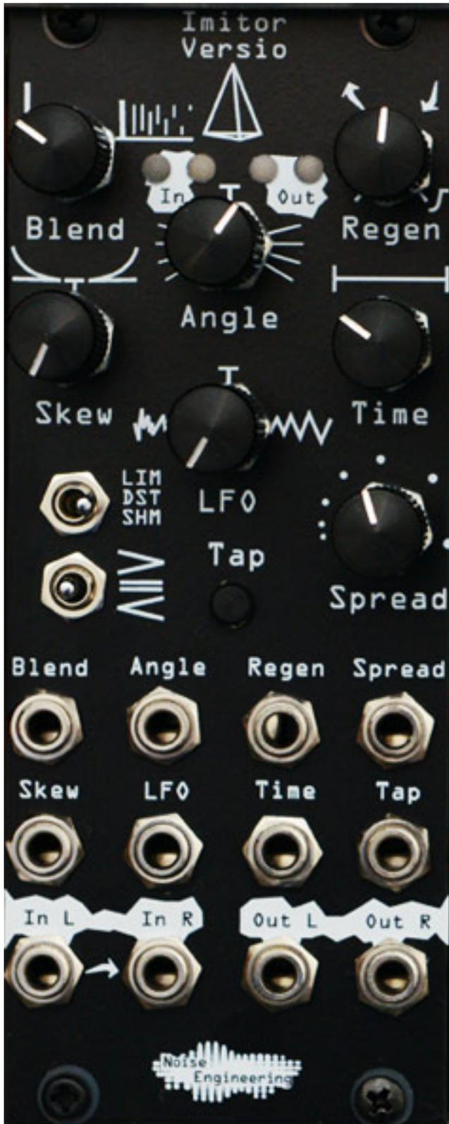
Mit "Time" wird die Zeit eingestellt bis das Echo beginnt und mit "Spread" die Abstandszeit zwischen den einzelnen Echos. "Skew" gestattet die Einstellung der Abstände der Echos relativ zueinander. In Mittelstellung ist der Abstand der einzelnen Echos gleich. Mit "Angle" lassen sich Stereoeffekte erzeugen in dem die
