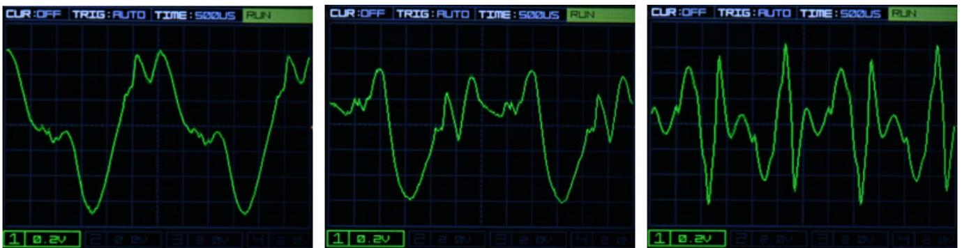
Kommen wir zunächst zum Regler FOLD mit dem man die Stärke des Wavefolders einstellen kann (siehe Abb. oben von Reglerstellung leicht über mittel bis auf Maximum). Das Verhalten ist typisch wie man das auch von Wavefoldern in einem Synthesizer her kennt.
