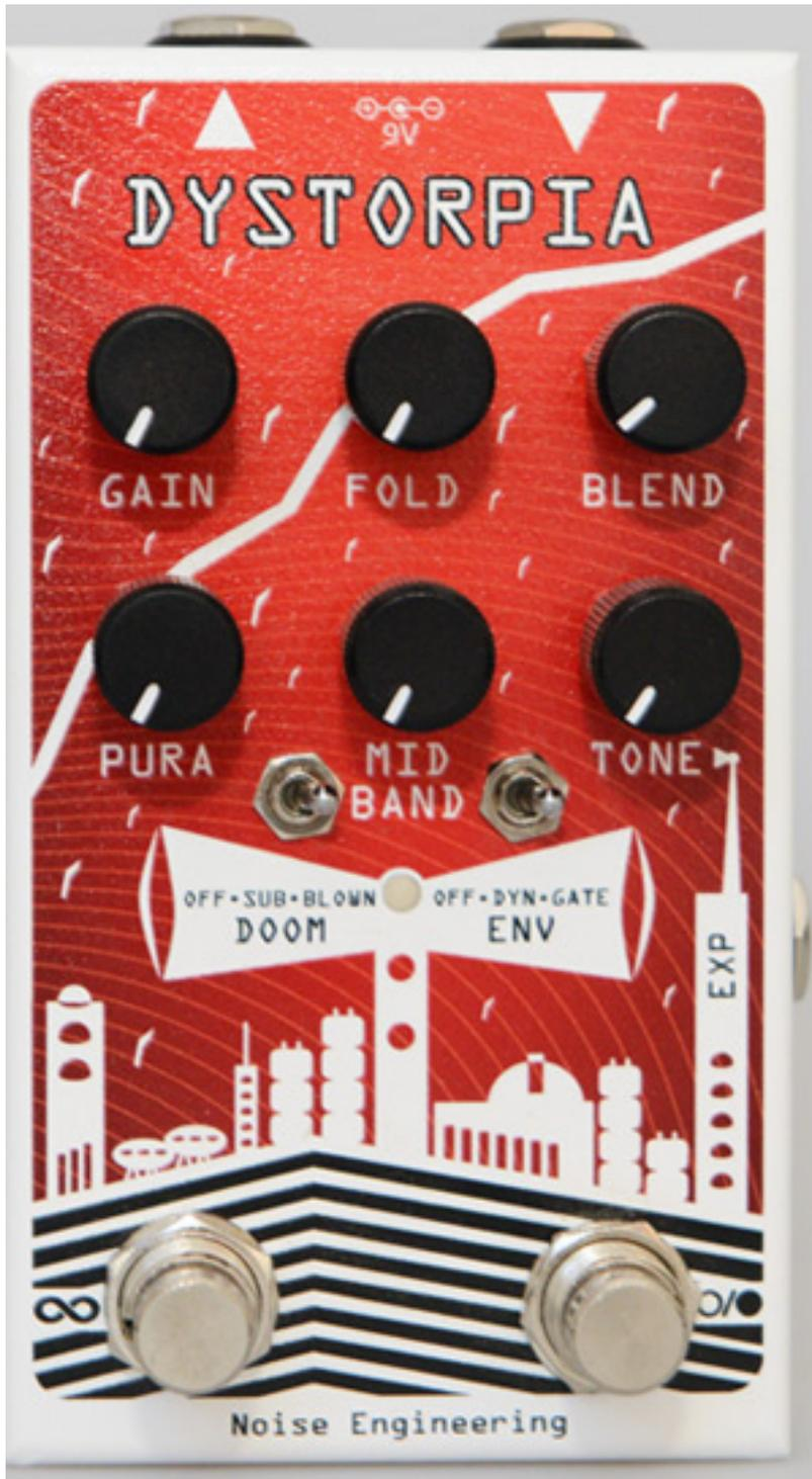
Weiter befinden sich die Regler für die zuvor beschriebenen Regler für die Effekttiefe der Parameter FOLD, BLEND und PURA, sowie die Filterparameter MID BAND und TONE auf der Frontplatte. Wenn man ein Expression-Pedal angeschlossen hat, muss der Regler TONE entsprechend heruntergeregelt werden, damit man genügend Regelbereich mit dem Expression-Pedal hat.
