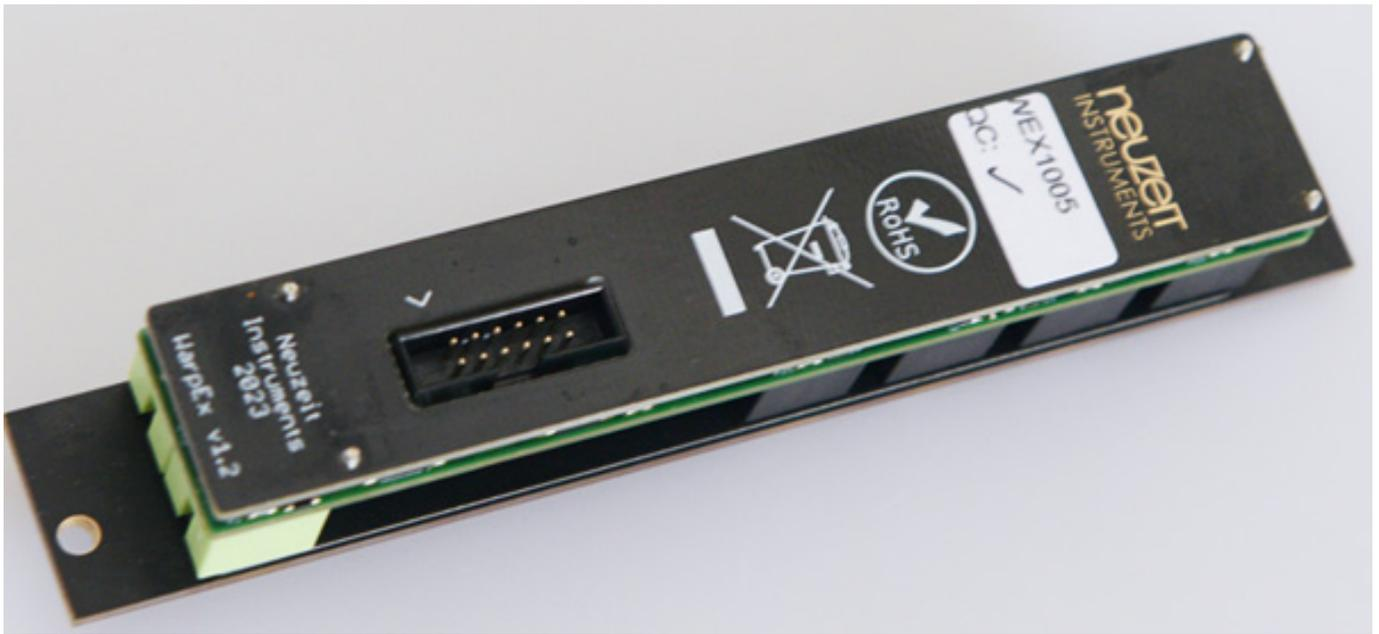
Der Betriebsstrom beträgt für das Oszillator-Modul bei +12 V ca. 170 mA in der Spitze und für -12 V ca. 22 mA und mit dem Expander erhöht sich der Strom auf 211 mA (+12 V), bzw. 50 mA (-12 V).
