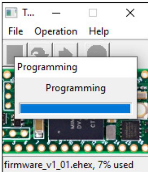
Danach muss man am Teensy-Modul mit einem Plastikstück (die kontaktlose Seite des mitgelieferten SD-Karten-Adapters eignet sich dafür hervorragend) einen kleinen Taster drücken und der Update-Vorgang startet dann.
