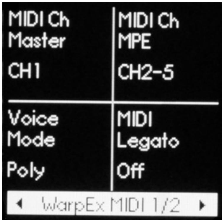
In den MIDI-Einstellungen kann der Master-MIDI-Kanal sowie die vier MIDI-Kanäle für den MPE-Betrieb ausgewählt werden. Man hat hier auch Zugriff auf den Keyboard-Modus bei angeschlossenem Expander und im Mono-Modus lässt sich auch ein Legato aktivieren.
