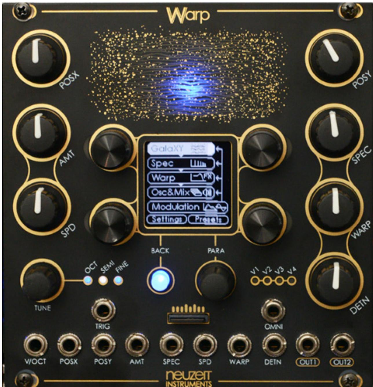
Zwei weitere Drehgeber links und drei rechts dienen der Einstellung Modulationsstärke (AMT) und globalen Geschwindigkeit (SPD) sowie die Klangbeeinflussung über Spectral Shape Filter (SPEC), Warp-Wavetable-Effekte
