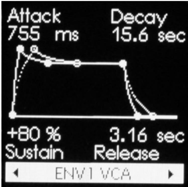
Die Modulationsmöglichkeiten beim Warp sind vielseitig. Neben einem ADSR-Hüllkurvengenerator der fest den Volume-Verlauf (s. Abb. oben) bestimmt gibt es noch einen zweiten für beliebige Verwendung. Es lässt sich auch bestimmen, welchen Einfluss der SPD-Drehgeber und der CV-SPD-Input auf die Hüllkurvenzeiten hat.
