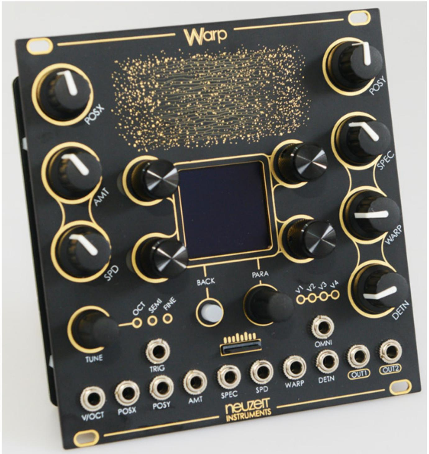
Das Warp-Eurorack-Modul hat eine Breite von 24 TE und einer Einbautiefe von 31 Millimeter. Die Frontplatte besteht aus einer kupferbeschichteten FR4-Glasfaserplatte, wobei das Kupfer Weichgold-beschichtet ist. In der Mitte ist ein monochromes OLED-Display (128 x 128 Pixel) mit einer Ausgabefläche von 37 x 37 mm eingelassen.
