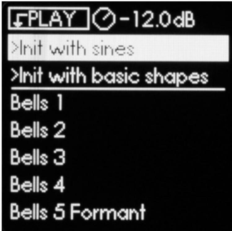
Ab Werk sind einige GalaXY-Files verfügbar (s. Abb. oben) sowie auch zwei Möglichkeiten mit Standardwellenformen zu arbeiten, entweder Sinuswellenform oder ein Set von Sinus über Sägezahn zu Puls und Dreieck-ähnlichen Wellenformen. Darüber hinaus lassen sich auch die GalaXY-Files die in den Presets benutzt werden einzeln laden. Über einen Druck auf den oberen linken Drehgeber kann man die Audioausgabe Wavetables zu Kontrollzwecken starten.
