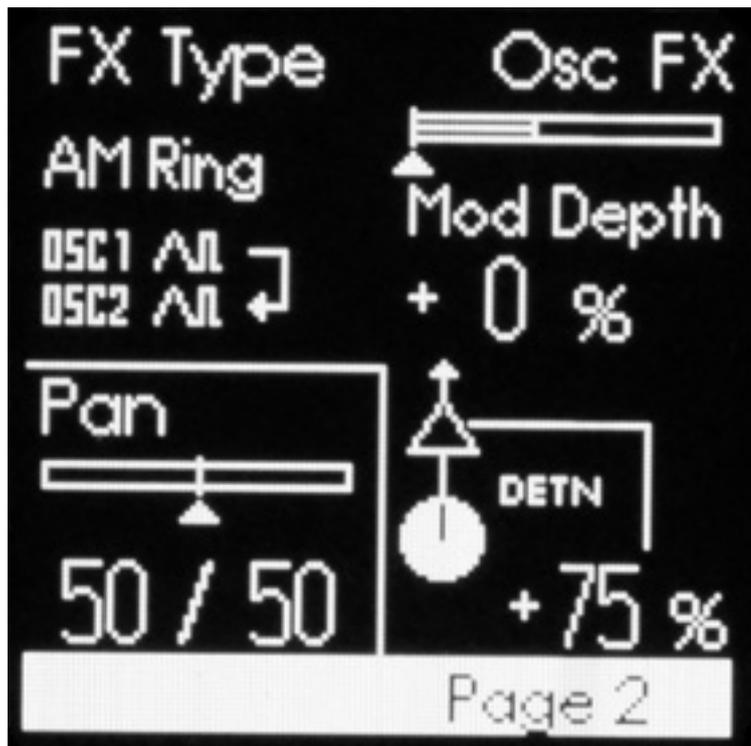
Auch bestimmte Oszillator-Effekte wie Linear Detune, Oszillator-Sync, Ring-Modulation, FM-Modulation und Phase Distortion lassen sich in dieser Sektion einstellen. Dazu kann der Oszillator 2 auch als Rauschgenerator dienen, dessen weißes Rauschen sich durch Hoch-/Tiefpassfilter färben lassen.
