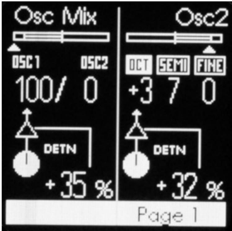
Nun zu dem Menü "Osc & Mix". Hier lassen sich die Pegel der Voice, die Start-GalaXY-Position und Voice-Tonhöhe einstellen und bei Anwahl des Mono-Modes auch pro Stimme. Auf den folgenden Seiten kann dann unter anderem das Mischverhältnis der beiden Oszillatoren, der Frequenzabstand der Oszillatoren und die Wirkung der CV-Eingänge verändert werden.
