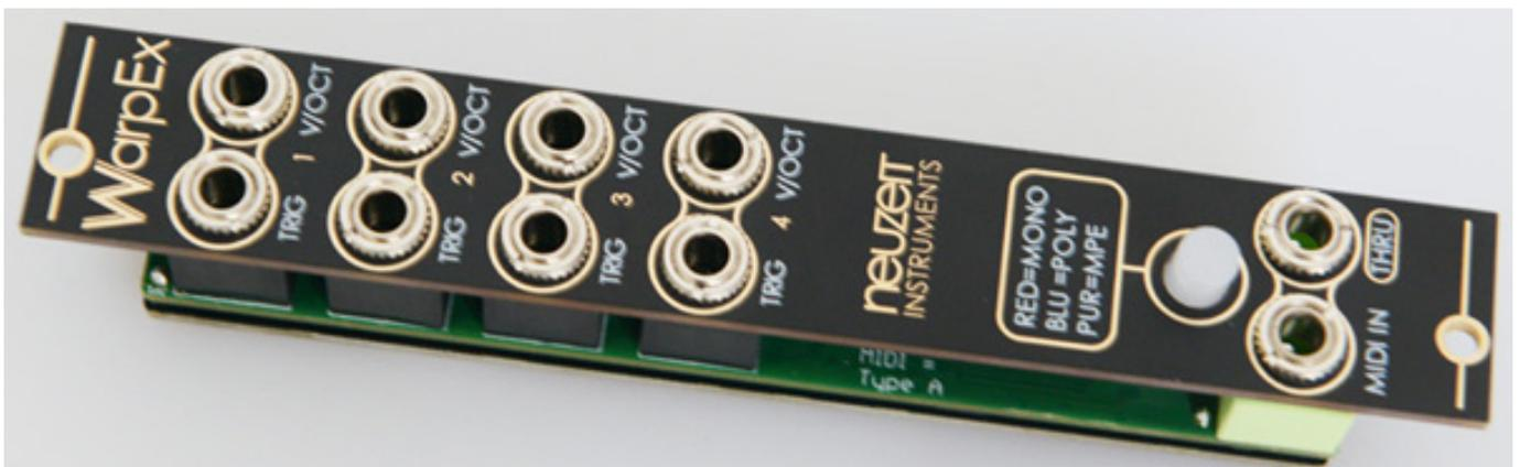
Der WarpEx hat eine Breite von 4 TE. Aufgrund der Anordnung der Anschlussbuchse am Hauptmodul ist er für den Einbau links neben dem Hauptmodul gedacht. Die Spannungsversorgung des Expanders erfolgt über die Verbindung zum Oszillator-Modul.
