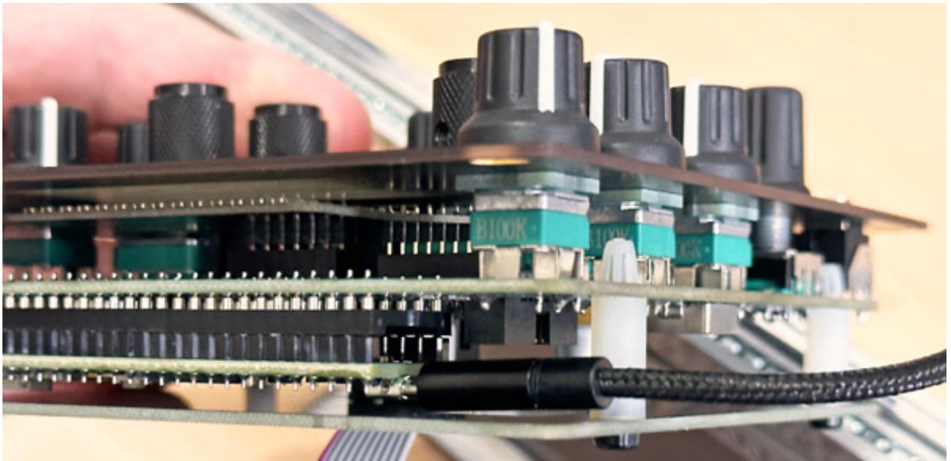
Ein Firmware-Update erfolgt über eine Updater-Software, die es für Windows, macOS und auch Linux/Ubuntu gibt. Dazu wird der Rechner via Micro-USB-Kabel (Kabel gehört zum Lieferumfang) an das Teensy-Modul (s. Abb. oben) angeschlossen. Wichtig ist, dass während des Update-Vorgangs das Modul über einen Eurorack-Bus mit Strom versorgt wird. USB kann zur Spannungsversorgung nicht genutzt werden.
