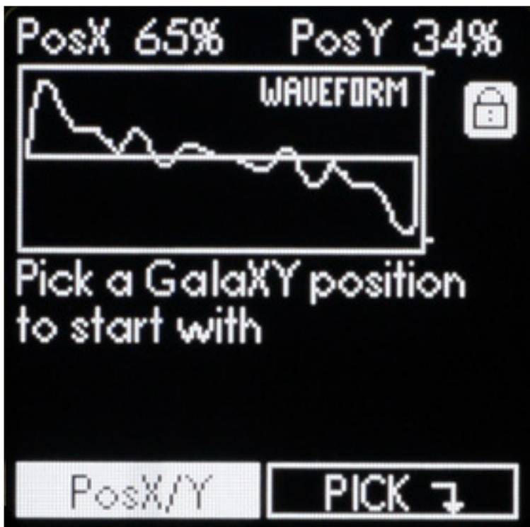
Kommen wir nun zum Editor der GalaXY-Wavetables. Über den Menüpunkt "Additive (Pick XY)" wird der Editor aufgerufen. Als erstes muss man eine Startposition (X/Y) über die beiden oberen Regler wählen und dann über Drücken des Haupt-Encoders festlegen.
