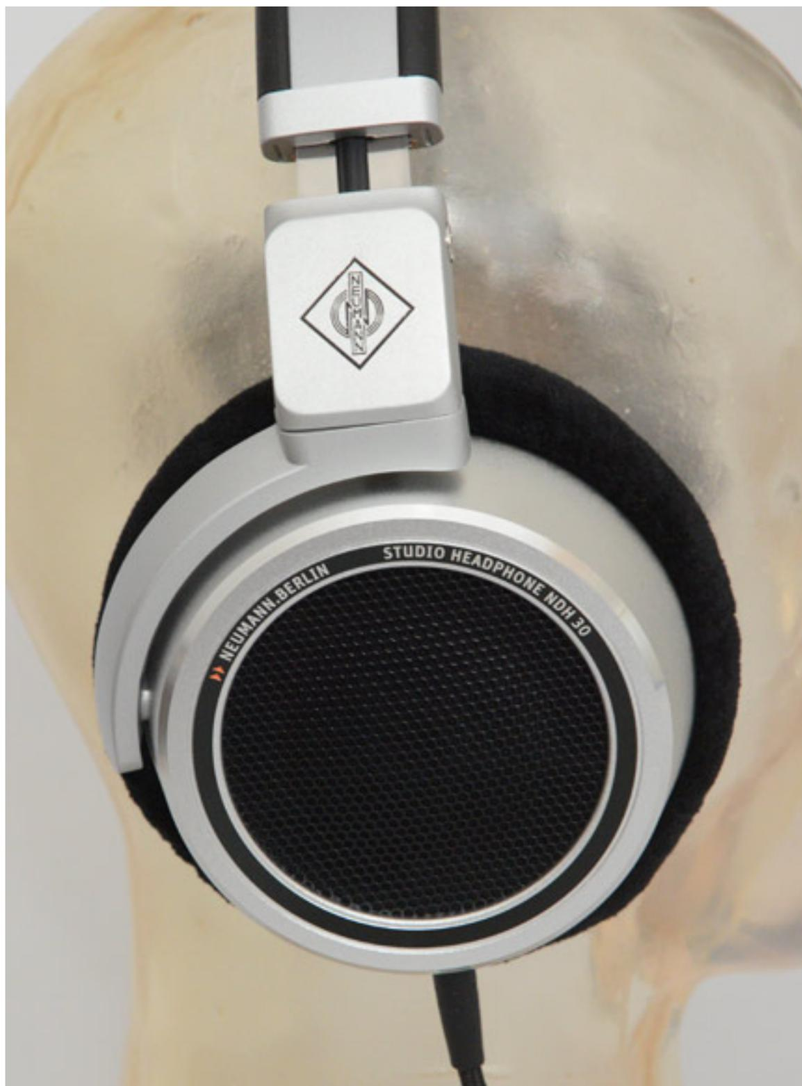
Mechanisch gleichen sich da die beiden Hörer schon mehr. So sind Kopfhörerbügel und Kopfhörerschalen identisch, bis auf den Punkt das eine gelochte Abdeckung der Muscheln wegen der akustisch offenen Bauweise verarbeitet wird.
