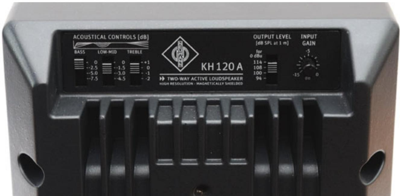
Der Input-Gain-Regler sowie die vierstufigen Schiebeschalter für den Output-Level sowie für die frequenzmäßige Ortsanpassung befinden sich auf dem oberen Teil der Rückseite. Input Gain kann mittels Potentiometer stufenlos zwischen 0 und 15 dB abgesenkt werden. Der Output Level ist mittels Schalter auf 114, 108, 100 und 94 dB SPL bei einem Meter Entfernung und 0 dBu (0,775 V) Eingangssignal einstellbar.
