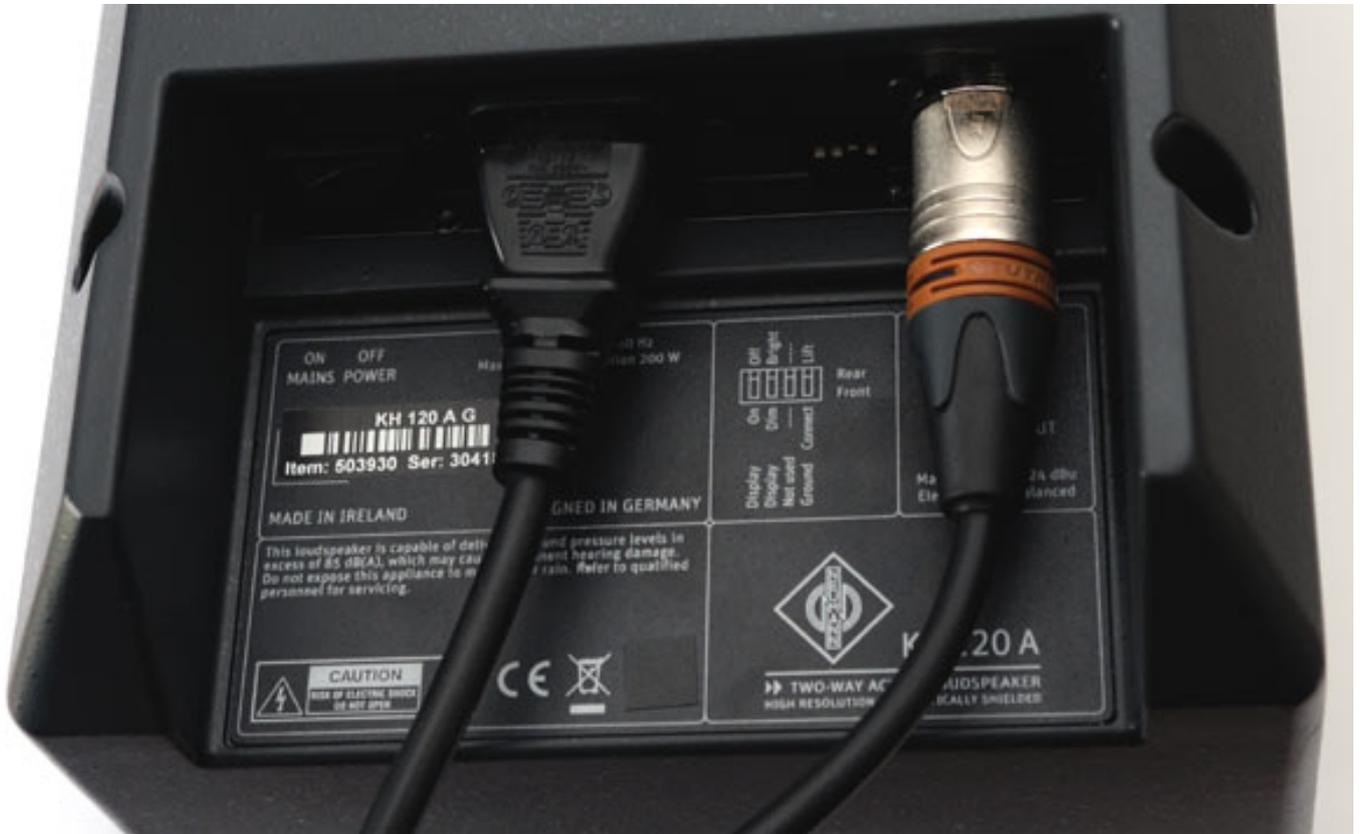
Die abgewinkelt-versenkte Anordnung der oben genannten Anschlüsse hat den Vorteil, dass die Box auch verkabelt keine größere Stellfläche benötigt, der Netzanschluss hätte aus Gründen der Betriebssicherheit jedoch mit einem Sicherungsbügel ausgestattet sein können. Die rückseitige Position des Netzschalters ist etwas unglücklich. Wer keinen zentralen Netzschalter hat, muss zum Ein- und Ausschalten die Position des Schalters erfühlen. Ein Netzschalter auf der Frontseite wäre etwas komfortabler.
