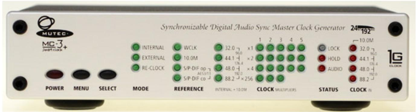
Wir möchten in diesem Test einmal ein interessantes Digital-Audio-Gerät vorstellen. Die MC-3+ Smart Clock des deutschen Herstellers Mutec vereint verschiedene Funktionen und zwar kann er als Master-Clock-Generator, Clock-Verteiler mit Signalaufbereitung und auch zum Re-Clocking von Digital-Audio-Signalen eingesetzt werden.
