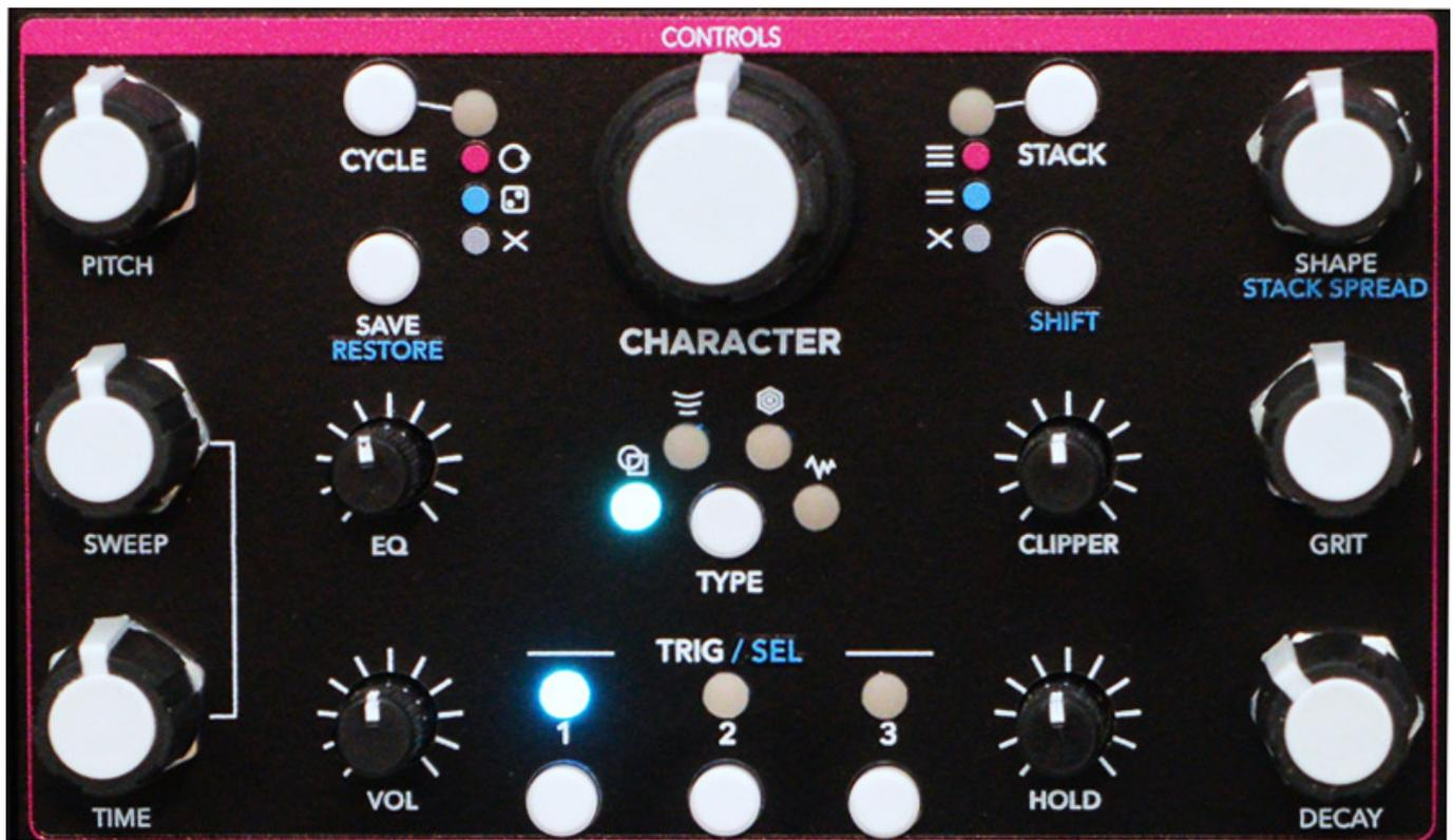
Die vier Synthese-Arten können mit dem Taster TYPE durch mehrfaches Drücken angewählt werden, wobei vier LED-Indikatoren die Anwahl anzeigen. Folgende Syntheseverfahren sind implementiert:
