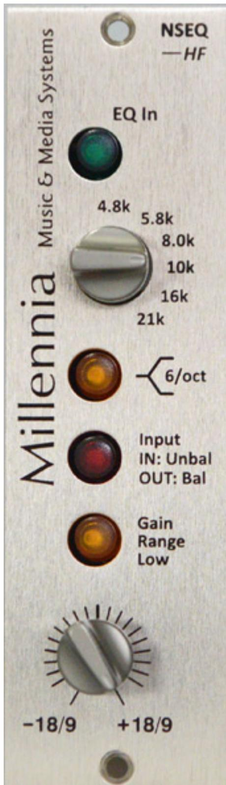
Der EQ In-Button schaltet den NSEQ-HF in den Signalweg. Der Bypass arbeitet „true hardwired“ mittels Relais. Der Drehschalter (vom Hightech-Hersteller Grayhill) wählt eine von sechs Frequenzen zwischen 4,8 kHz und 21 kHz. Der darunter befindliche Taster bestimmt die Arbeitsweise des EQs: Zur Auswahl stehen Glockenform mit
