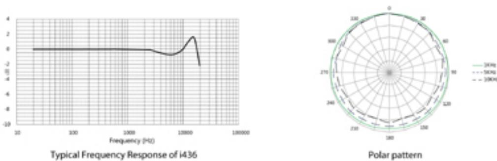
Das **i456** ist konzipiert für Sprachaufnahmen und bietet eine Empfindlichkeit von -50 dB (0 dB = 1 V/Pa @ 1 kHz) und einen Frequenzgang von 100 Hz bis 10 kHz bei einem Singalstörabstand von über 55 dB.
