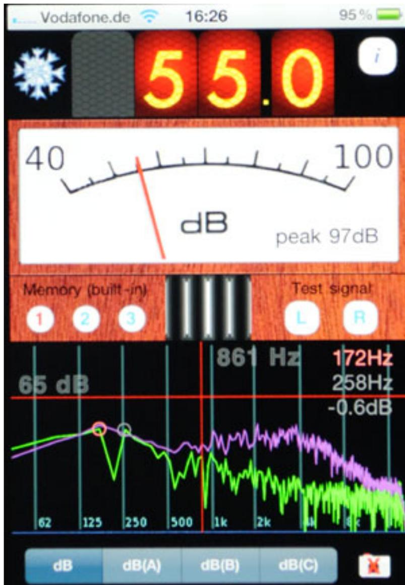
Die Messung kann mit A-, B-, C-Filter sowie auch unbewertet erfolgen. Der Messwert wird als Zeigerinstrument sowie mit Holdfunktion als dB-Wert mit einer Stelle hinter dem Komma angegeben. Die Messung lässt sich auch zu jeder Zeit mit einem virtuellen Button einfrieren und das Ergebnis auch als Bild sowie die Daten als Text via Email versenden.
