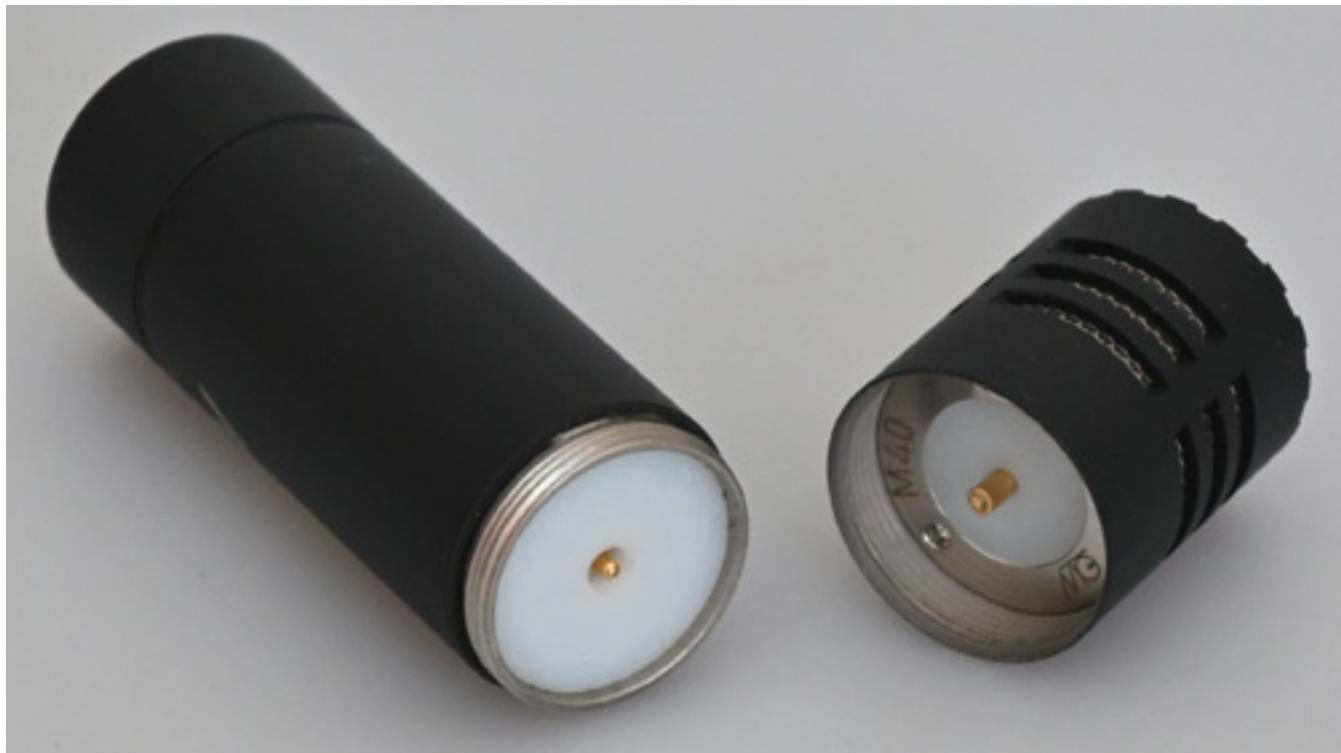
Es gibt zwei Vorverstärker, die in SMD-Technik aufgebaut sind und sich lediglich im Anschluss unterscheiden. So ist der MV 400 X mit einer XLR-3-M-Buchse ausgestattet und der MV 400 L mit einem LEMO-Anschluss. Die Technischen Daten sind daher bei beiden Modellen identisch. Nur die Länge des Verstärkers ist bei den Modellen unterschiedlich. So ist der MV 400 X ohne Stecker 75 mm lang und der MV
