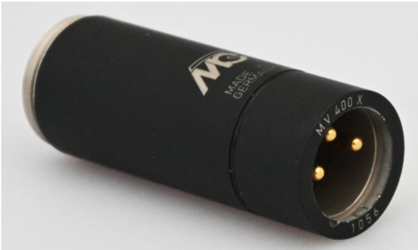
Gespeist werden die Verstärker mit 48-Volt-Phantomspeisung. Der Betriebsstrom beträgt ca. vier Milliampere. Die Impedanzwandlung erfolgt ohne Übertrager mit einer Transistorschaltung. Die Ausgangsimpedanz beträgt 100 Ohm. Microtech Gefell gibt den maximalen Ausgangspegel bei 0,5 % THD und 1 Kiloohm Last mit 17,2 dBu an.
