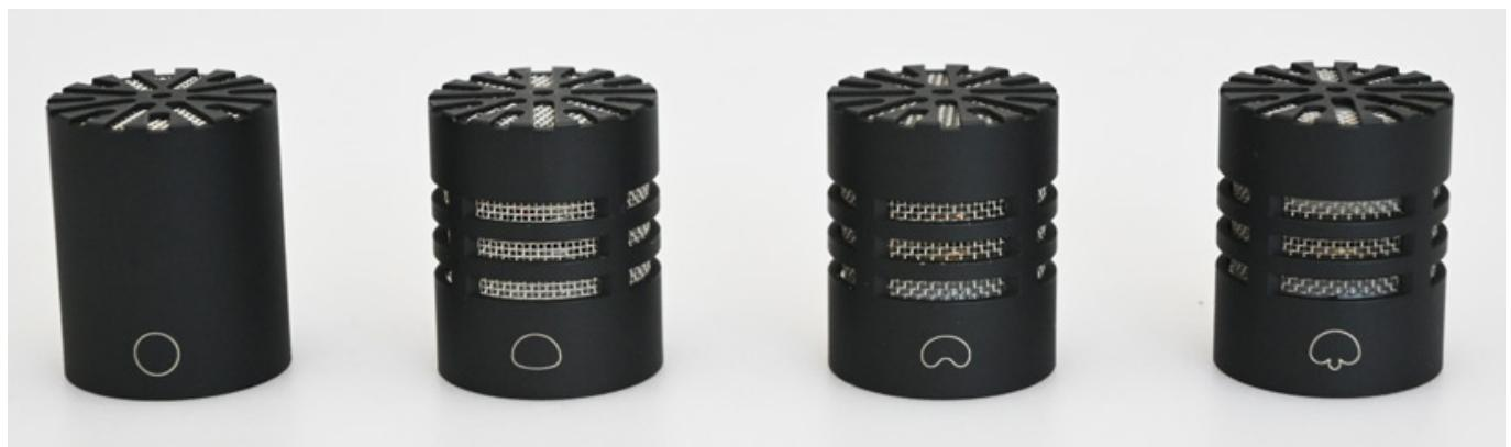
Alle Mikrofonkapseln sind Kondensatorkapseln mit einer PE-Membran und die gleiche Bauart wie die der Serie SMS 2000. Der Durchmesser des Metallgehäuses beträgt 21 mm und die Höhe bei allen Kapseln 26 mm. Damit sind die Kapseln der Generation 4 von Microtech Gefell ähnlich groß wie viele andere modularen Studio-Stäbchenmikrofone (Schoeps Colette 20 mm, Neumann KM-Serie 22 mm, sE8 23 mm). Die Bezeichnung Kleinmembranmikrofon ist aber eher als Understatement für diese Mikrofongruppe zu verstehen.
