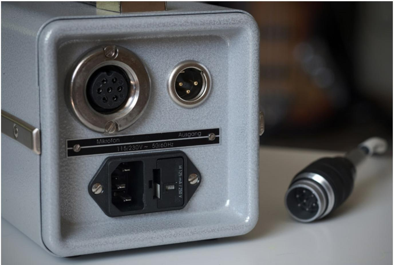
Die Verbindung zwischen CMV 563 und Stromversorgung geschieht selbstverständlich stilecht klassisch über einen siebenpoligen Tuchel-Stecker, wohingegen der Signalausgang aus dem Netzteil über eine Standard XLR-Lösung in symmetrischer Ausführung realisiert wurde.
