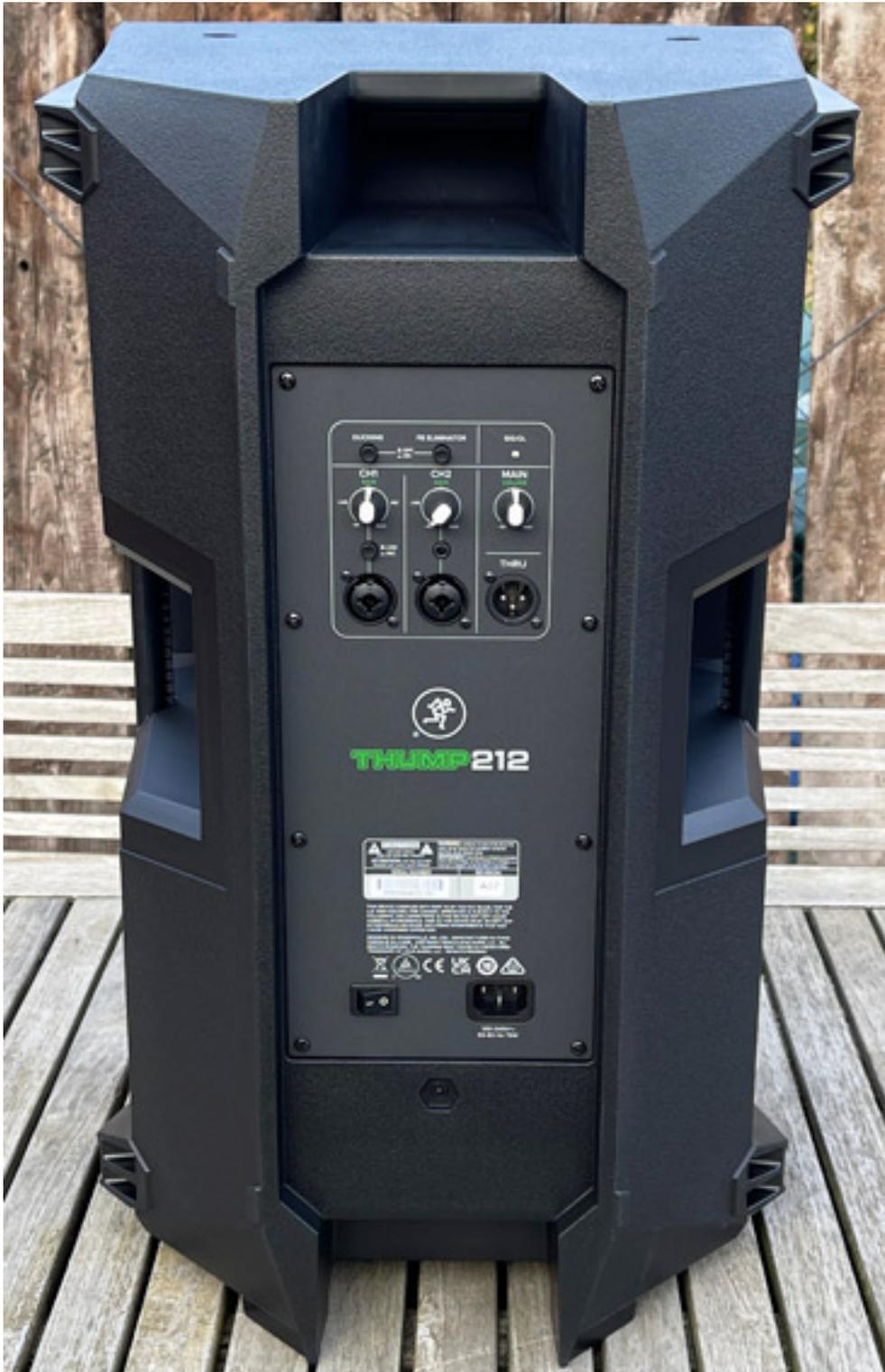
Das Aktivmodul ist versenkt angebracht und wird über Kaltgerätebuche nebst Netzschalter mit Strom versorgt. Das Modul verfügt über zwei Eingangskanäle und ein Master Out nebst (alle mit Gain bzw. Volume Potis) XLR-Link-Out-Buchse. Das bedeutet, der Anwender erhält einen rudimentären 2:1 Mixer, der sich bei Kleinstbeschallungen ohne zusätzliches Mischpult nutzen lässt. Die Eingänge 1 und 2 sind mit Combo-Buchsen (XLR + Klinke) bedacht, wobei Eingang 1 dank
