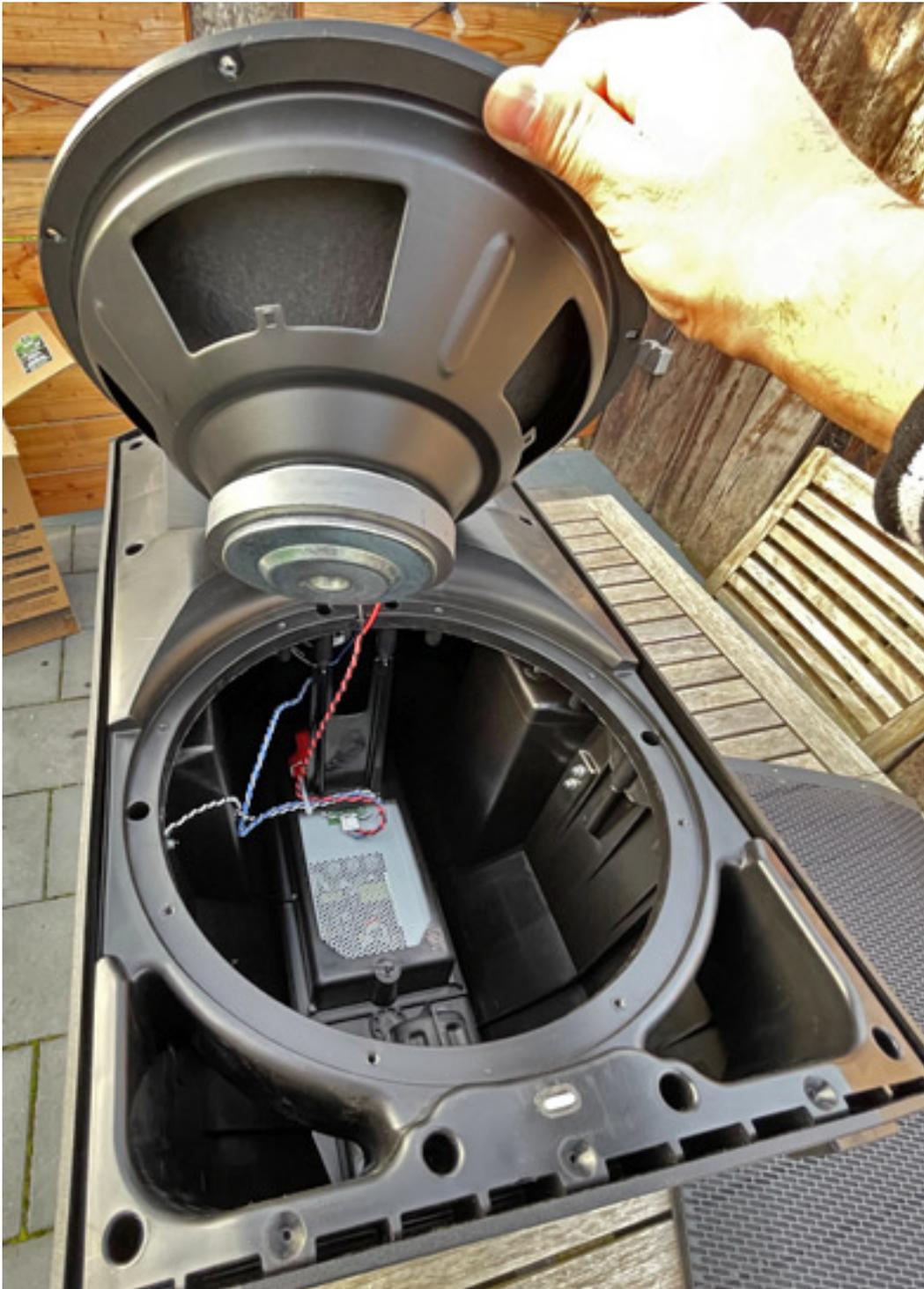
Vor dem Praxistest gönne ich mir noch einen Blick in das Innere der Box. Das vollflächige Lautsprechergitter ist schnell entfernt sowie der Tiefmitteltöner, der sich als einfacher Ferrit-Treiber mit Presskorb entpuppt. Kunststoffgehäuse brauchen stets eine gute Versteifung, um Gehäuseresonanzen zu minimieren. Daher sind in den Thump-Gehäusen gleich zwei massive Mittelstreben verbaut.
