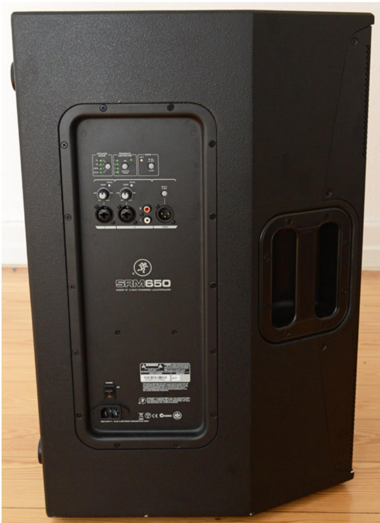
Im oberen Bereich des eingesetzten befinden sich Audiobuchsen und die Bedienelemente. Die Fullrange-Boxen SRM550 und SRM650 verfügen über zwei Eingänge und einen internen Mischer. Beide Kanäle verfügen über eine Kombibuchse mit XLR- (elektronisch symmetriert, 8 kOhm Eingangsimpedanz) und Stereoklinkeneingang (unsymmetrisch, Wide-Z, Eingangsimpedanz 1 MOhm). Durch die hohe Eingangsimpedanz beim Klinkenstecker-Eingang lassen sich dort auch direkt hochohmige Instrumente anschließen.
