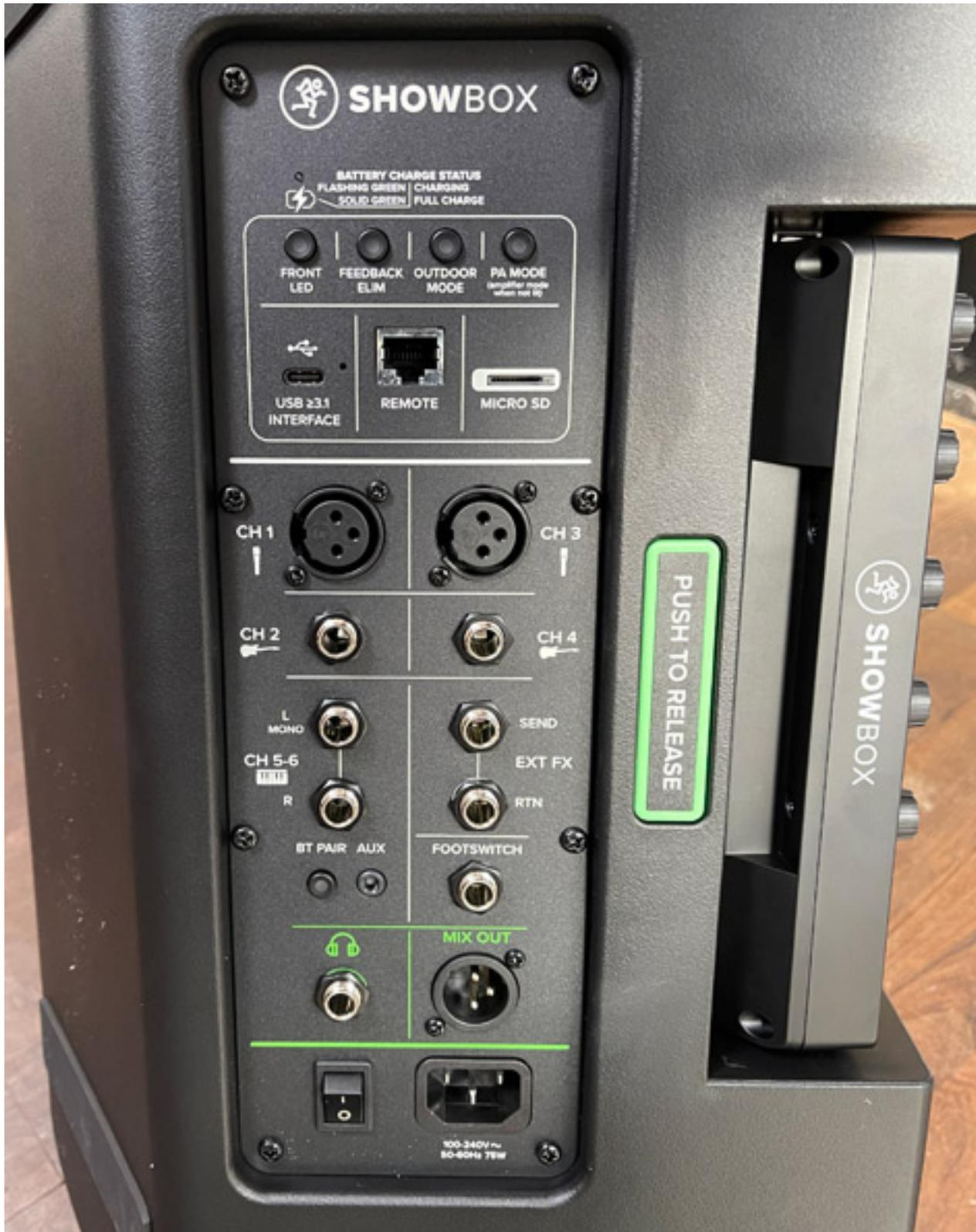
Das Aktivmodul zeigt auch durch die schiere Anzahl an Bedienelementen die Ambitionen der Mackie Showbox. Vier beleuchtete Funktionstaster machen den Anfang. „Front LED“ schaltet die beiden Status LEDs auf der Vorderseite ein oder aus. „Feedback Elimination“ aktiviert einen Feedback Unterdrückung Algorithmus
