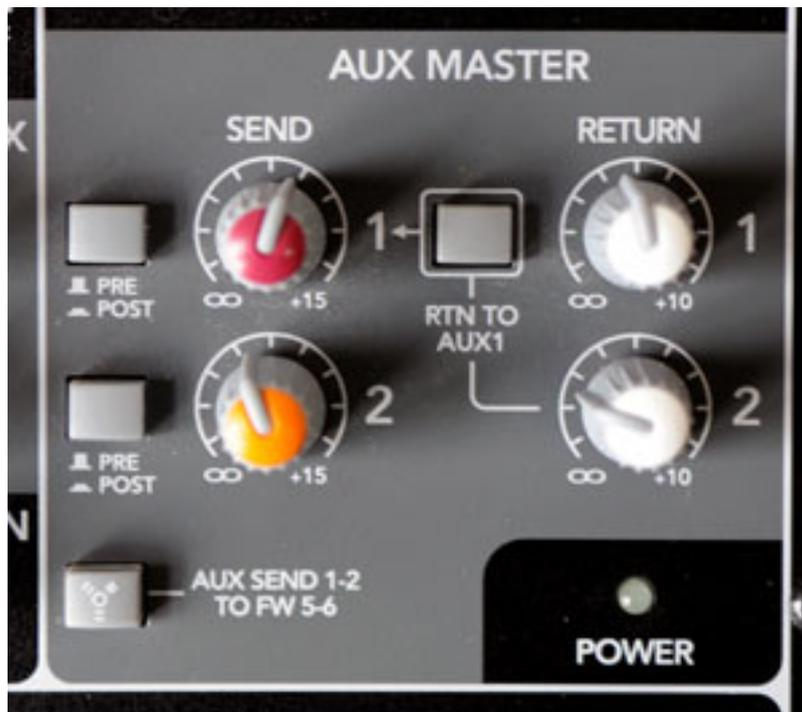
Werfen wir doch mal einen Blick auf die Aux-Master-Sektion. Es lässt sich der Summenpegel der Aux-Send-Wege sowie die Pegel der Returns über Potis regeln. Über Schalter kann man den Return 2 auf den Return 1 mit aufschalten. Auch die beiden Aux-Sends lassen sich Pre- oder Post-Fader abgreifen. Über ein weiteren Schalter kann der Anwender Aux-Send 1/2 auf Fire-Wire Kanal 5/6 aufrouten.
