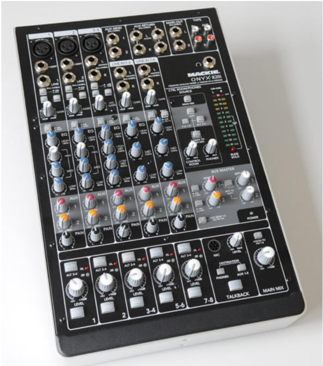
Der Mischer verfügt über zwei Mono-Aux-Send sowie zwei Stereo-Aux>Returns sowie über Talkback-Funktion und Control-Room-Sektion zum Wählen der Abhörquellen, aber dazu später im Detail mehr. Mit den Maßen 361 \* 96 \* 229 mm und einem Gewicht von 4,4 kg ist er sehr kompakt und auch für ein kleines Mobiles Setup einsetzbar, da er sich in jeder Reisetasche zusammen mit Laptop bequem unterbringen lässt.
