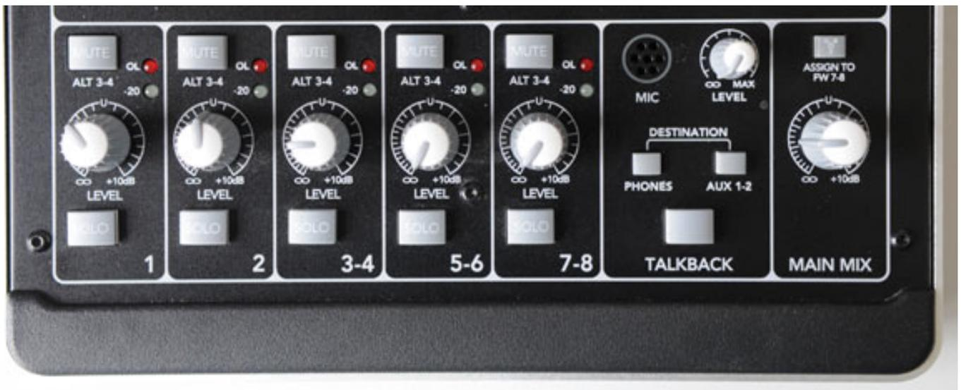
Jeder Kanalzug verfügt über "Fader"-Regler für Level, Solo- und Mute-Druckschalter und LED-Indikator für -20 dB Signal und Overload.
