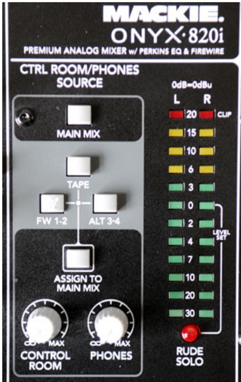
In der Control-Room-Sektion ist auch eine Bargrafanzeige für die Summe oder den auf Solo angewählten Kanalzug. Control-Room- und Kopfhörer-Pegel lassen sich getrennt über zwei Regler einstellen. Über vier Tasten lässt sich die Abhörquelle bestimmen, und zwar: Main Mix, FireWire Eingang 1/2, Tape oder Alt 3/4. Alt 3/4 ist dabei der Bus, auf den die Kanäle aufgeschaltet werden, die gemuted sind. Die letzten drei Quellen lassen sich über einen Schalter auch auf den Main-Mix-Bus routen.
