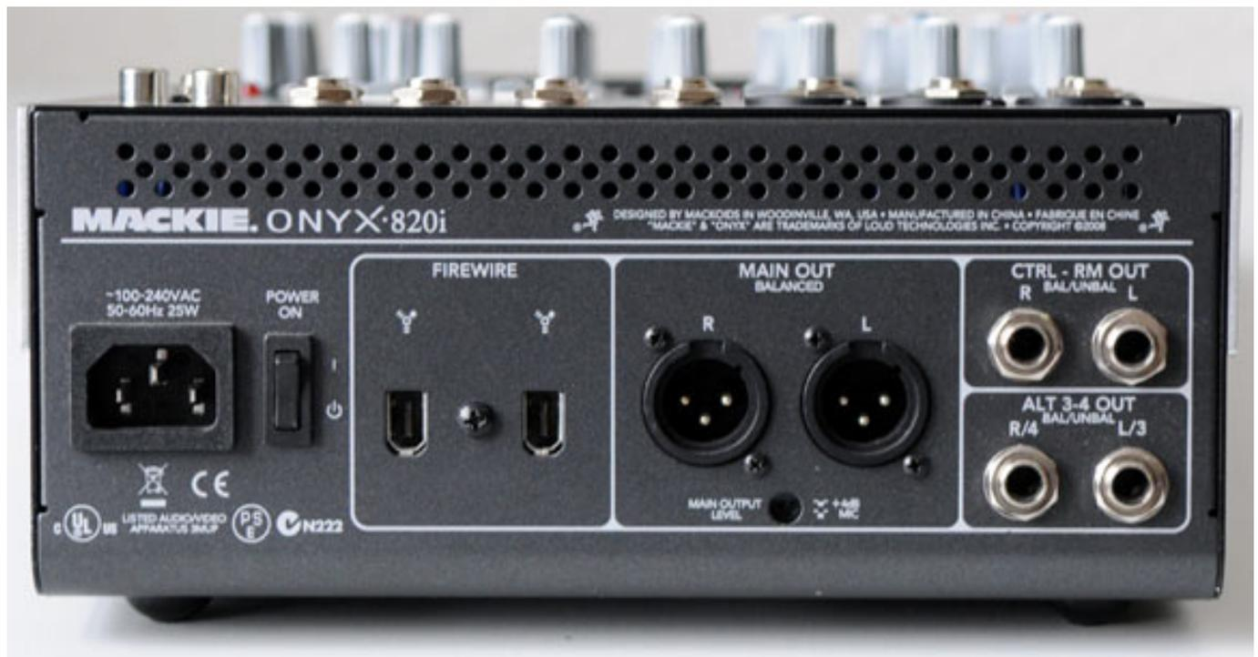
Auf der Geräterückseite befinden sich weitere Anschlüsse und zwar symmetrische Main Out (XLR-Buchsen, umschaltbarer Pegel) sowie symmetrische Control Room und Alt 3/4 Ausgänge (6,3-mm-Stereoklinken). Es stehen hier weiter zwei Fire-Wire-Buchsen zur Verfügung. Auch der Netzschalter ist auf der Geräterückseite untergebracht. Betrieben werden kann der Onyx 820i übrigens ohne Umschaltung von 100 bis 240 V und 50 bis 60 Hz Wechselstrom.
