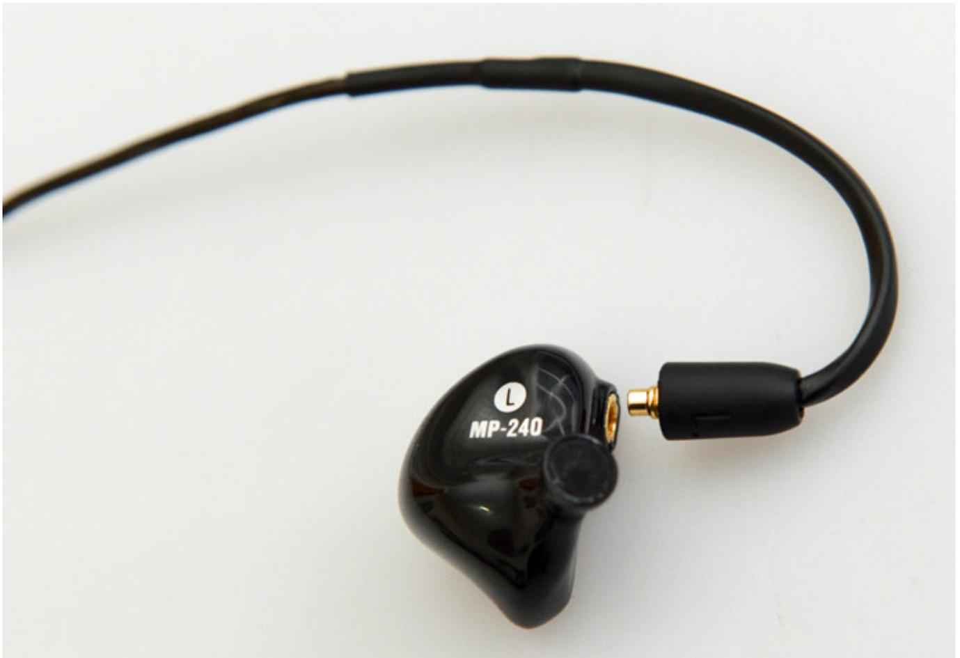
Mit einem passenden und korrekt sitzenden Höradapter erreicht man eine akustische Dämpfung des Außengeräusches von bis zu 40 dB, was wir in der Praxis absolut bestätigen konnten. Wer besonderen Wert auf eine hohe Außenschalldämpfung legt, sollte eher kleinere Adapter auswählen.
