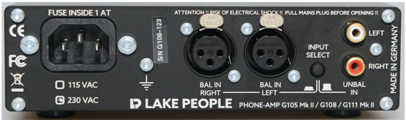
Es gibt auf der Geräterückseite jeweils einen symmetrischen (XLR) und einen unsymmetrischen (Cinch) Eingang. Über einen Druckschalter wird ausgewählt welcher Eingang aufgeschaltet werden soll. Die Eingangsimpedanz beträgt 10 kOhm.
