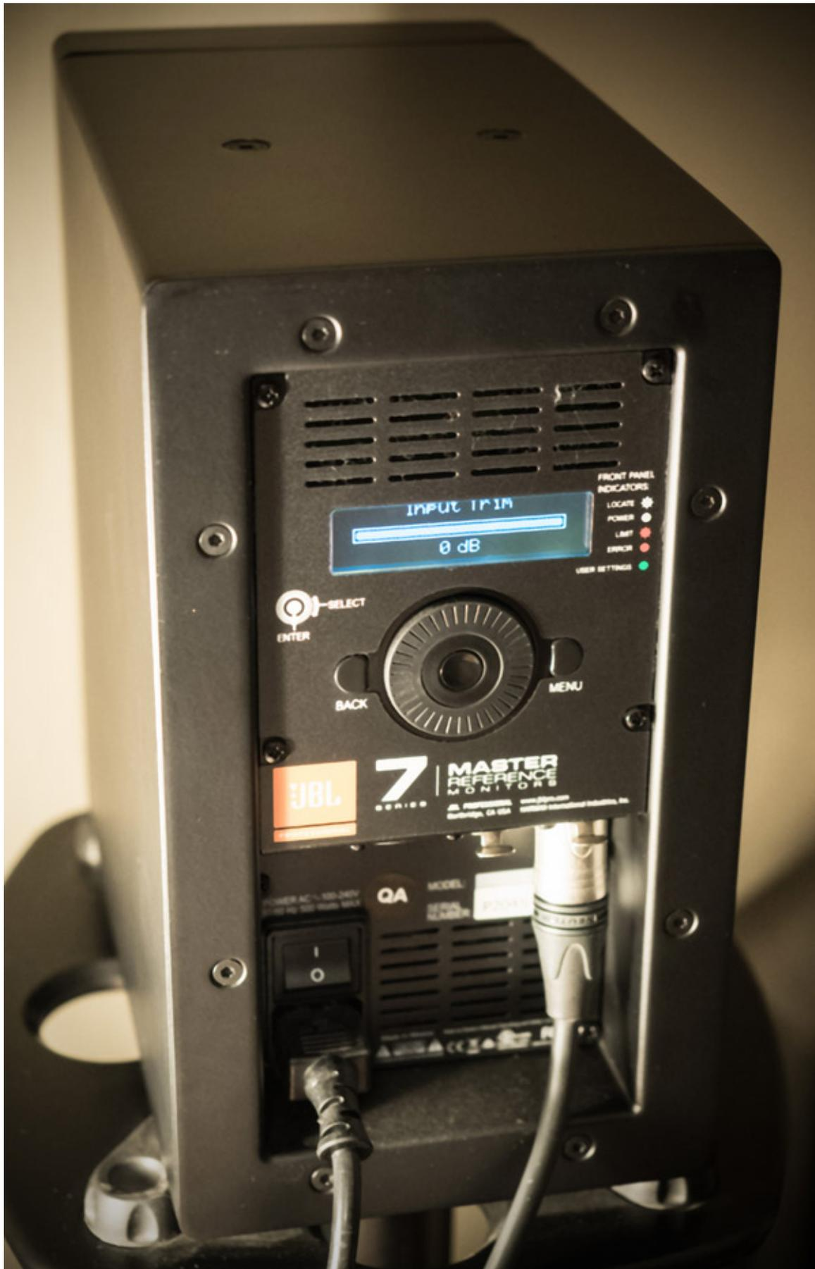
Hier befinden sich auch die obligatorischen physischen Eingänge in analoger XLR/Klinke-Kombi-Variante und als AES3-kompatibler Digital-Input (ebenfalls XLR) sowie einem XLR-Pass-Through-Ausgang. Nicht nur bei der internen Signalverarbeitung, sondern auch bei der Zuspiegelung digitaler Signale unterstützt die 705P zudem Abtastfrequenzen bis zu 192 kHz.
