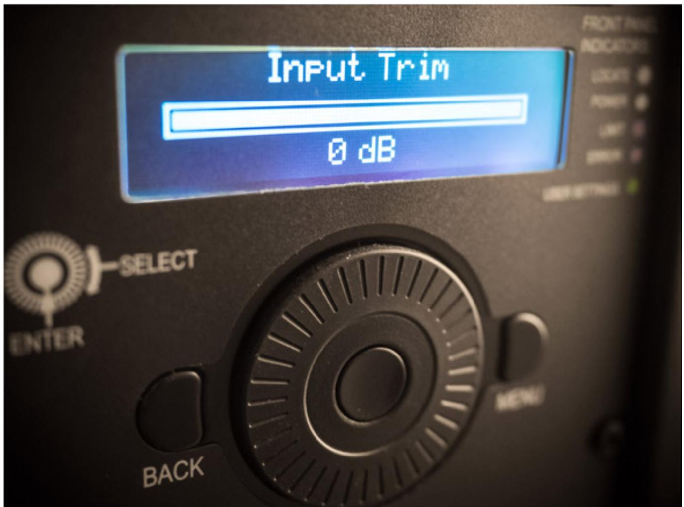
Befeuert wird das Setup von einer verhältnismäßig kräftig ausgelegten 2 x 250 Watt Bi-Amp-Einheit, welche in Class-D-Technologie realisiert wurde. Die ebenfalls integrierte displaygestützte sowie vielseitige DSP-Luxusausstattung, mit welcher sich sowohl Raum- als auch Laufzeitanpassungen via praktischem Alpha-Dial vornehmen lassen, ist über die Rückseite des Gehäuses erreichbar.
